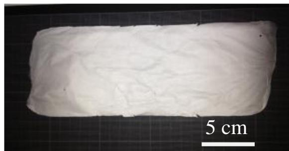
Figure I.11 : Membrane synthétisée par « electrospinning ».
