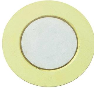
FIGURE 2.15 – Transducteur piézoélectrique utilisé pour les études expérimentales.  $\Phi_d = 20$  mm et  $e = 0,48$  mm.
