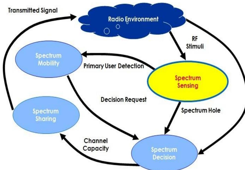
FIGURE 3.3 – Principaux modules de la Radio Cognitive [Aky1 09]
