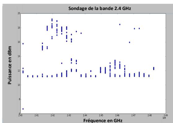
FIGURE 5.6 – Distribution de la puissance de transmission sur les canaux
