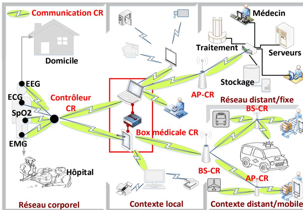
FIGURE 5.1 – Architecture de communication Radio Cognitive en e-santé
