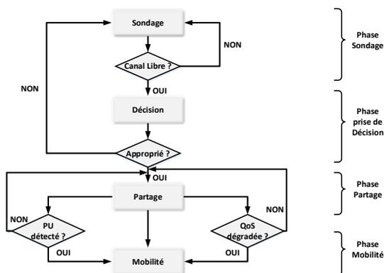
FIGURE 6.1 – Fonctionnement du nœud Radio Cognitive
