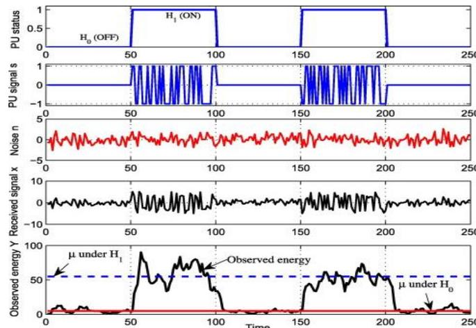
FIGURE 6.3 – Illustration de l'interprétation du signal reçu
