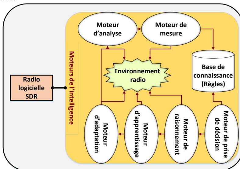
FIGURE 3.2 – Schéma de la Radio Cognitive
