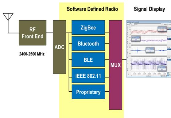
FIGURE 4.7 – Coexistence radio avec la technologie SDR [Chav 13]
