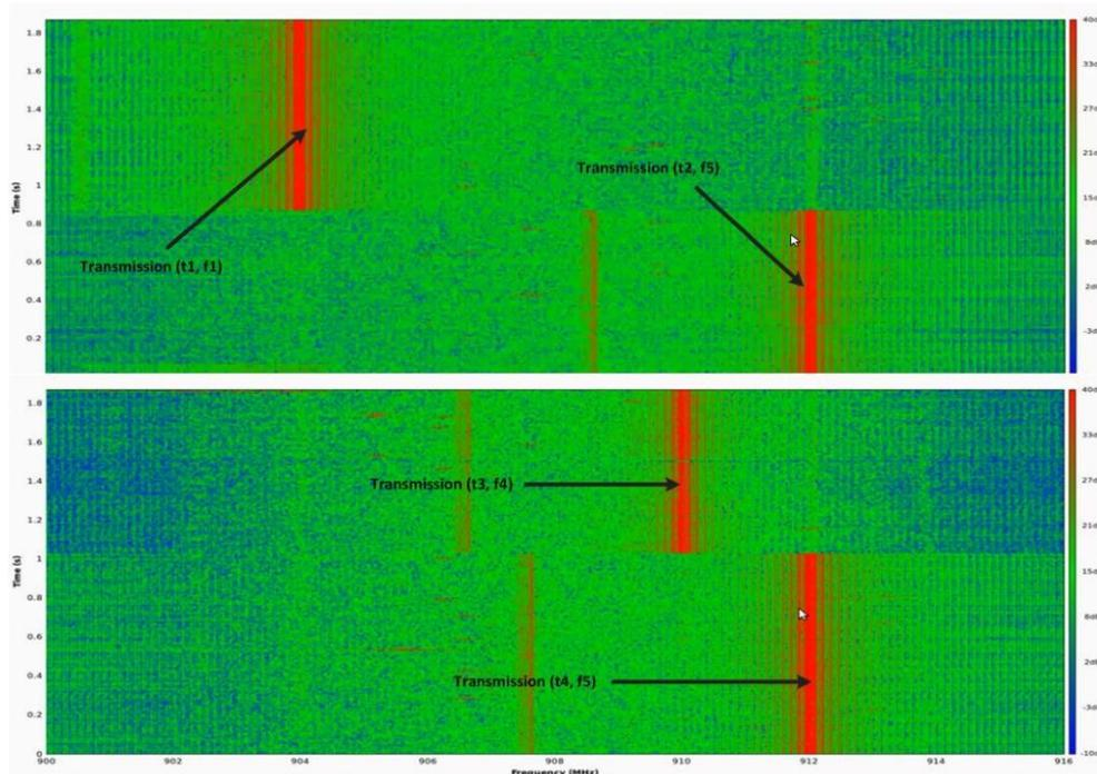
FIGURE 7.9 – Résultat d'expérimentation du saut de fréquence
