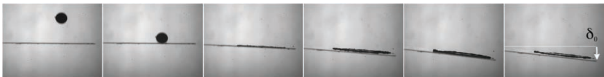
Figure C.8 – (a) Goutte de rayon R = 1.25 mm et vitesse V = 4 m/s impactant sur le bord libre d’une lamelle de verre. Chaque image est séparée par 1 ms et ne montre que le dernier tiers de la plaque. \delta_0 représente la déflexion maximum de la plaque après impact.
