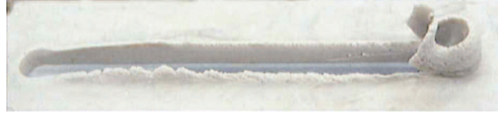
FIGURE 3.6 – Outil sans épaulement animé d'un simple mouvement d'avance dans la plasticine (Gratecap et al. [2007]).
