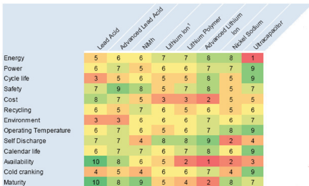
Figure 11 : Comparaison de différentes technologies de batterie [8] (1 – Mauvais, 10 – Excellent)
