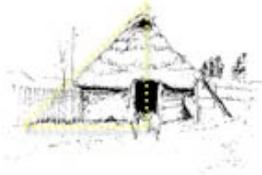
*Figure 29 Toiture pentue de la Casa Necoche met en évidence la volonté de éviter la stagnation des eaux pluie sur la toiture en paille. Photo et schéma G. Rodriguez*
