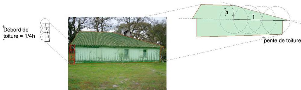
Figure 67, Aïrial landais, débord de toiture et pente de toiture.
