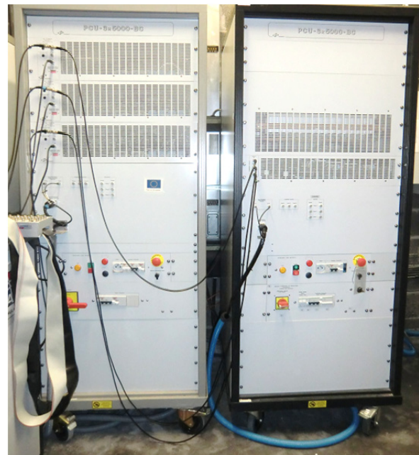
a) Calculateur RT-LAB ® à cœurs parallèles b) Amplificateur de puissance (2 x 15kVA)
