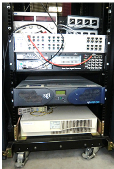
a) Calculateur RT-LAB ® à cœurs parallèles b) Amplificateur de puissance (2 x 15kVA)
