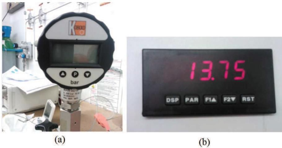
FIGURE 4.5 – a) Manomètre à affichage permettant de relever la mesure de pression de confinement et b) affichage du manomètre donnant la pression interstitielle
