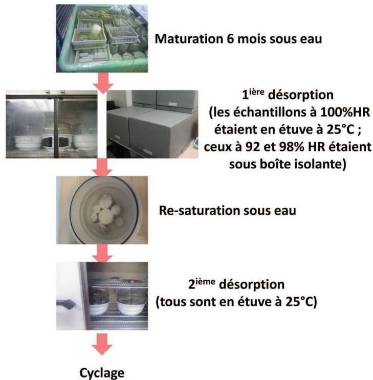
FIGURE 3.7 – Représentation du protocole expérimental de cyclage en désorption et sorption à haute HR.
