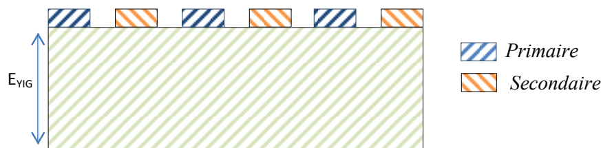
Figure 7 : Transformateur à une couche magnétique
