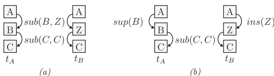
FIGURE 6.6 – Exemple de cas où LPCA-DC peut réaliser une substitution de score négatif. Si le coût de  $sub(B, Z)$  est plus faible que celui de  $sup(B) + ins(Z)$ , les transformations représentées en (a) seront préférées à celle figurant en (b).
