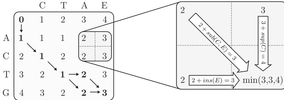
FIGURE 1.12 – Table  $T$  de l’algorithme de Needleman-Wunsch obtenue lors de l’alignement des séquences “ACTG” et “CTAE”. Les arcs représentent les chemins suivis par l’algorithme fournissant les deux alignements globaux de coût minimal représentés en figure 1.11b. La formule de récurrence de l’algorithme consistant en la minimisation de trois termes est illustrée par un zoom sur une sous-partie du tableau.
