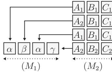
FIGURE 1.9 – Modélisations  $(M_1)$  et  $(M_2)$  envisagées afin de permettre d’appliquer les algorithmes du domaine de la fouille de séquences à des tableaux d’annotations. Dans  $(M_1)$ , chaque tableau d’annotations est modélisé par une séquence dont chaque caractère correspond à une ligne. La modélisation  $(M_2)$  associe à chaque annotation son caractère, ce qui produit un tableau de caractères.
