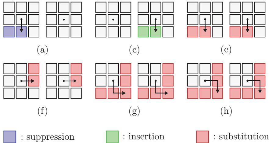
FIGURE 6.3 – Opérations d'édition considérées lors du calcul de la dissimilarité entre deux tableaux d'annotations. (a) Suppression de ligne. (c) Insertion de ligne. (e) Substitution de ligne. (f) Substitution de colonne. (g) et (h) Substitution de ligne et de colonne (dans un ordre différent). Les lettres identifiant les opérations correspondent à celles utilisées dans la figure 1.16.
