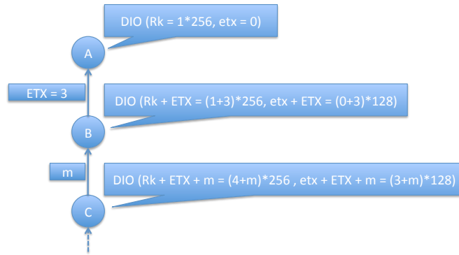
Figure 7.15: Propagation de la métrique dans les DIO
