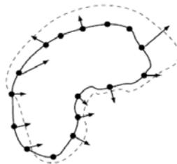
FIGURE 1.10 – Illustration de la méthode Front-Tracking
