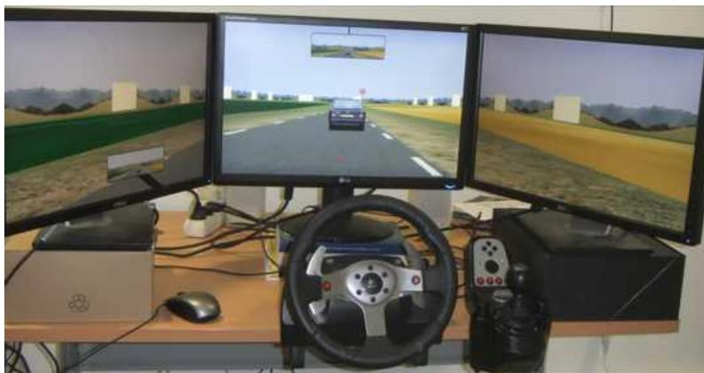
*Figure 3.2* – Dispositif du simulateur de conduite (avec 3 écrans, volant, boîte de vitesse et pédalier) utilisant le simulateur de trafic routier *ARCHISIM*.
