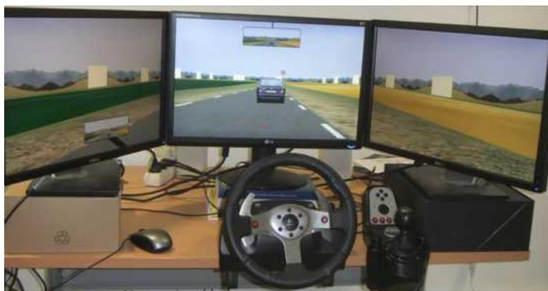
Figure 8.2 – Dispositif du simulateur de conduite (avec 3 écrans, volant, boîte de vitesses et pédalier) utilisant le simulateur de trafic routier ARCHISIM.
