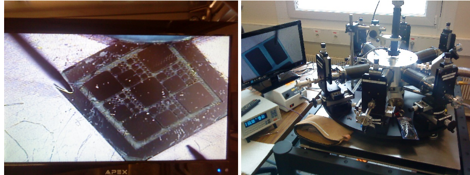
FIGURE II.56 – Plateforme de caractérisation CARAPACE, impliquant l'équipe EP et MDE du G2Elab et l'équipe SCLB de Néel. A gauche, des diodes Schottky diamant en caractérisation, à droite, photographie de l'enceinte sous vide peu après sa mise en service en 2013.
