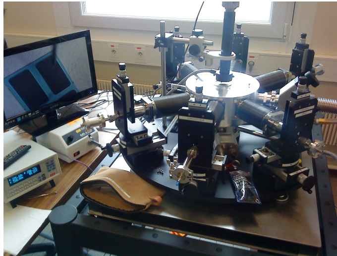
FIGURE I.33 – Plateforme de caractérisation CARAPACE pour la caractérisation multiphysique des composants et fonctions intégrées. Cinq pointes avec micro-positionneurs 3 axes sont disponibles, ainsi qu'un porte échantillon blindé et une fibre optique dans l'enceinte. La passivation électrique se fait par vide secondaire, et la température est contrôlée sur la plage 8K-675K par un refroidissement liquide LN2 ou LHe, et un élément chauffant dans le porte échantillon.
