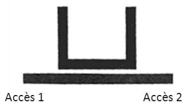
**Figure 7 : Dessin d'un résonateur en "U".**
