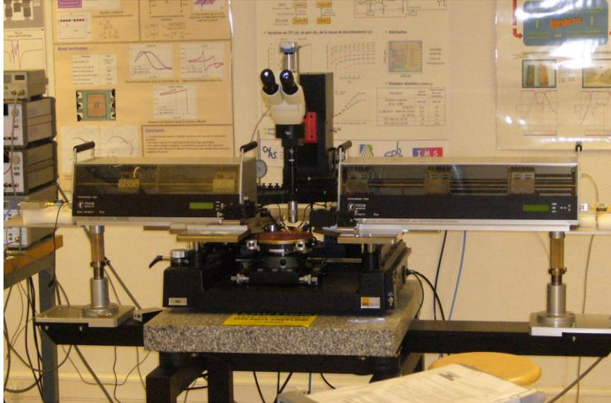
**Figure 112 : Banc Load-pull.**
