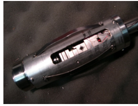
FIGURE 2.4: Extrémité de la canne contenant l'objectif de microscope, le scanner piézo-électrique avec l'échantillon et les nano-positionneurs piézo-électriques.
