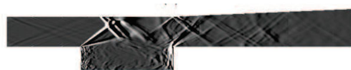
FIGURE 6.2: Champ *Schlieren* obtenu par simulation TANN-LES [84].
