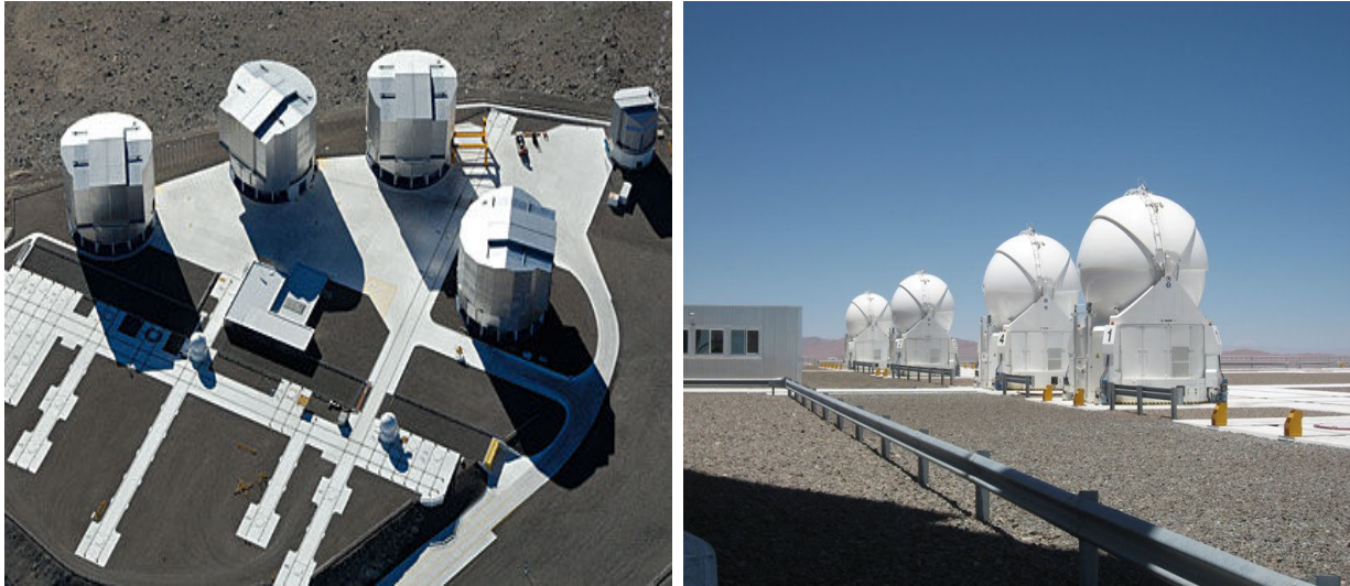
Figure II.17 – Gauche : quatre télescopes primaires de 8.2 m de diamètre. Droite : quatre télescopes secondaires de 1.8 m de diamètre. Crédit : ESO.
