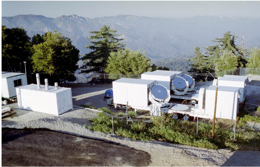
Figure II.20 – Trois télescopes mobiles de ISI constitués les trois lignes de bases de 4 m, 8 m et 12 m de longueur.
