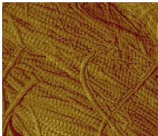
Figure 1.22 : Fibres de collagène vues au microscope à force atomique (AFM) [d'après Wang et al. , (WANG et al. , 2010b)].
