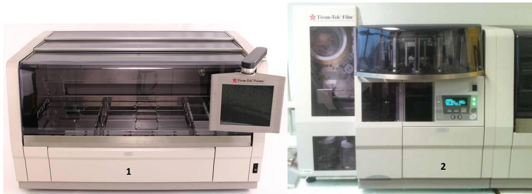
Figure 2.46 : Automates de coloration et de lutage utilisés pour les lames histologiques (1 : Tissue-Tek ® Prisma ® ; 2 : Tissue-Tek ® Film ® ).
