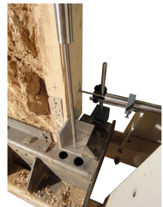
(c) LVDT mesurant le soulèvement et le déplacement latéral de la seconde connexion type-1 droite
