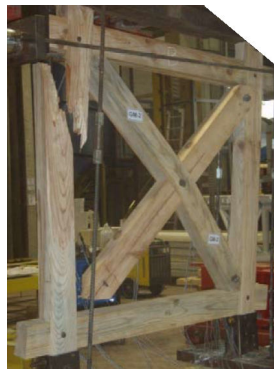
(b) SR2 : rupture du poteau en traction
