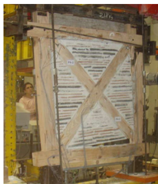
(e) R2 : rupture du poteau en traction
