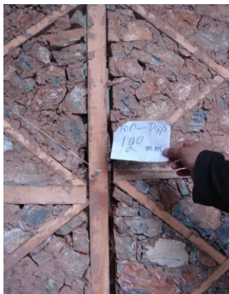
(a) Expérimental : rupture de l'assemblage type-5, [5]
