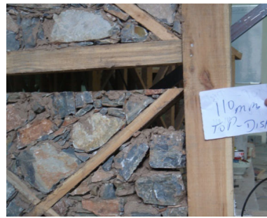
(b) Décrochement du contreventement du cadre principal
