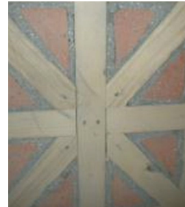
(c) Faibles déformations de l'assemblage central
