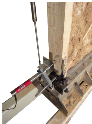
(b) LVDT mesurant le soulèvement et le déplacement latéral de la première connexion type-1
