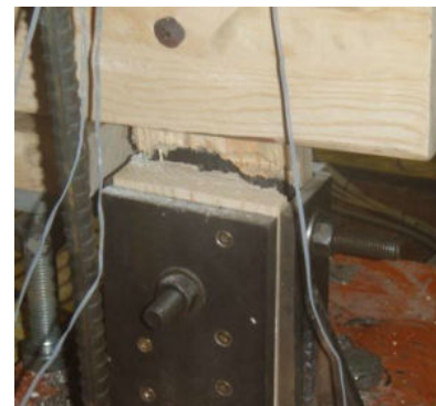
(f) R3 : rupture du poteau en traction au niveau de l'embase métallique
