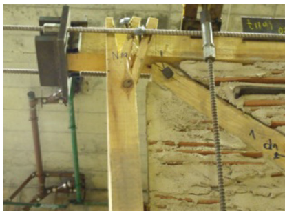
(a) Essai 1 : rupture des connexions hautes mi-bois des poteaux
