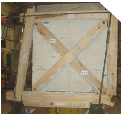
(d) R1 : rupture en cisaillement du bois dans l'assemblage mi-bois poteaux-lisse basse
