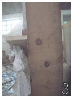
(a) RP : glissement hors-plan du remplissage dû à l'absence de connexion diagonale-cadre
