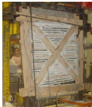
(e) R2 : rupture du poteau en traction
