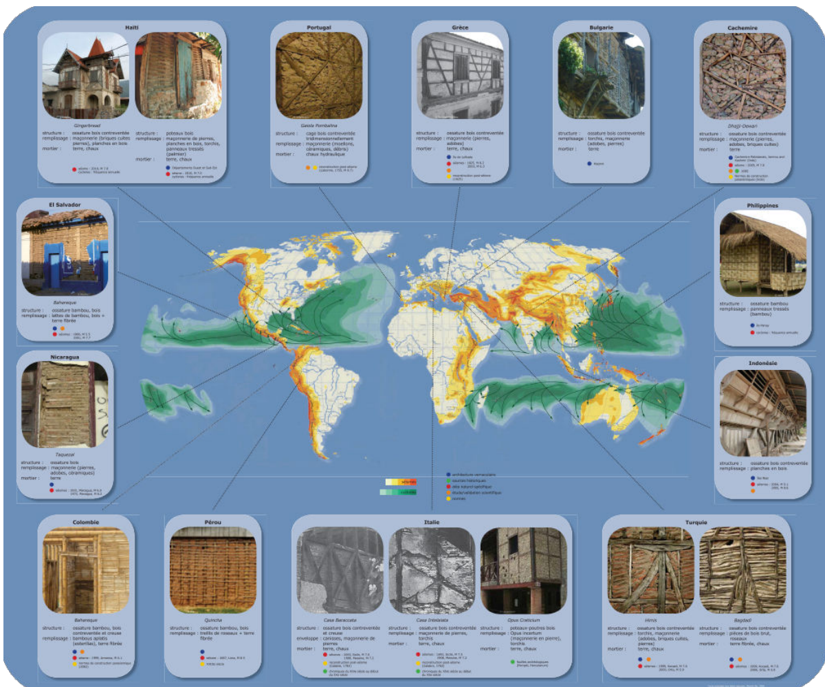
FIGURE 2 – Exemples de systèmes constructifs vernaculaires à ossature en bois ou en bambou, [15]
