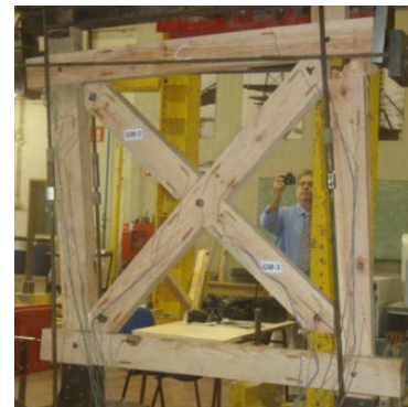
(c) SR3 : rupture du poteau en traction dans l'assemblage mi-bois poteaux-lisse haute
