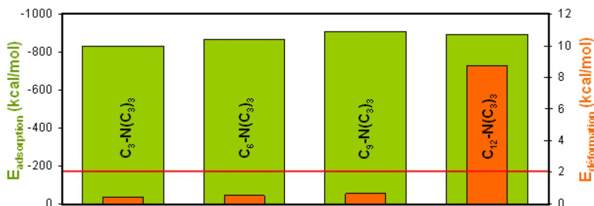
Fig.6: Énergies d'interaction de composés organiques monoazotés R-N(C<sub>3</sub>)<sub>3</sub> avec R=C<sub>3</sub>, C<sub>6</sub>, C<sub>9</sub> ou C<sub>12</sub>
