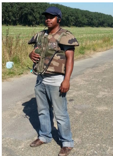
Fig. 6.11 : Gilet GIANTE intégrant l'antenne GIANTE 1 porté par l'utilisateur 1.
