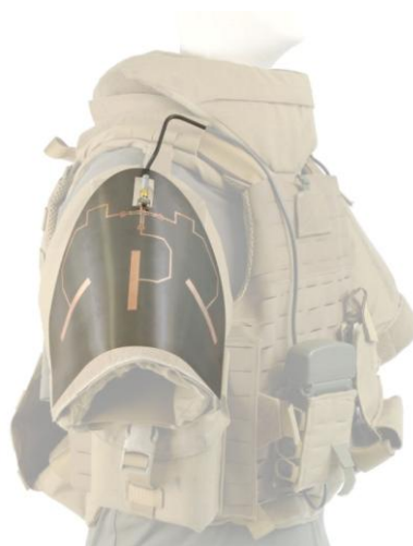
Fig. 6.14 : Groupe d'antennes droit intégré dans le gilet militaire 2.
