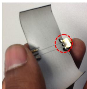
Fig. 2.37 : Photo de l'échantillon B 1 X 2 après deux jours de séchage de colle conductrice.
