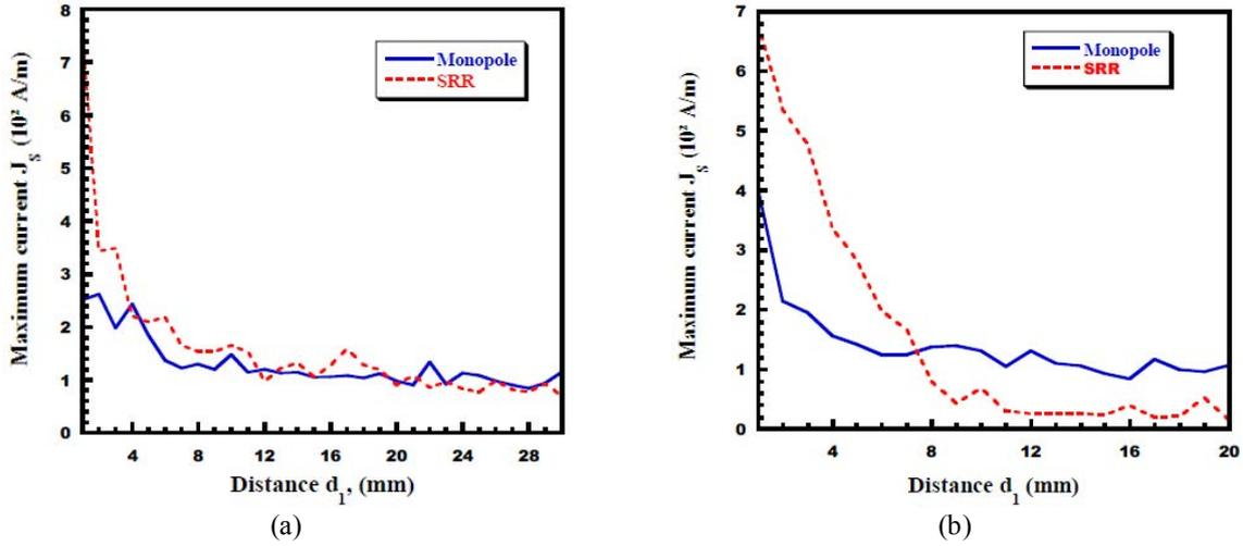
**Figure III.21:** Courant Maximum  $J_s$  (A/m), à la fréquence  $F_R$ , sur le monopôle et sur le SRR en fonction de la distance de couplage  $d_1$ , (a) Configuration A1 ( $F_{R1}=1.55$  GHz), (b) Configuration A2 ( $F_{R2}=1.75$  GHz).
