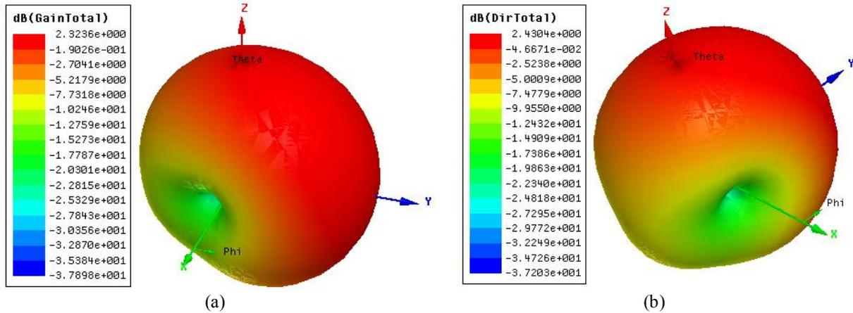
**Figure II.35:** Diagrammes de rayonnement simulés de l'antenne dipôle à la fréquence  $F_d = 2.45$
