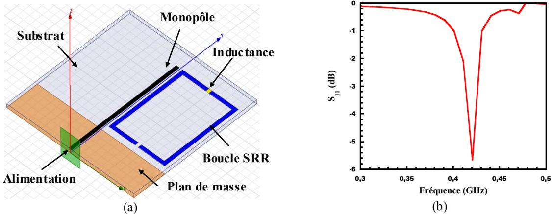
**Figure II.24:** Antenne monopôle imprimée avec un parasite vertical et une self inductance:
