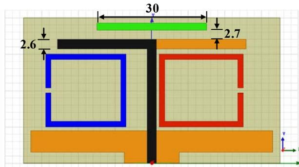
Figure II.48: Géométrie de l'antenne et dimensions de l'élément parasite (mm).
