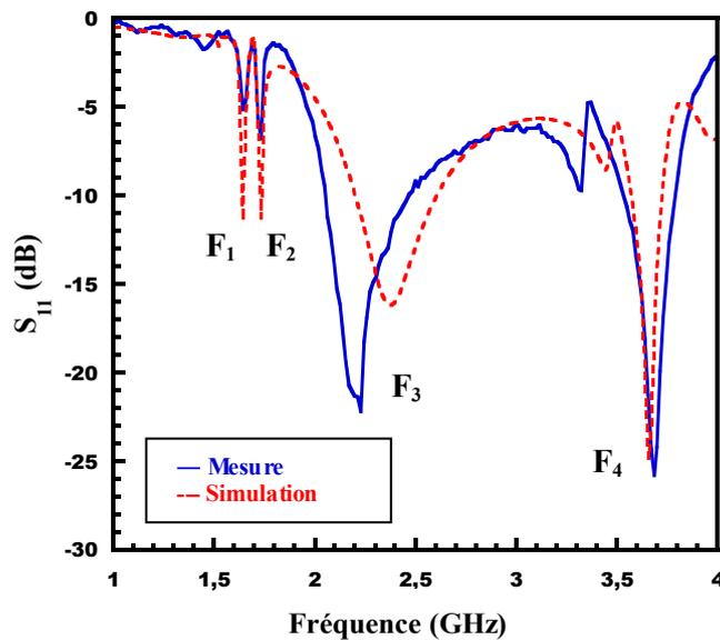
Figure II.50: Coefficient de réflexion simulé de l'antenne étudiée.
