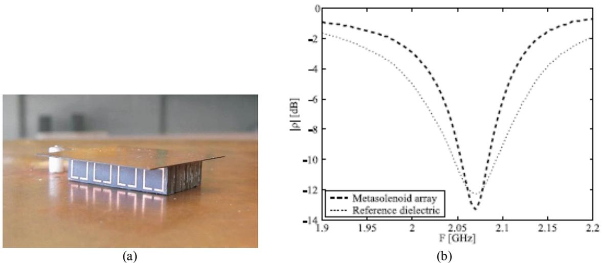
**Figure I.9:** (a) Antenne micro ruban imprimée sur un substrat chargé par des cellules SRRs (Split Ring Resonators) et (b) : coefficient de réflexion de l'antenne avec différents substrats.
