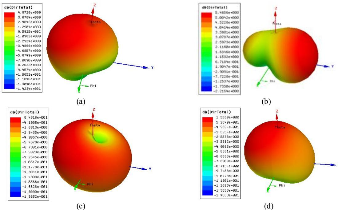
**Figure IV.14:** Diagrammes de rayonnement 3D simulés: (a) Etat A ( $F_R=1.551$  GHz), (b) Etat B ( $F_R=1.722$  GHz), (c) Etat C ( $F_R=1.617$  GHz) et (d) Etat D ( $F_R=1.366$  GHz).
