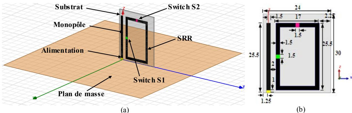
Figure IV.1: Structure de l'antenne proposée avec deux circuits ouverts : (a) Modèle HFSS, (b) Géométrie.
