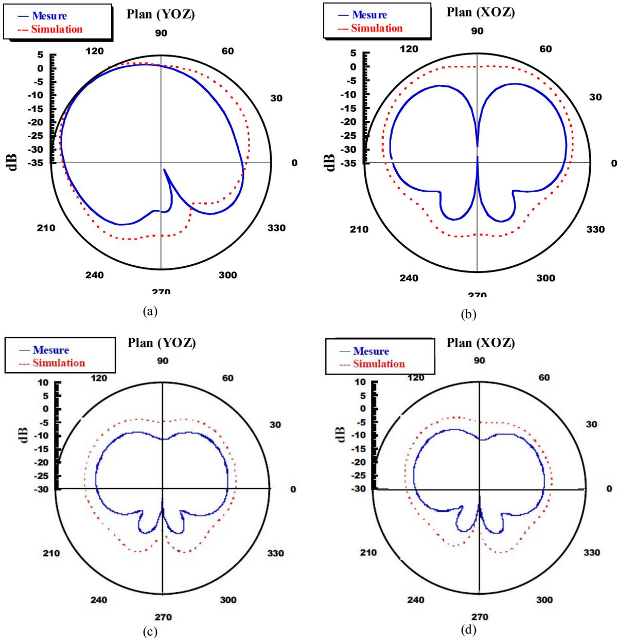
**Figure III.13:** Diagrammes de rayonnement simulé et mesurés à la fréquence  $F_R$  pour, A1 : (a) dans le plan (XOZ), (b) dans le plan (YOZ) et l'antenne A4 (c) dans le plan (XOZ) et (d) dans le plan (YOZ).
