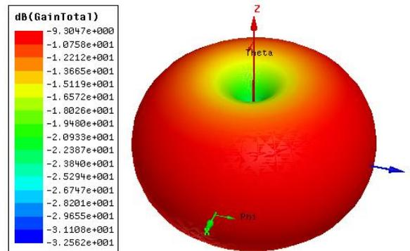
Figure II.13: Diagramme de rayonnement 3D simulé (Gain, dB).
