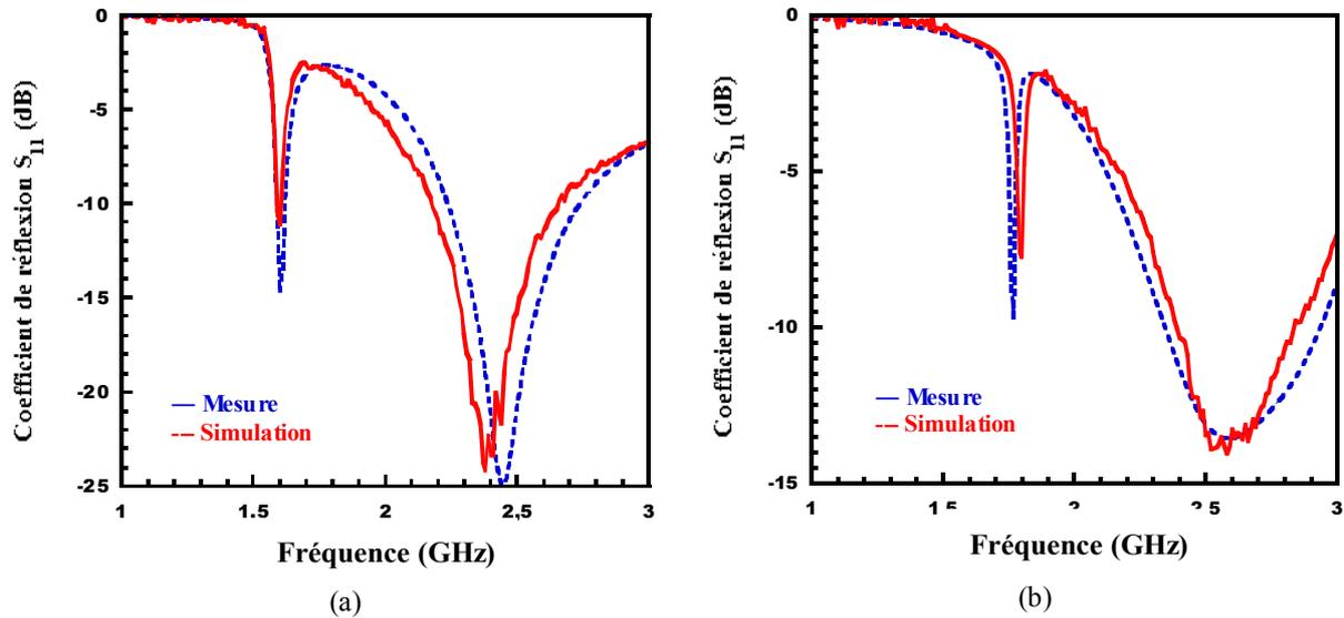
Figure II.24: Le coefficient de réflexion simulées et mesurées des deux configurations A1 (a) et A2 (b).
