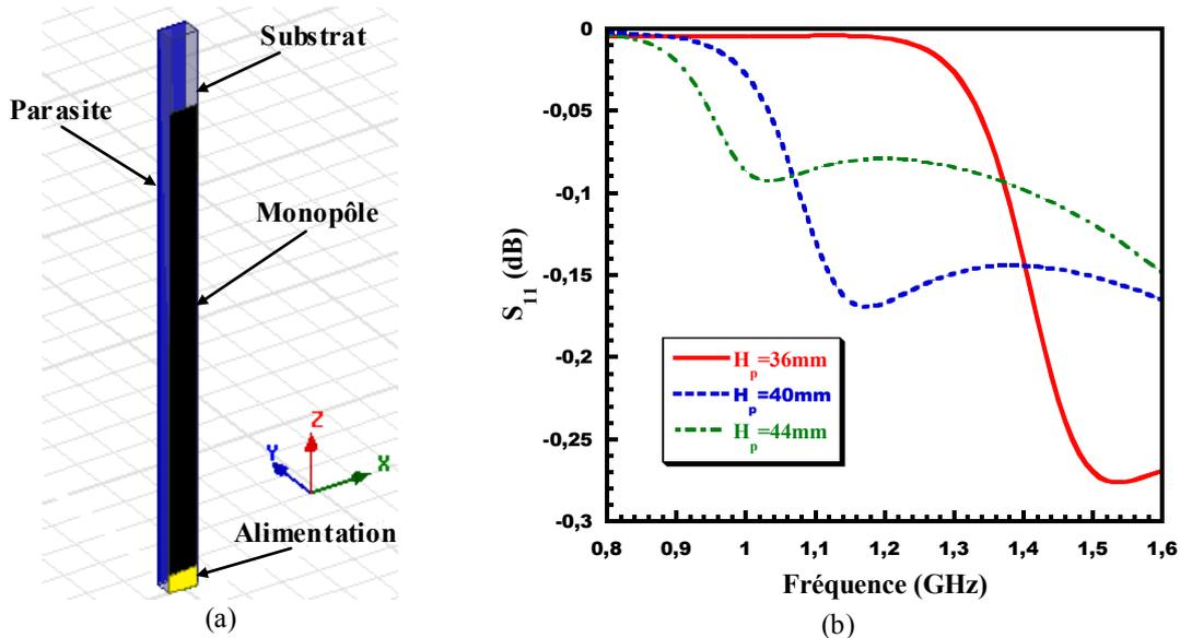
Figure II.8: Etude de l'impact de la longueur  $H_p$  sur la fréquence  $F_r$ :
