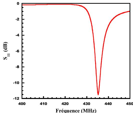
**Figure. II.40:** Simulation du coefficient de réflexion  $S_{11}$ .
