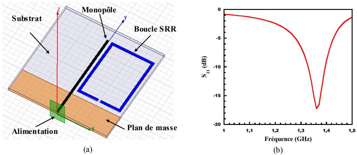
**Figure II.22:** Antenne monopôle imprimée avec un anneau à (à fente) parasite:
