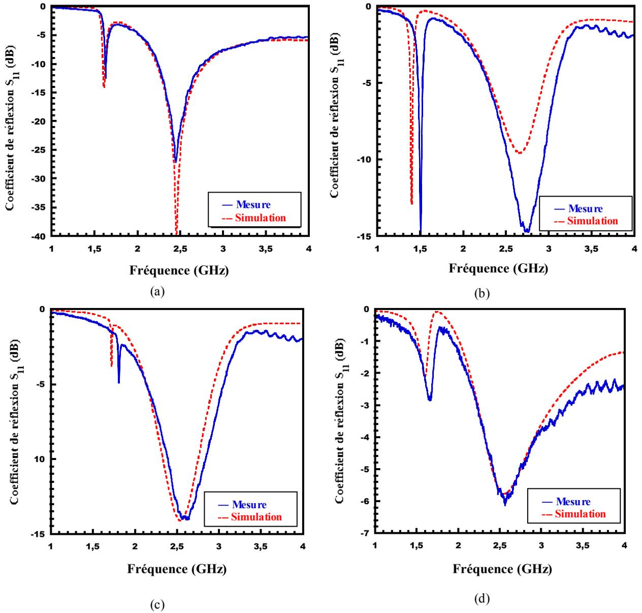
Figure III.12: Le coefficient de réflexion simulées et mesurées des antennes :
