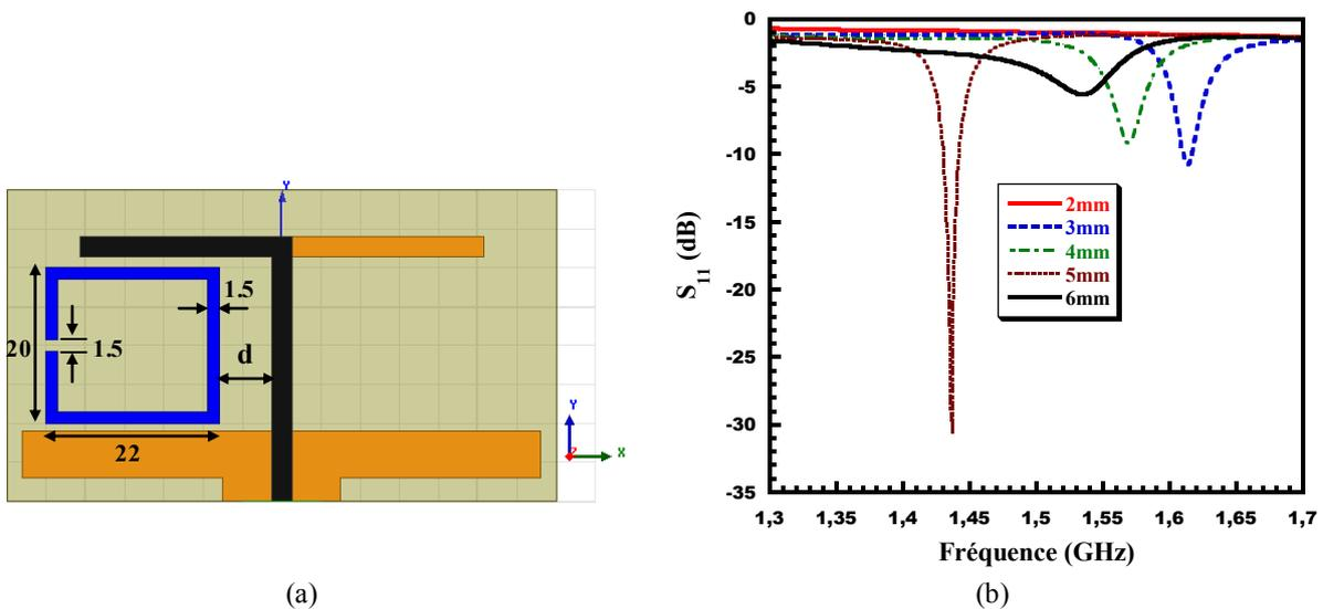
Figure II.37: Impact de la distance  $d$  : (a) Géométrie et dimension en (mm), (b) Coefficient de réflexion  $S_{11}$ .
