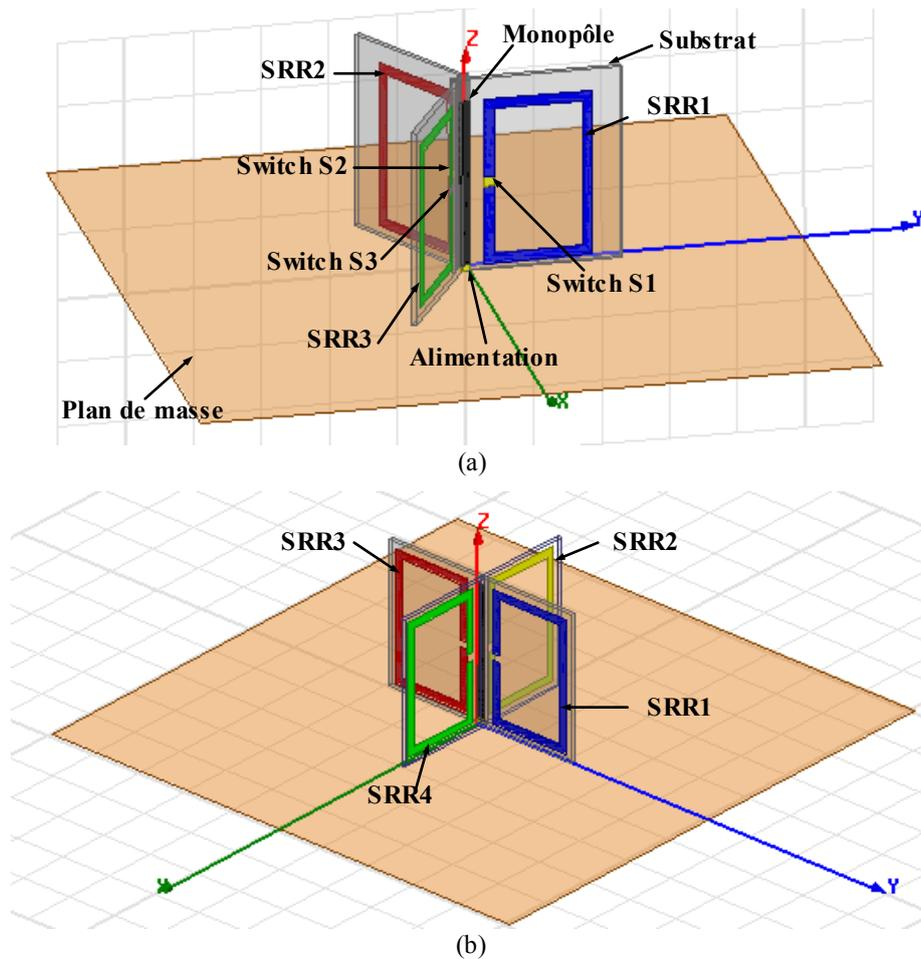
Figure IV.25: Modèle HFSS des trios structures proposées avec :
