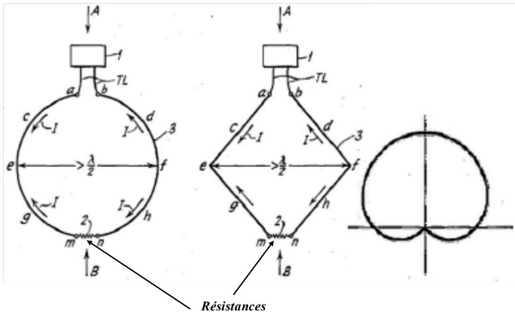
Figure I.17: Principe de directivité de l'antenne de Beverage.
