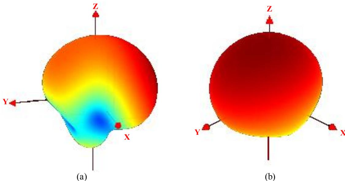
**Figure IV.9:** Diagrammes de rayonnement mesurés pour l'antenne à un élément SRR:
