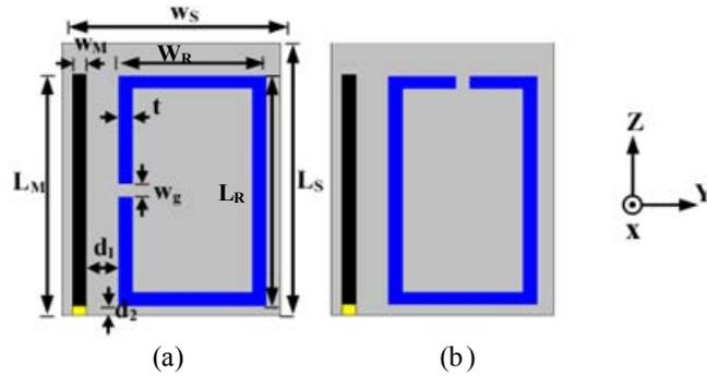
Figure III.15: Géométries des deux configurations de l'antenne proposées : (a) Antenne A1 ; (b) Antenne A2
