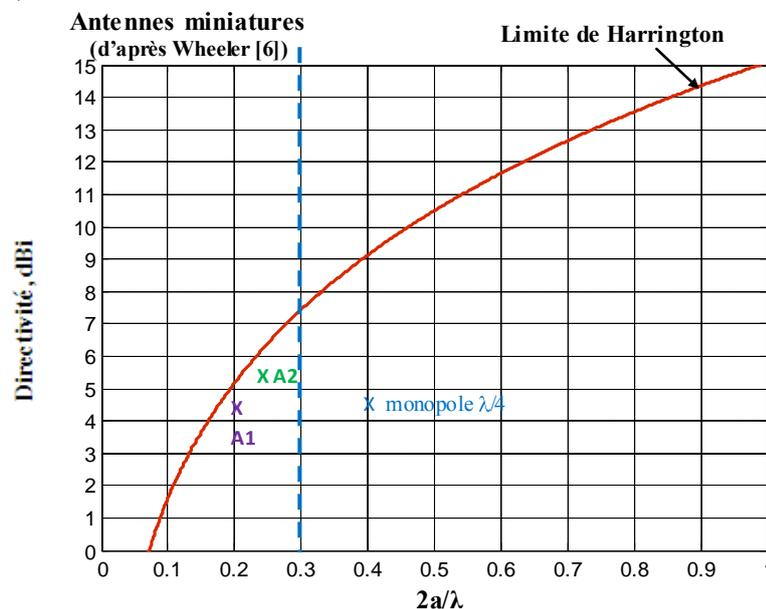
Figure III.19: Directivité en dBi de différentes antennes en fonction de leur taille ( $2a/\lambda$ ).
