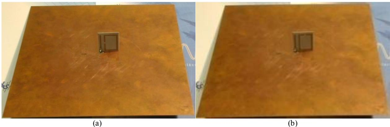
**Figure III.23:** Photos des prototypes réalisés: (a) antenne A1; (b) antenne A2.
