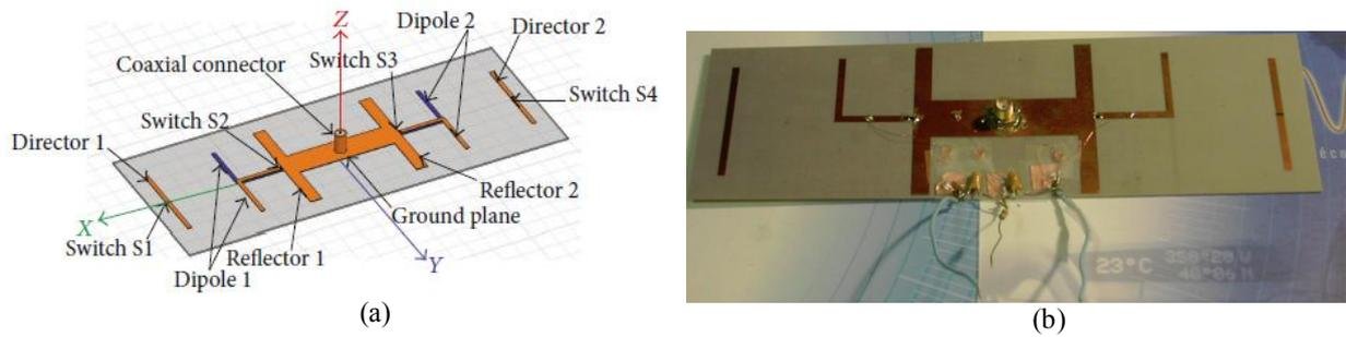
**Figure 1.29:** Antenne reconfigurable en diagramme par l'utilisation d'une ligne commutable :
