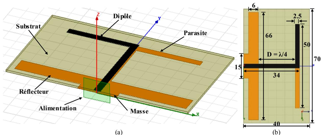
La longueur  $D$  est indispensable puisqu'elle correspond à la longueur électrique  $\lambda/4=25\text{mm}$  qui fixe la fréquence de résonance du dipôle à  $F_d = 2.45\text{GHz}$ . Nous nous proposons dans cette section d'exploiter l'espace limité par la distance  $D$  afin d'ajouter une boucle SRR afin de miniaturiser l'antenne ensuite obtenir un comportement multifréquence par rajout d'autres boucles. Pour cela nous avons d'abord étudié le comportement du dipôle seul en termes d'impédance.
