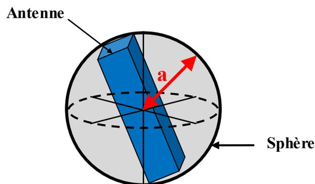
*Figure I.1: Schéma de la sphère équivalente d'une antenne.*
