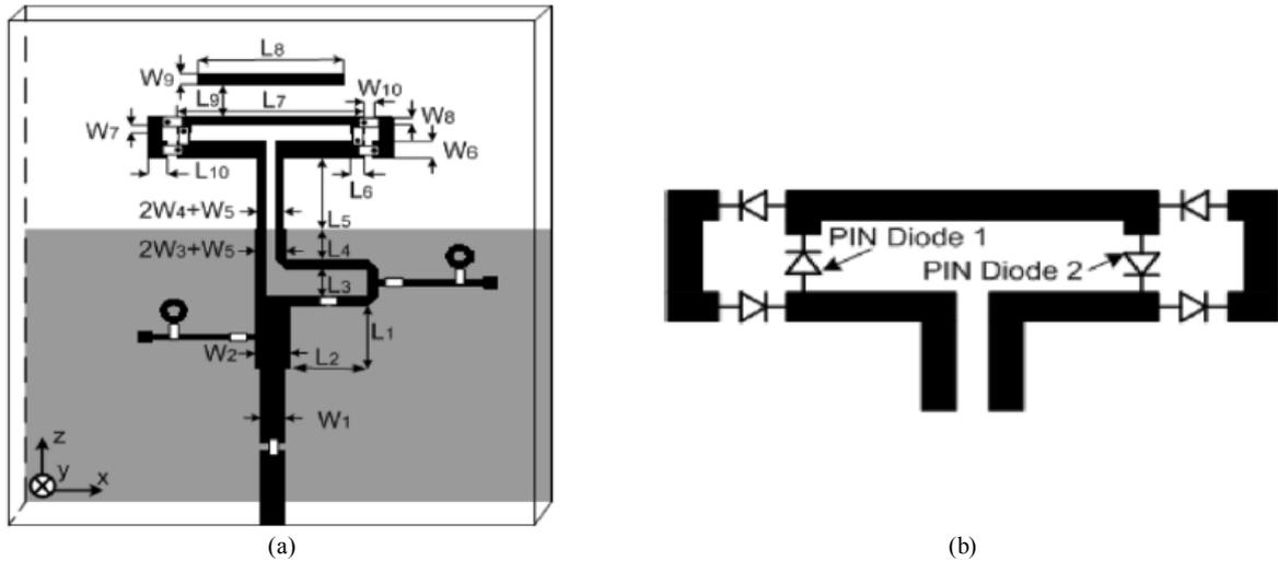
**Figure I.24:** Antenne quasi-Yagi à dipôle replié reconfigurable en fréquence :
