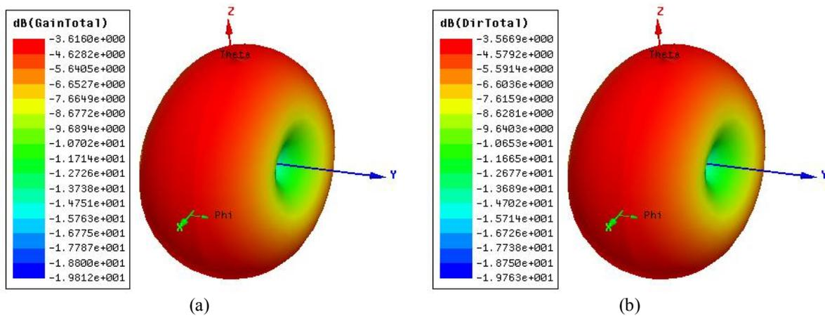
**Figure. II.41:** Diagrammes de rayonnement 3D simulés à 433 MHz :
