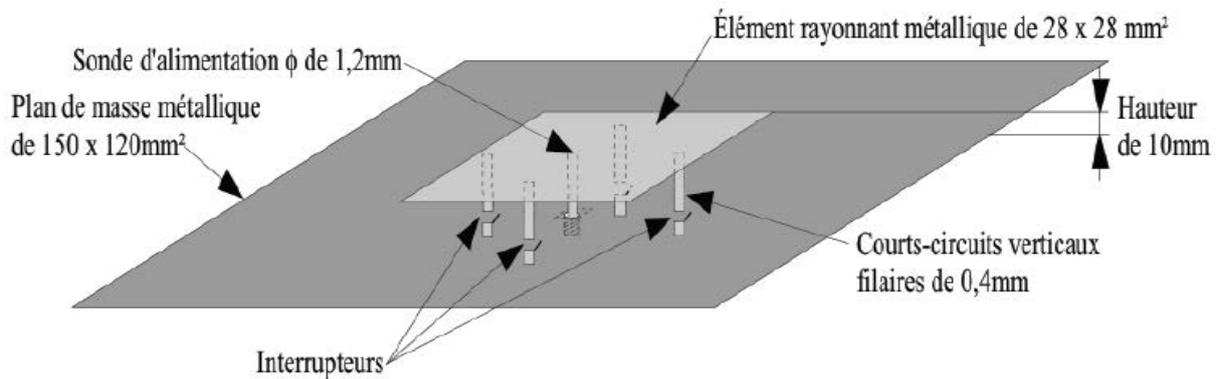
**Figure I.23:** Exemple d'antenne patch à courts-circuits commutables.
