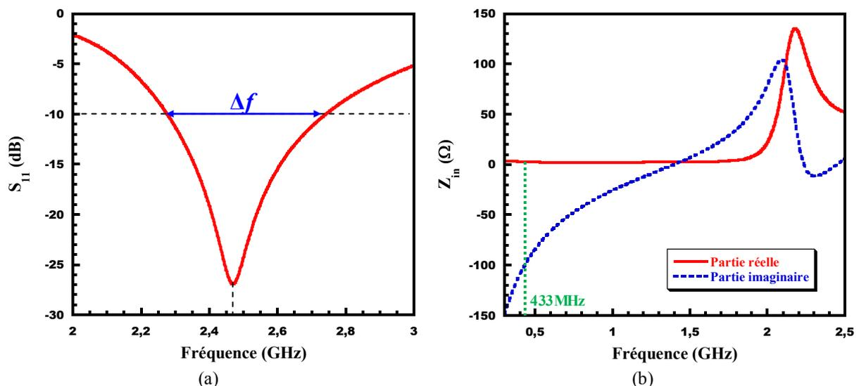
**Figure. II.34:** Résultats de simulation de l'antenne monopôle :
