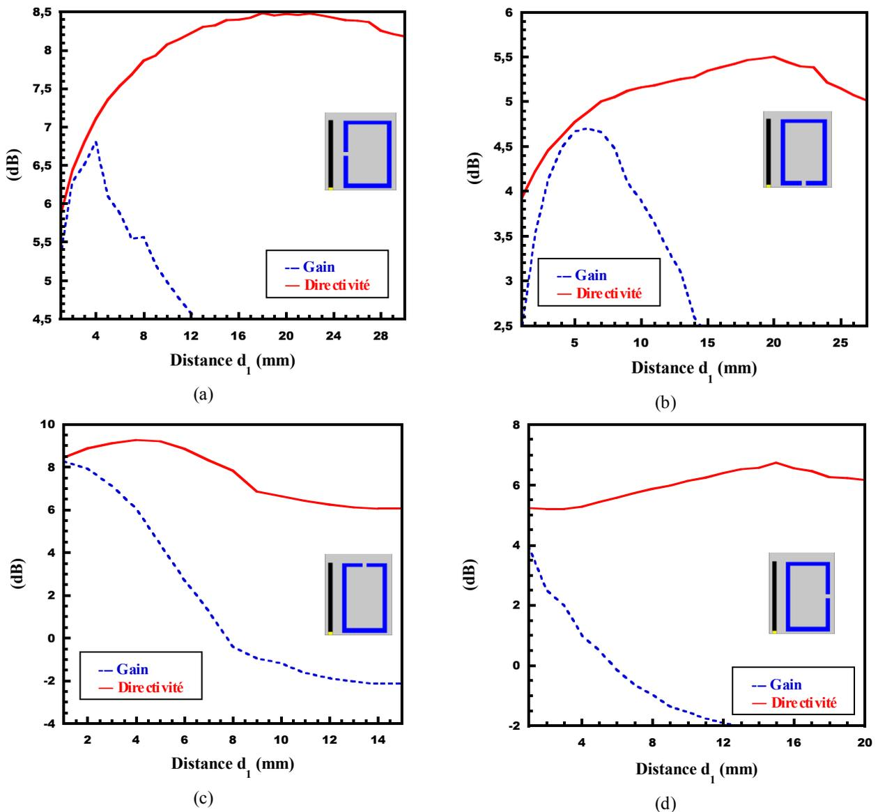
Figure III.10: Simulation du gain et la directivité en fonction de la distance de couplage  $d_1$  pour les quatre configurations A1 (a) ; A2 (b) ; A3 (c) et A4 (d).
