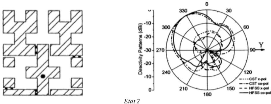
Figure I.25: Exemple d'antenne fractale reconfigurable en rayonnement.
