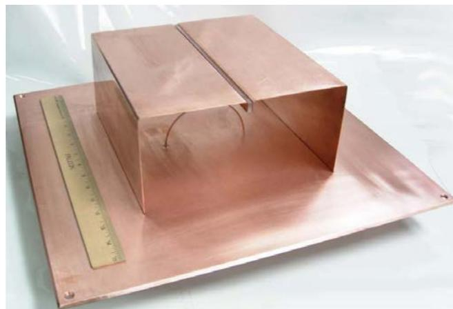
**Figure I.13:** Prototype de l'antenne Z (3D).
