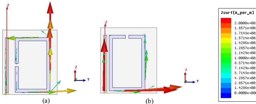
**Figure III.20:** Vecteur courant simulé sur le monopole et l'élément SRR à la fréquence de fonctionnement  $F_R$  et pour la distance de couplage  $d_1$ : (a) Configuration A1 ( $F_R = 1.55$  GHz,  $d_1 = 4$  mm); (b) Configuration A2 ( $F_R = 1.75$  GHz,  $d_1 = 1$  mm).
