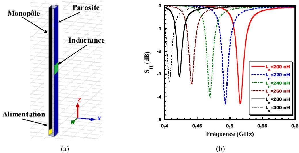
Figure II.9 : Etude de l'impact de la valeur de l'inductance  $L_p$  sur la fréquence  $F_r$  :
