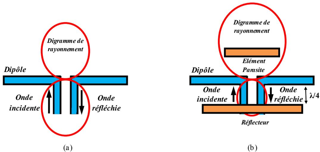
**Figure I.19:** Exemple d'une antenne à éléments parasites :
