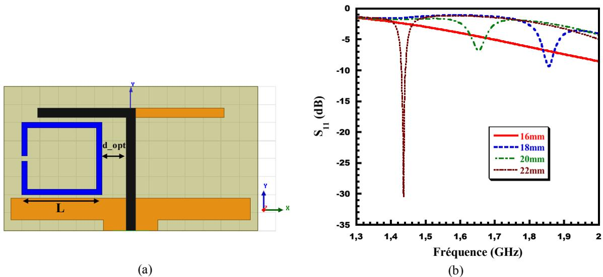
Figure. II.38: Impact de la longueur  $L$  : (a) Géométrie (b) Coefficient de réflexion  $S_{11}$ .
