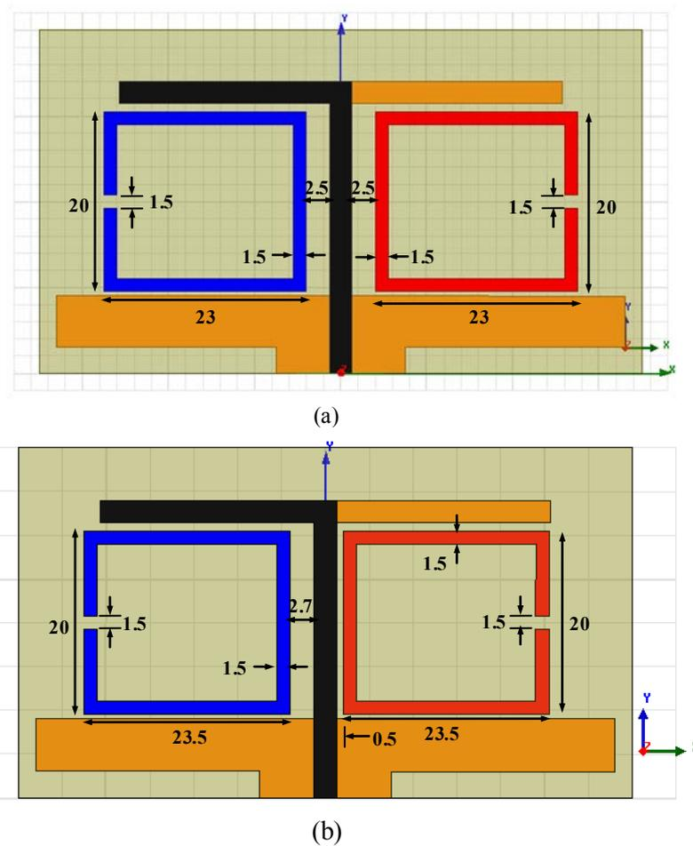
**Figure II.42:** Géométries et dimensions (mm) des antennes proposées:
