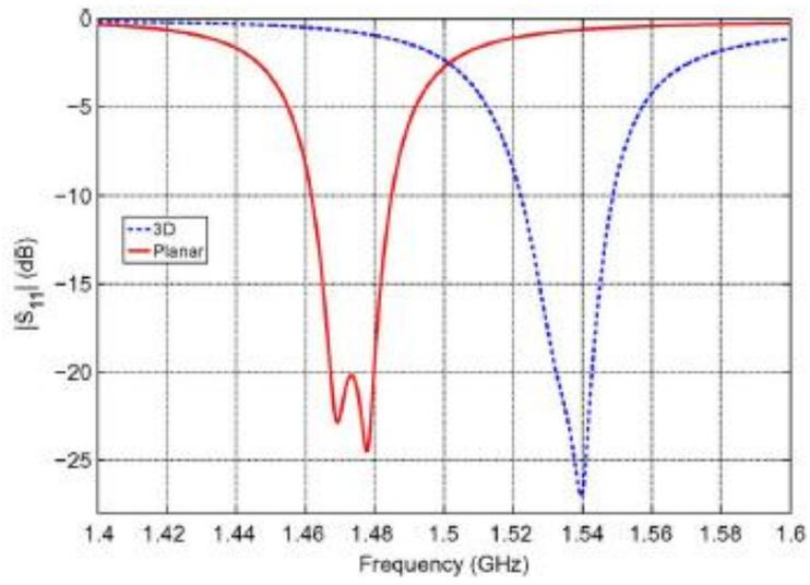
**Figure III.5 :** Coefficients de réflexion simulés des deux sources de Huygens : modèle 3D (bleu) et modèle 2D (rouge).
