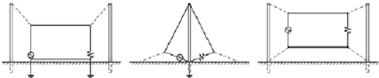
Figure I.18: Exemples d'antennes boucles miniatures chargées par des résistances employées par les radios amateurs.
