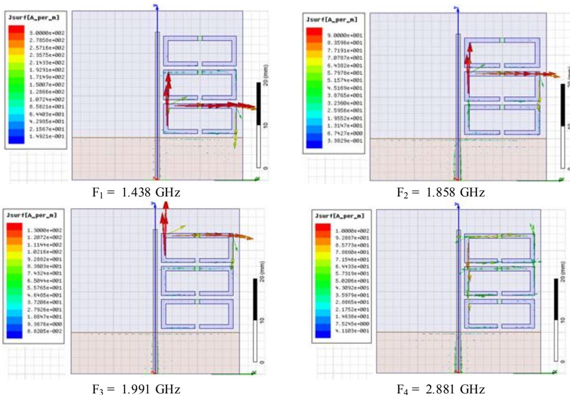
Figure II.28: Vecteur courants surfaciques simulés de l'antenne A3.
