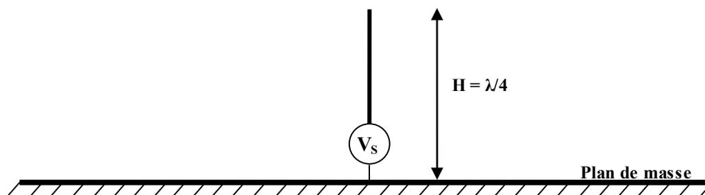
*Figure II.1: Géométrie d'une antenne monopôle.*
