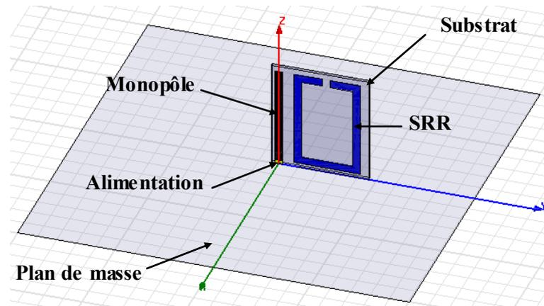
Figure III.31: Schéma du monopôle associé à un élément SRR (Source d'Huygens).
