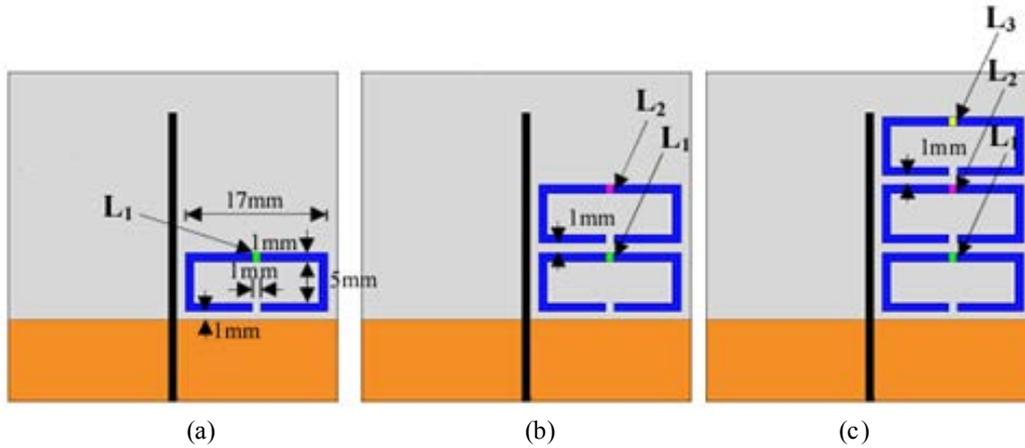
**Figure II.26:** Géométries et dimensions des antennes proposées :
