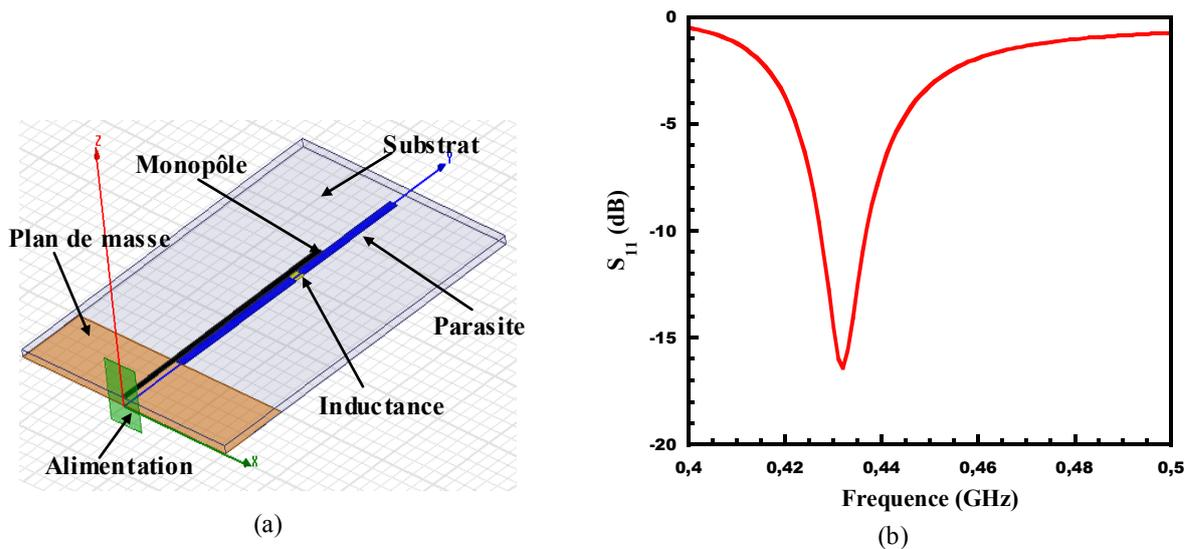
**Figure II.19:** Antenne monopôle imprimée avec un parasite vertical et une self inductance: (a) Modèle HFSS, (b) Coefficient de réflexion  $S_{11}$ .
