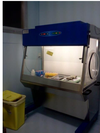
Dispositif pour la dissection des rats après leur euthanasie, hotte à flux laminaire Spéciale Animalerie CRLF/ faster stab 4
