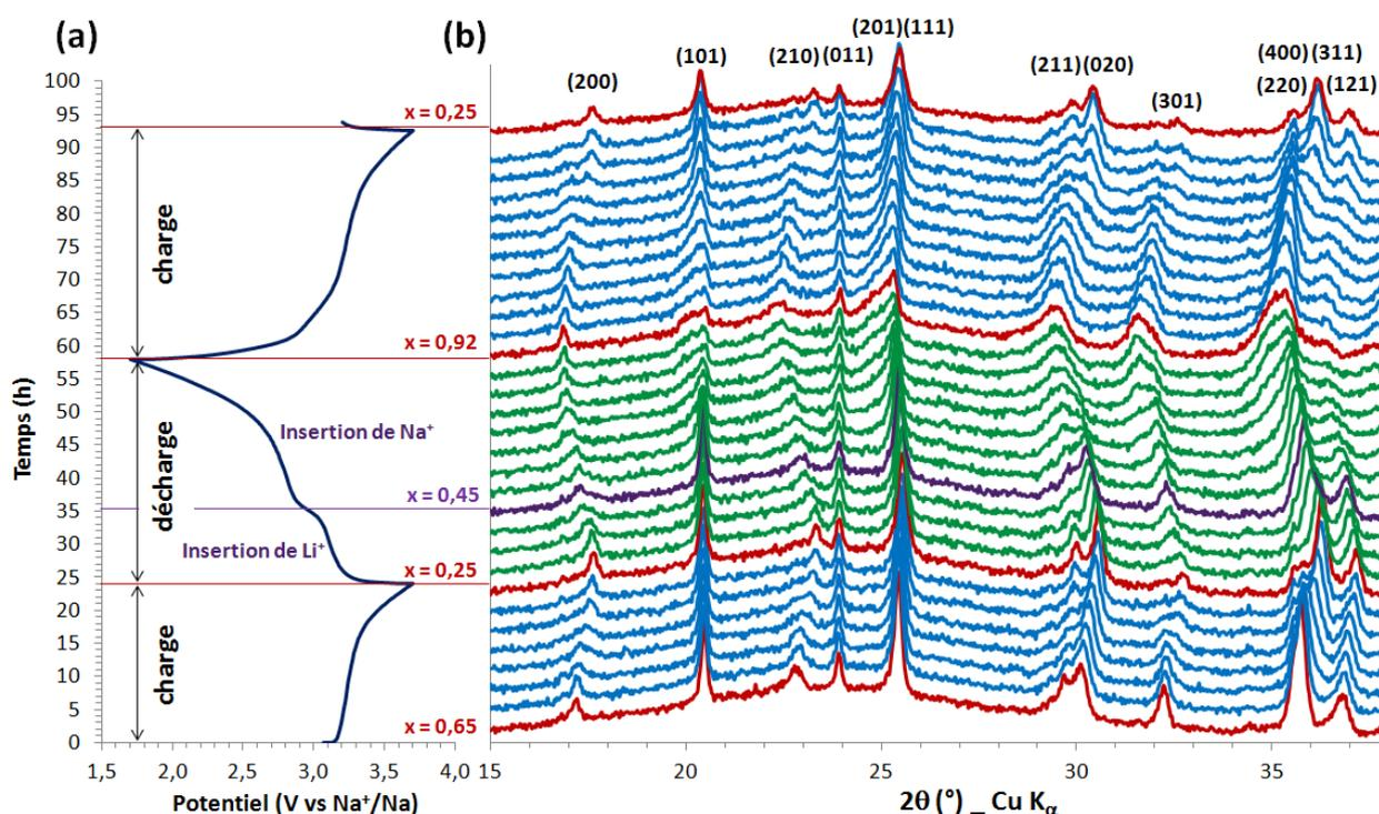
Figure 6. 14 : Caractérisations électrochimique et structurale de l'échantillon LFP-SR-D1 (délithié à 35%) en demi-cellule sodium. (a) Cycle de charge/décharge/charge effectué à C/50. (b) Diffractogrammes des rayons X operando réalisés à différents états de charge, montrant un décalage progressif des raies en fonction de l'état de charge.
