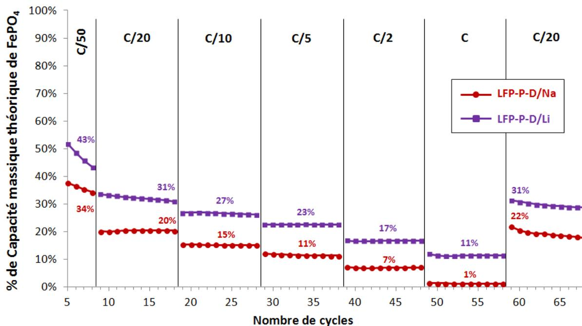
Figure 5. 18 : Pourcentage des capacités massiques théoriques de l'échantillon LFP-P-D testé en demi-cellules sodium (courbe rouge) et lithium (courbe violette) à différents régimes sur 68 cycles.
