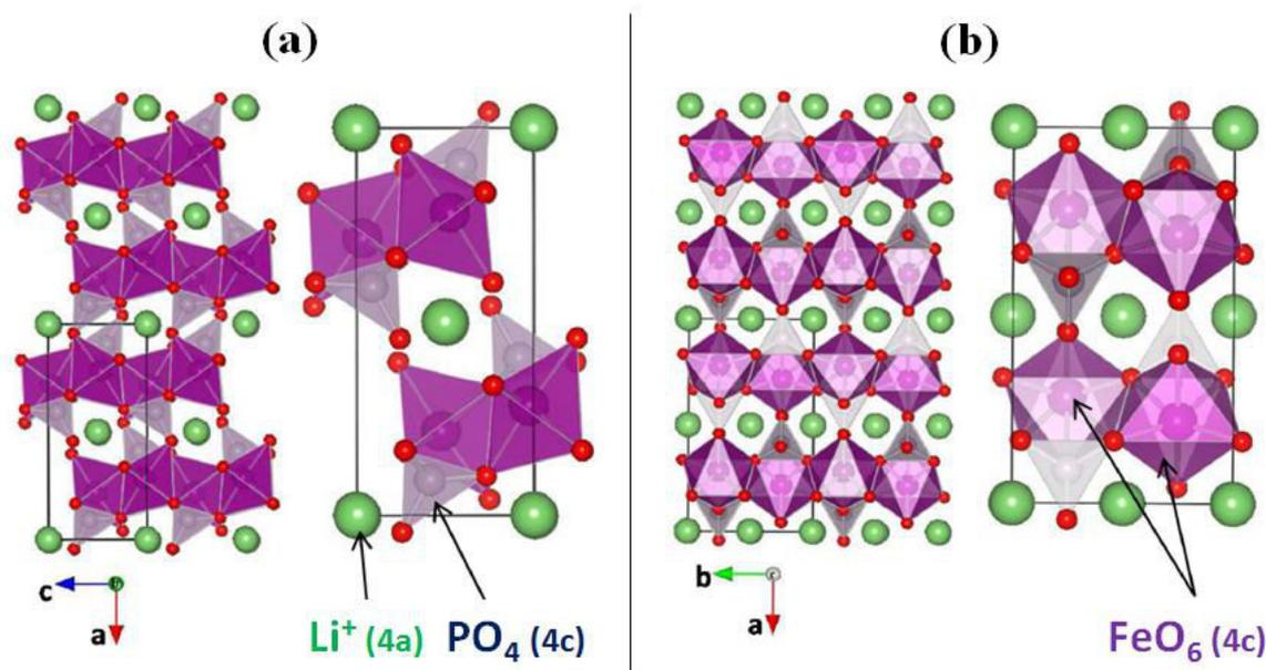
Figure 1.1 : Vue de différentes orientations de la structure olivine de  $\text{LiFePO}_4$ , (a) dans le plan  $(010)$  et (b) dans le plan  $(001)$  (inspirée de la Figure I.1 de la thèse de D. Robert [10]).
