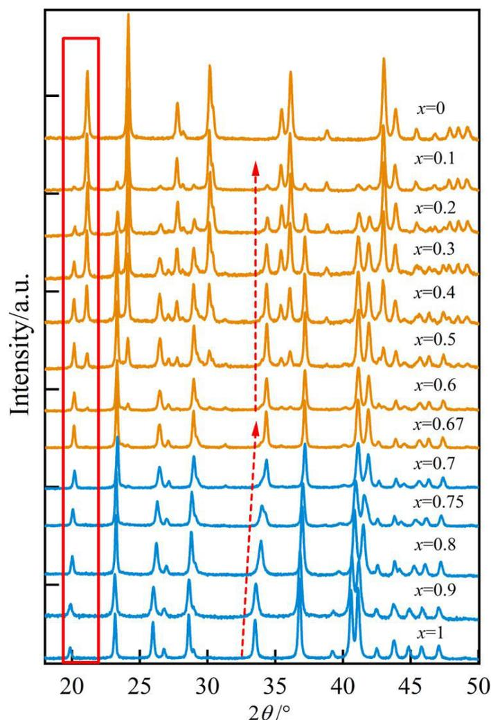
Figure 1. 22 : Diffractogrammes des phases  $\text{Na}_x\text{FePO}_4$  à différentes compositions de Na, issus des travaux de Lu et al. [120]. Diffractogrammes (bleus) montrant la présence de solution solide avec le décalage des pics pour  $2/3 < x < 1$ . Diffractogrammes (oranges) montrant la présence simultanée des phases  $\text{Na}_{2/3}\text{FePO}_4$  et  $\text{FePO}_4$  pour  $0 < x < 2/3$ .
