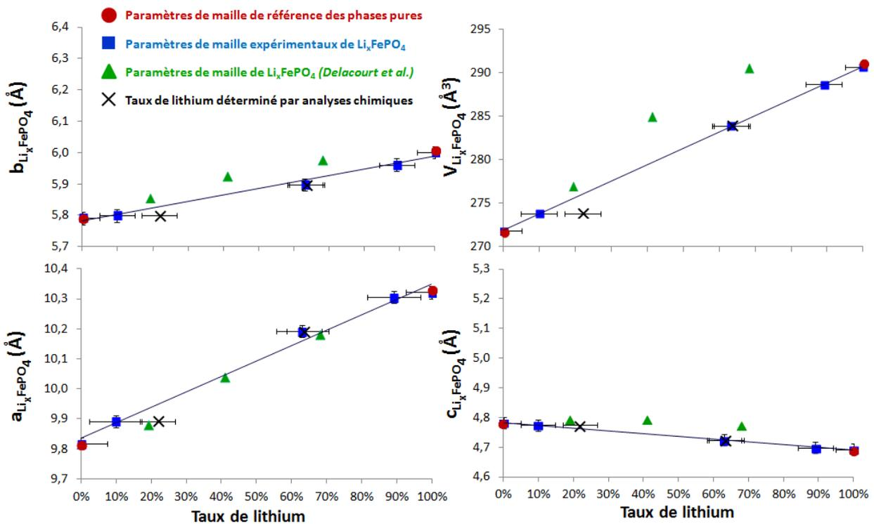
Figure 6. 4 : Evolution des paramètres de maille a, b, c et du volume de maille en fonction du taux de lithium déterminée par la loi de Végard pour la phase  $\text{Li}_x\text{FePO}_4$  (■) et par spectroscopie d'émission de flamme (×). Comparaison des valeurs expérimentales (■) et des valeurs issues des travaux de Delacourt et al. (▲) [6].
