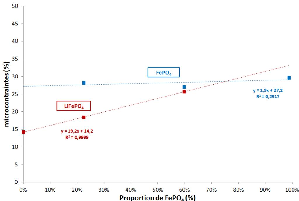
Figure 4. 15 : Evolution des microcontraintes des phases  $\text{LiFePO}_4$  (rouge) et  $\text{FePO}_4$  (bleu) avec la proportion de  $\text{FePO}_4$  obtenue durant la délithiation chimique de l'échantillon LFP-P.
