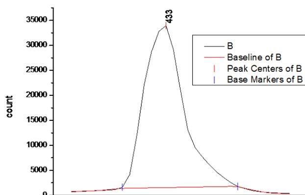
Figure A. 4 : Mesure de l'aire normalisée du pic d'énergie du spectre PIGE issu des rayons gamma à 478 keV.
