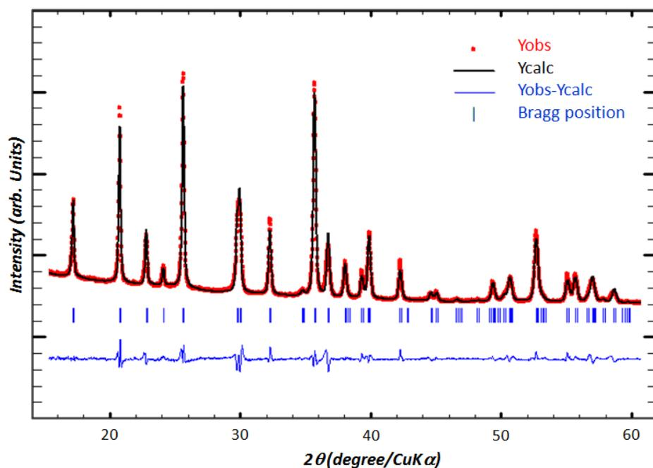
Figure 6. 1 : Diffractogramme de l'échantillon LFP-SR (sans recuit) dont les positions angulaires ont été affinées par la méthode de Le Bail (facteurs de confiance :  $R_p = 2,17$ ,  $R_{wp} = 3,19$  et  $\chi^2 = 6,64$ ).
