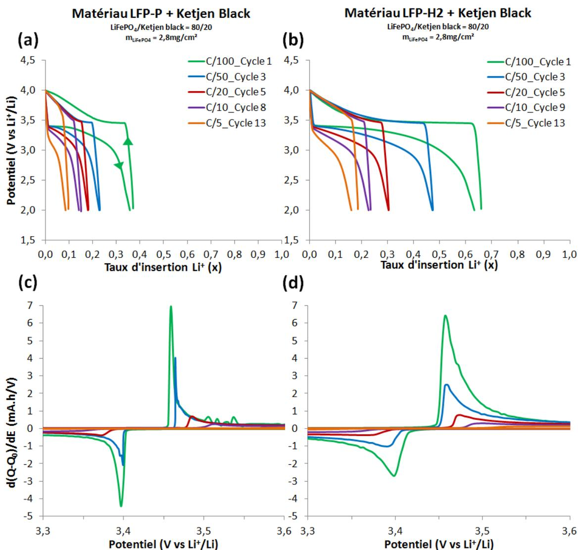
Figure 5. 6 : Caractérisations électrochimiques des matériaux actifs formulés avec du carbone Ketjenblack *par broyage manuel*. Potentiel en fonction du taux d'insertion de  $\text{Li}^+$  (a) pour LFP-P et (b) pour LFP-H2 ; courbes  $dQ/dE$  de la capacité en fonction du potentiel (c) pour LFP-P et (d) pour LFP-H2.
