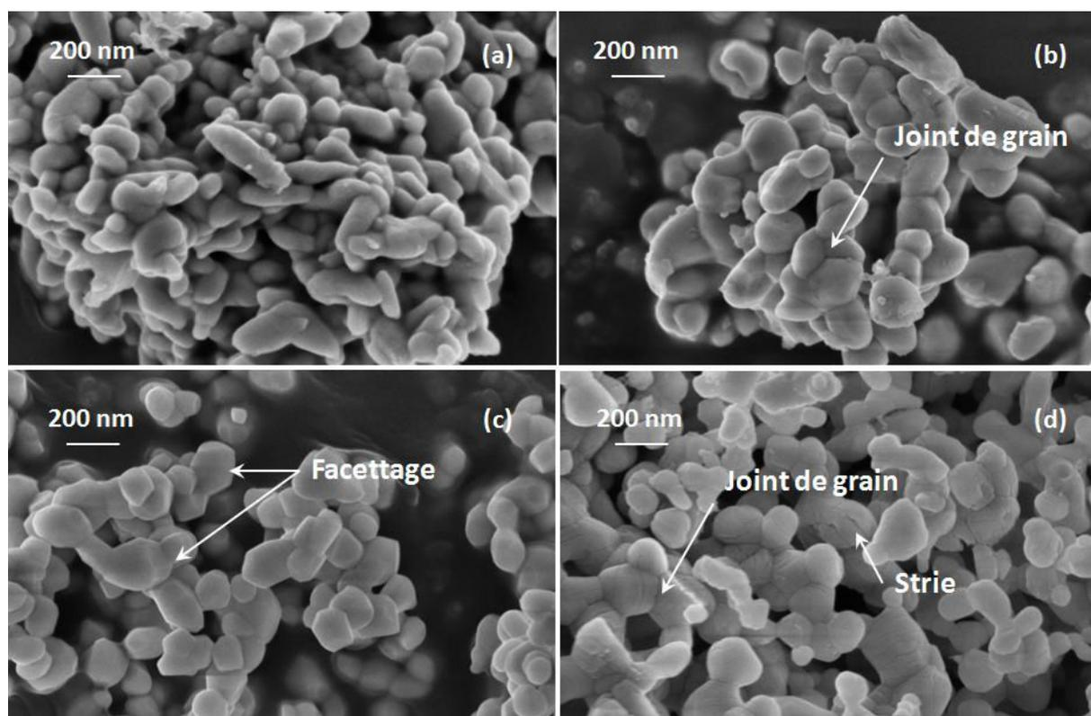
Figure 3. 5 : Images MEB réalisées sur l'échantillon LFP-P après délithiation (a) avec du  $\text{Br}_2$  dans l'acétonitrile en 24 h (LFP-P-D1), (b) en 96 h (LFP-P-D3), (c) avec du  $\text{NO}_2\text{BF}_4$  (LFP-P-D6), (d) avec du  $\text{Br}_2$  en large excès dans le chloroforme (LFP-P-D5).
