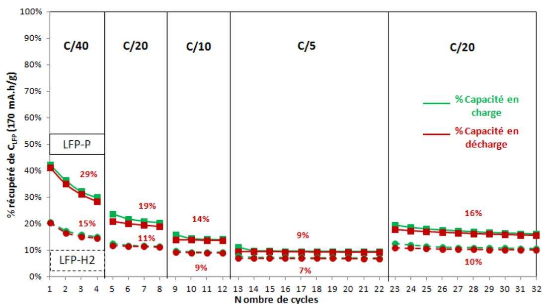
Figure 5. 4 : Evolution de la capacité massique des échantillons LFP-P (trait plein) et LFP-H2 (trait pointillé) exprimée en pourcentage de la capacité théorique de  $\text{LiFePO}_4$  en fonction du nombre de cycles et du régime.
