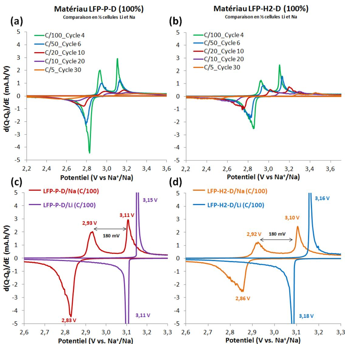
Figure 5. 15 : Courbes  $dQ/dE$  de la capacité en fonction du potentiel pour (a) LFP-P-D (100% délithié chimiquement) et pour (b) LFP-H2-D (100% délithié chimiquement) cyclés en demi-cellules sodium à différents régimes. Comparaison du 2ème cycle obtenu à C/100 en demi-cellules Na et Li pour les échantillons (c) LFP-P-D et (d) LFP-H2-P.
