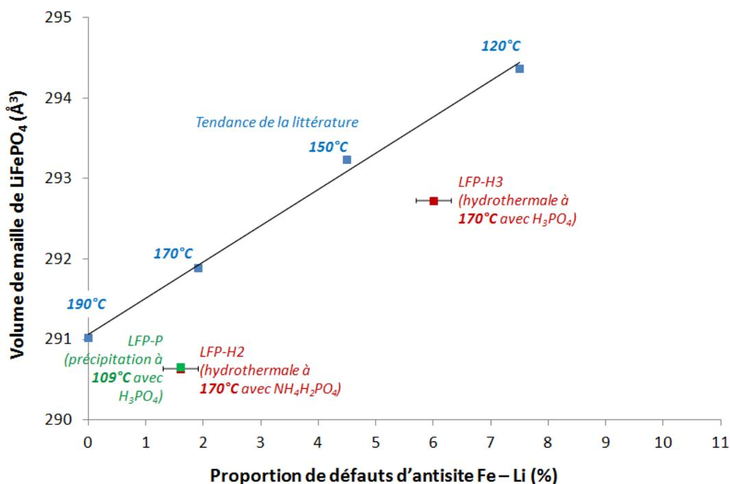
Figure 2. 12 : Evolution du volume de maille de  $\text{LiFePO}_4$  en fonction de la proportion d'atomes de fer en site de lithium, illustrant la proportionnalité entre ces deux grandeurs. En bleu, les valeurs issues des travaux de Chen et al. [10] et de Yang et al. [15]. En rouge, les valeurs expérimentales obtenues sur les échantillons LFP-H2 et LFP-H3 (hydrothermale). En vert, la valeur expérimentale obtenue sur l'échantillon LFP-P (précipitation directe).
