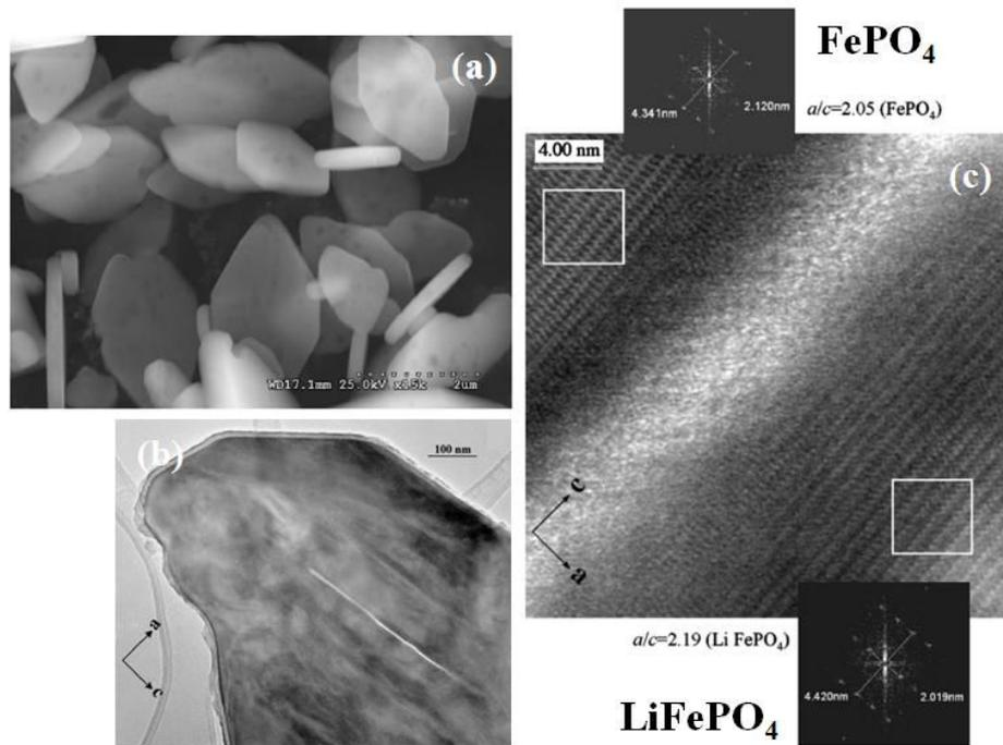
Figure 4. 22 : (a) Image MEB montrant des plaquettes de  $\text{LiFePO}_4$ . (b) Image TEM montrant une *dislocation au sein d'une cristallite séparant les phases  $\text{FePO}_4$  et  $\text{LiFePO}_4$* . (c) Image HRTEM et transformée de Fourier réalisées sur les phases  $\text{FePO}_4$  et  $\text{LiFePO}_4$ , où l'*interphase serait un domaine de solution solide* [6].
