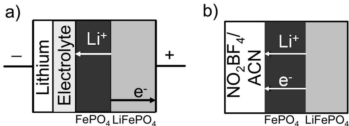
Figure 1. 12 : Illustration de la délithiation électrochimique (a) où les ions  $\text{Li}^+$  sont acheminés par l'électrolyte, de manière séparée des électrons provenant du collecteur de courant ; et de la délithiation chimique (b) où ces deux porteurs de charge ne sont pas séparés [60].
