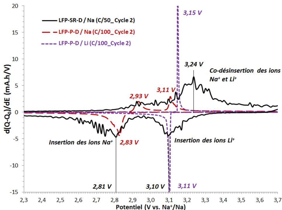
Figure 6. 13 : Courbes  $dQ/dE$  en fonction du potentiel pour l' échantillon LFP-SR-D cyclé en demi-cellule sodium au cours des caractérisations structurales in situ (courbe noire) et pour l'échantillon LFP-P cyclé en demi-cellules lithium (courbe violette) et sodium (courbe rouge).
