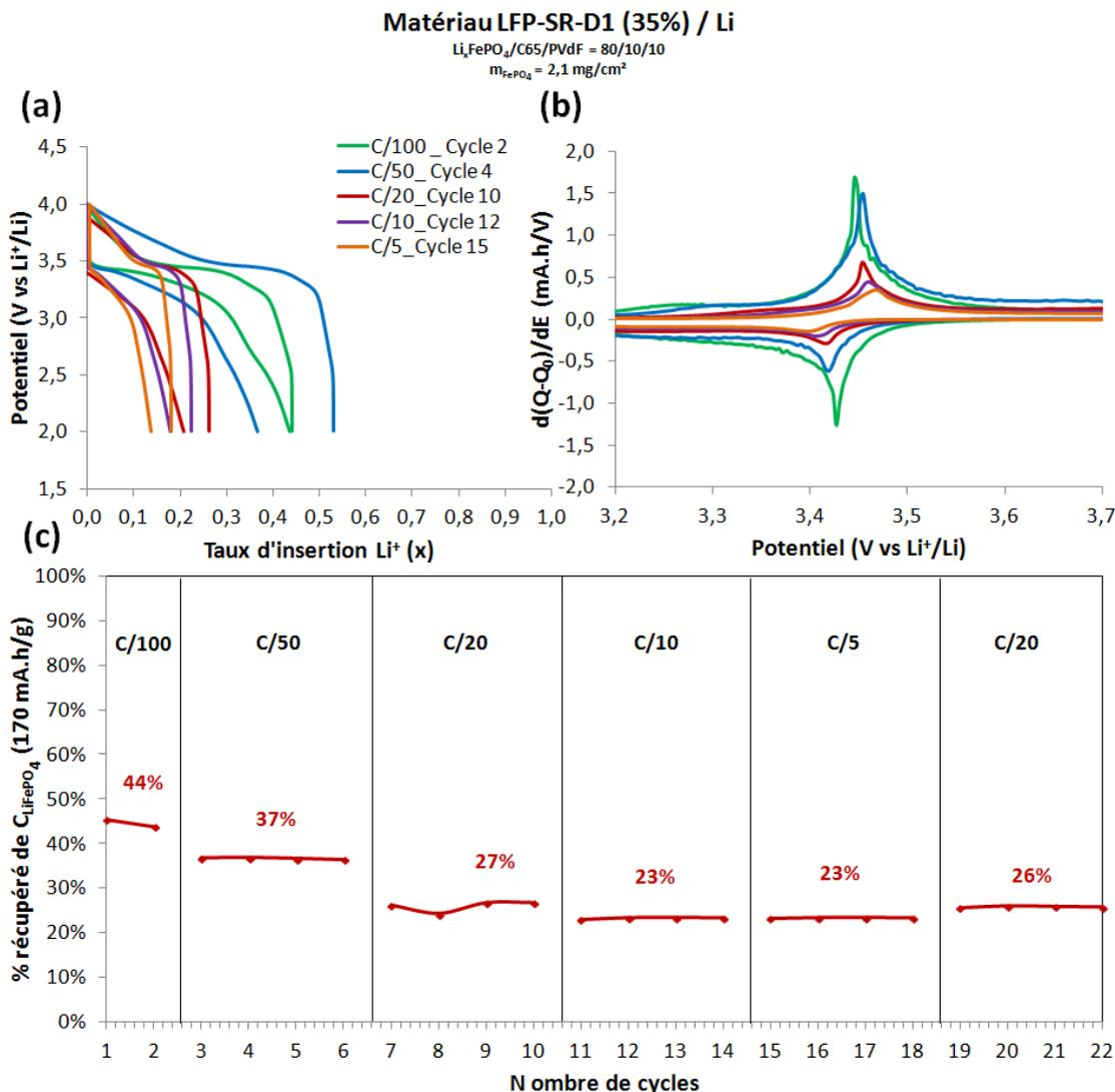
Figure 6.8 : (a) Courbes galvanostatiques de l'échantillon LFP-SR-D1 en demi-cellule lithium, (b) courbes  $dQ/dE$  en fonction du potentiel et (c) évolution du pourcentage de capacité récupéré en fonction du nombre de cycles et du régime de décharge.
