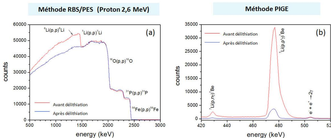
Figure 3. 8 : Spectres d'énergie issus des techniques combinées RBS et PIGE. Identification du lithium (a) par émission des protons rétrodiffusés vers 1600 keV pour la méthode RBS, (b) et par émission des rayons  $\gamma$  vers 470 keV pour la méthode PIGE, pour un échantillon non délithié (courbe rouge) et après délithiation (courbe bleue).
