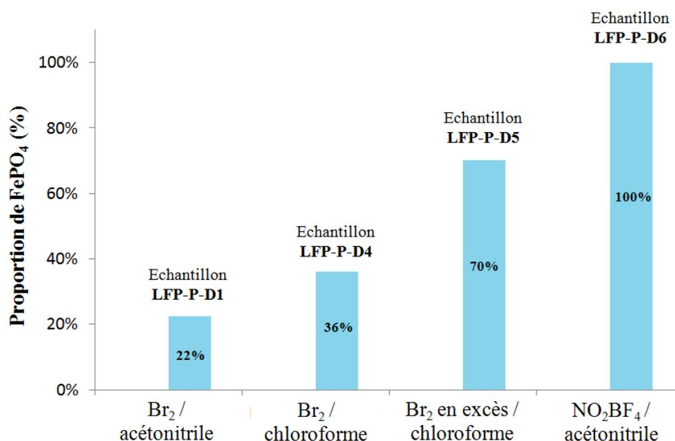
Figure 3. 11 : Evolution des proportions de la phase délithiée  $\text{FePO}_4$  obtenue par méthode Rietveld en fonction des conditions de délithiation en 24 h sur l'échantillon LFP-P.
