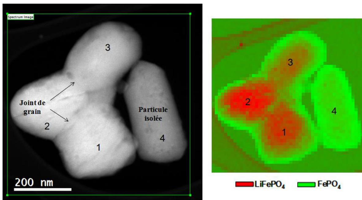
Figure 4. 17 : Clichés STEM et cartographie réalisée par EELS montrant la répartition des phases  $\text{FePO}_4$  et  $\text{LiFePO}_4$  au sein des particules de l'échantillon LFP-P pour trois particules partiellement délithiées et liées entre elles au niveau des joints de grains, et une particule indépendante totalement délithiée.
