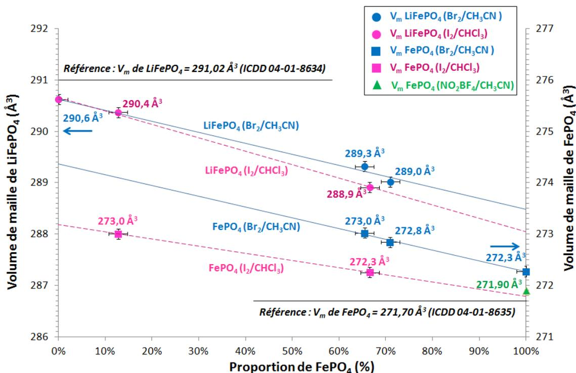
Figure 4. 7 : Evolution du volume de maille des phases  $\text{FePO}_4$  et  $\text{LiFePO}_4$  en fonction du tau de conversion de l'échantillon LFP-H2 pour une délithiation effectuée avec du dibrome dans l'acétonitrile (trait plein bleu) ou effectuée avec du diiode dans le chloroforme (trait pointillé rose).
