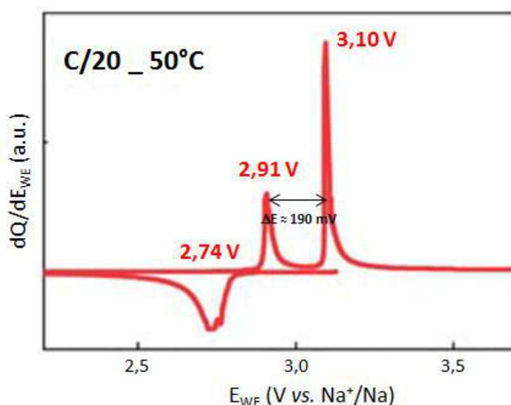
Figure 1. 26 : Courbe dérivée de la capacité en fonction du potentiel à  $C/20$  à  $50^\circ\text{C}$  issue des travaux de Casas-Cabanas et al. [116] montrant deux pics d'oxydation en charge et un pic de réduction en décharge avec les valeurs de potentiel correspondantes.
