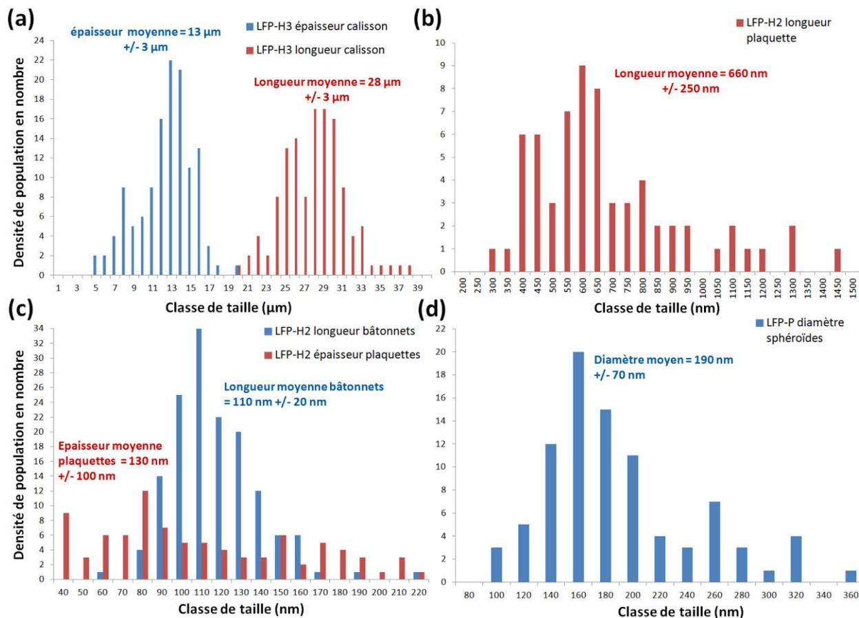
Figure 2. 5 : Distributions de taille des particules mesurées à partir des clichés MEB pour : (a) la population des particules type "calissons" de l'échantillon LFP-H3, (b) et (c) la population des plaquettes et des "bâtonnets" de l'échantillon LFP-H2, (d) la population de sphéroïdes de l'échantillon LFP-P.
