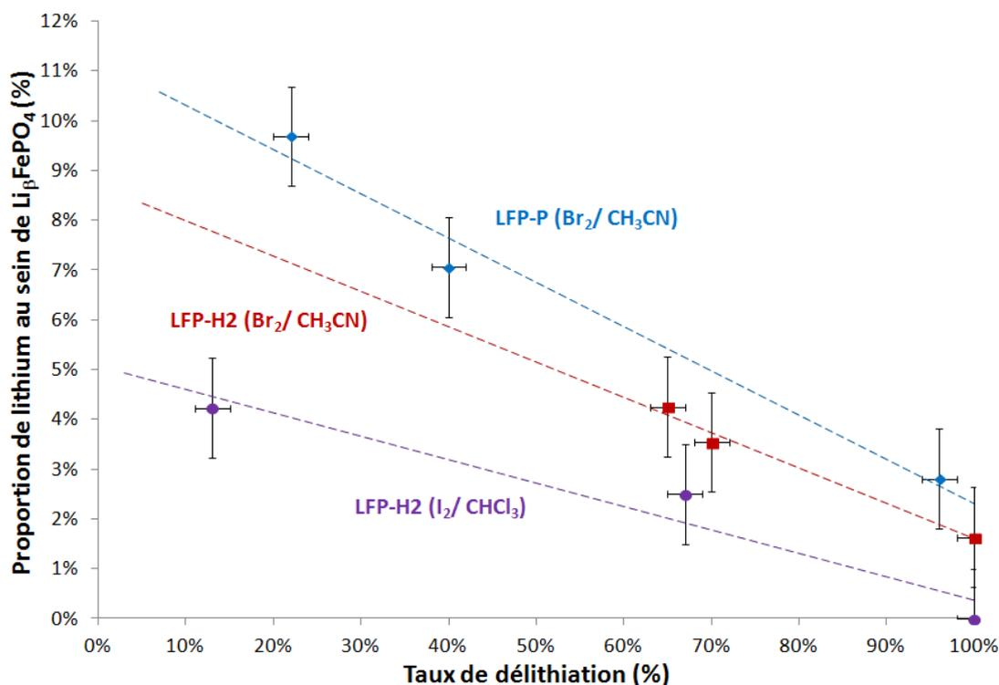
Figure 4. 9 : Evolution de la proportion de solution solide présente au sein de la phase  $\text{FePO}_4$  déterminée par la loi de Végard en fonction du taux de délithiation pour différents échantillons.
