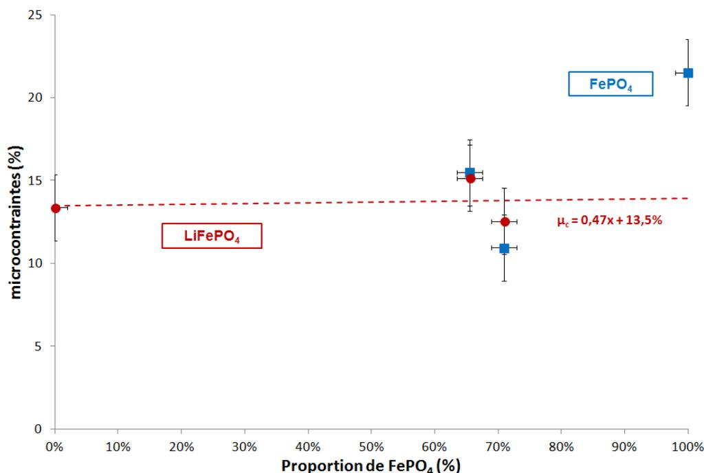
Figure 4. 20 : Evolution des microcontraintes des phases  $\text{LiFePO}_4$  (rouge) et  $\text{FePO}_4$  (bleu) en fonction du taux de conversion pour l'échantillon LFP-H2 délithié chimiquement avec du  $\text{Br}_2$  dans l'acétonitrile.
