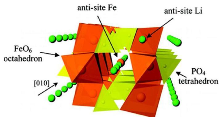
Figure 1. 4 : Schéma d'un défaut antisite Li/Fe bloquant un tunnel cationique de la structure olivine [10,23]
