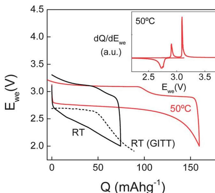
Figure 5. 16 : Travaux de Casas-Cabanas et al. [7] représentant les courbes galvanostatiques du premier cycle d'insertion des ions  $\text{Na}^+$ , pour différentes conditions de cyclage, au sein d'un matériau industriel  $\text{LiFePO}_4$  enrobé de carbone puis délithié chimiquement. En cartouche, la courbe dérivée du premier cycle effectué à 50°C (rouge).
