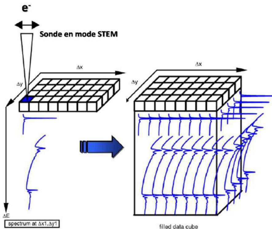
Figure A. 1 : Schéma d'un "data cube" ( $X, Y, \Delta E$ ) où ( $X, Y$ ) représentent les coordonnées spatiales et  $\Delta E$  les pertes d'énergies Le schéma de gauche illustre la première composante du data cube.
