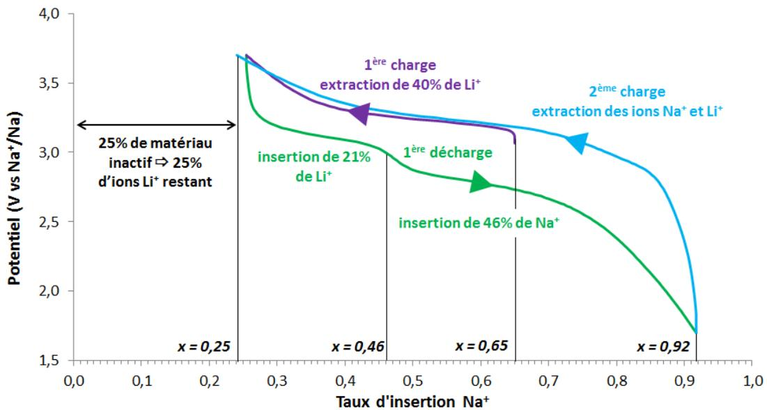
Figure 6. 11 : Courbe galvanostatique de l'échantillon LFP-SR-D1 en demi-cellule sodium utilisée lors de la caractérisation structurale par DRX in situ.
