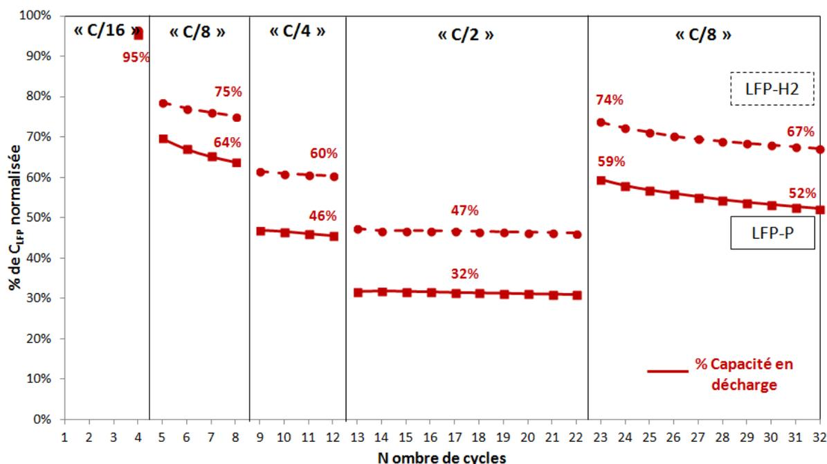
Figure 5. 5 : Evolution du pourcentage de capacité massique normalisée par rapport au 4<sup>ème</sup> cycle pour les échantillons LFP-P (traits pleins) et LFP-H2 (trait pointillés) en fonction du nombre de cycles et du régime.
