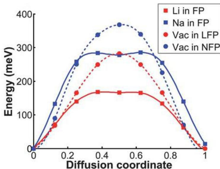
Figure 1.27 : Barrières d'énergies de diffusion des lacunes et des ions  $\text{Li}^+/\text{Na}^+$  au sein de la structure olivine  $\text{FePO}_4$  calculées à l'aide du logiciel de simulation ab initio Vienna (VASP) et de la méthode "Nudge Elastic Band" (NEB) [111].
