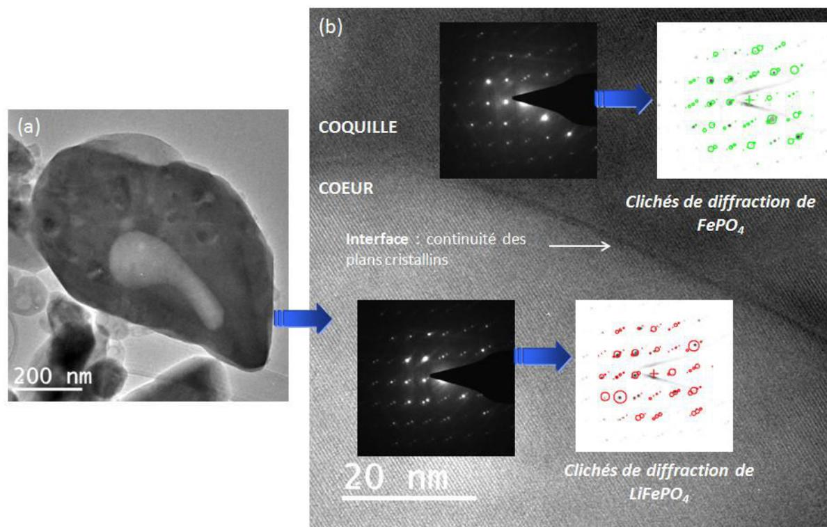
Figure 4. 21 : (a) Cliché TEM d'une particule plaquettaire partiellement délithiée. (b) Clichés de diffraction électronique des phases  $\text{LiFePO}_4$  (cœur) et  $\text{FePO}_4$  (coquille) et visualisation de l'interface.
