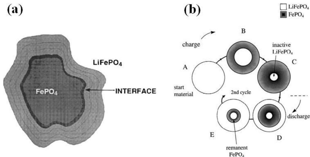
Figure 1. 6 : Représentation du mécanisme de (dé)lithiation illustré par (a) Padhi et al. [1] et par (b) Andersson et al. [49].
