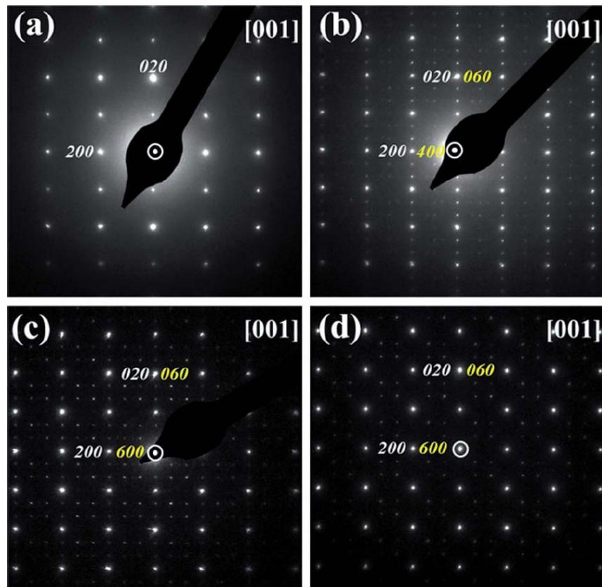
Figure 1. 32 : Clichés de diffraction (a) de la phase  $\text{FePO}_4$  et (b-d) de la phase  $\text{Na}_{2/3}\text{FePO}_4$  dans le plan (110) extraits des travaux de Casas-Cabans et al. [116]. Observation des sur-structures (b)  $2a3bc$  et (c-d)  $3a3bc$  où a, b et c sont les paramètres de la maille élémentaire.
