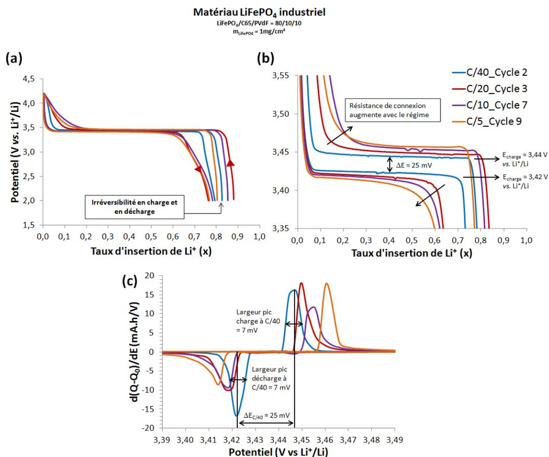
Figure 5. 1 : Caractérisations électrochimiques en cyclage galvanostatique du matériau industriel  $\text{LiFePO}_4$ . (a) Potentiel en fonction du taux d'insertion de  $\text{Li}^+$ , (b) zoom sur l'hystérésis des plateaux de charge/décharge, (c) courbes  $dQ/dE$  en fonction du potentiel.
