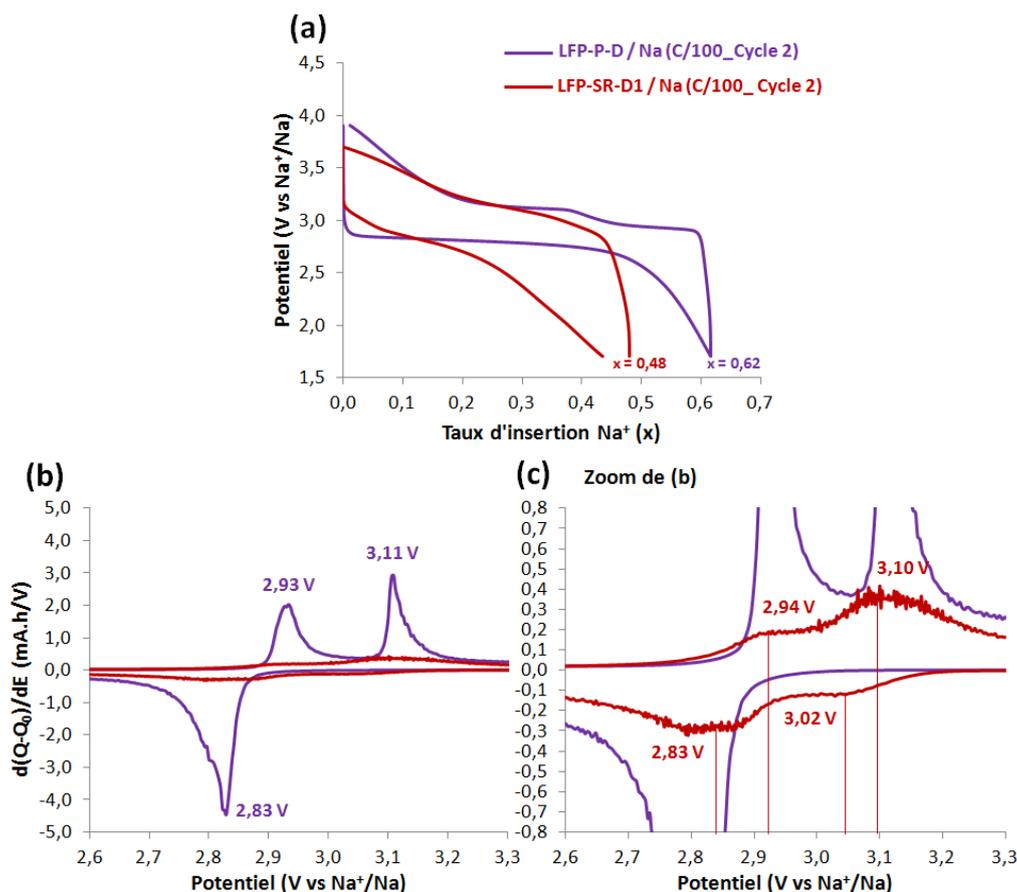
Figure 6. 9: Comparaison (a) des courbes galvanostatiques en demi-cellule sodium et (b) des courbes  $dQ/dE$  en fonction du potentiel réalisées à C/100 entre les matériaux LFP-P-D (recuit) et LFP-SR-D1 (non recuit). (c) Zoom des courbes  $dQ/dE$ .
