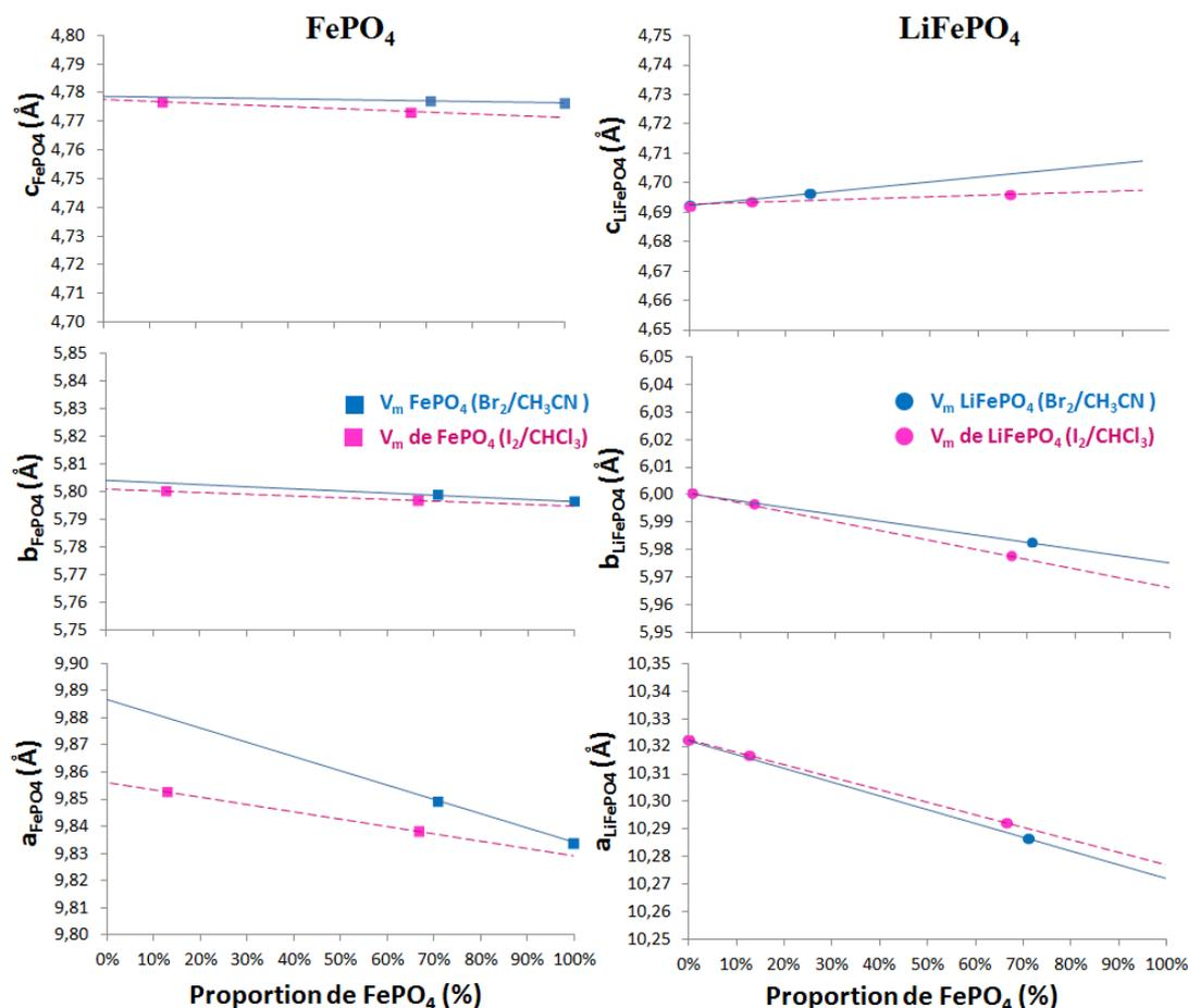
Figure 4. 8 : Evolution des paramètres de maille **a**, **b** et **c** des phases  $\text{FePO}_4$  et  $\text{LiFePO}_4$  en fonction de la proportion de phase  $\text{FePO}_4$  pour l'échantillon LFP-H2.
