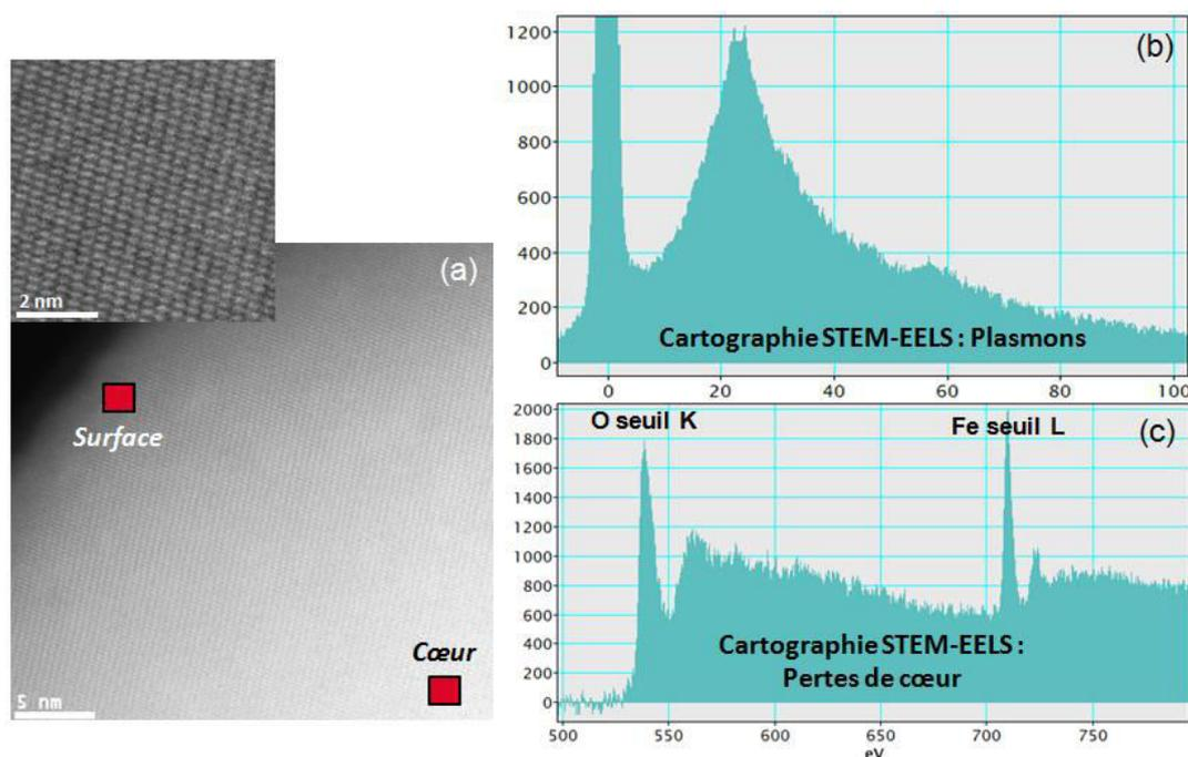
Figure 2. 14 : Clichés HR-STEM et EELS affichant (a) les plans cristallins au sein d'une particule de l'échantillon LFP-P, (b) les cartographies des *plasmons* et (c) des *pertes de cœur* donnant une information sur la composition de l'échantillon.
