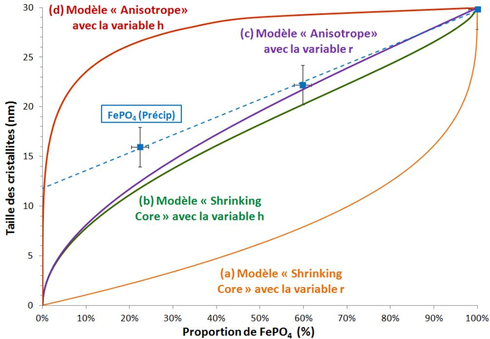
Figure 4. 14 : Evolution du rayon des cristallites de la phase en croissance FePO<sub>4</sub> en fonction du taux de conversion suivant le modèle "Shrinking Core" en assimilant le rayon d'une cristallite (a) à l'épaisseur r de la coquille ou (b) au diamètre h de la calotte inscrite dans la coquille ; ou suivant le modèle "Anisotrope" en assimilant le rayon d'une cristallite (c) à r ou (d) à h.
