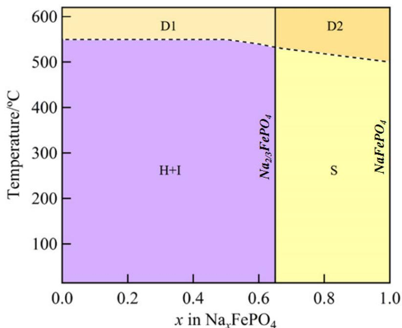
Figure 1. 21 : Diagramme de phase de  $\text{Na}_x\text{FePO}_4$  de structure olivine reporté expérimentalement par Lu et al. [120]. H représente la phase Hétérosite  $\text{FePO}_4$ , I représente la phase Intermédiaire  $\text{Na}_{2/3}\text{FePO}_4$  et S représente la Solution solide  $\text{Na}_x\text{FePO}_4$  existant pour  $2/3 < x < 1$ . D1 et D2 correspondent aux produits issus de la Décomposition de  $\text{Na}_x\text{FePO}_4$  porté à plus de 500°C.
