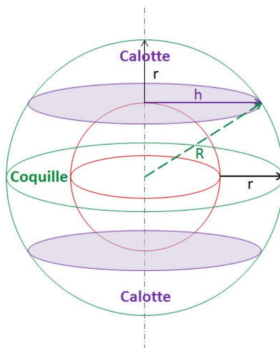
Figure 4. 13 : Représentation schématique d'une particule sphérique biphasée (phase externe verte et phase interne rouge) illustrant le modèle de croissance "Shrinking Core".  $R$  représente le rayon de la particule,  $r$  le rayon de la "coquille" ( $0 \leq r \leq R$ ) et  $h$  le rayon des deux "calottes" ( $0 \leq h \leq R$ ).
