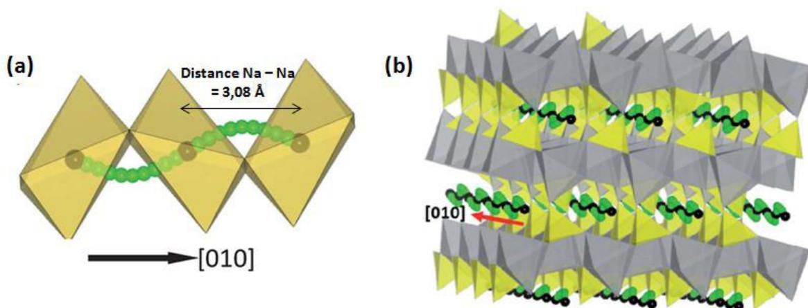
Figure 1. 28 : Diffusion des ions  $\text{Na}^+$  selon l'axe b dans la structure olivine  $\text{FePO}_4$  : (a) représentation de la trajectoire courbe et de la distance Na–Na selon l'axe [010] ; et (b) à l'échelle de plusieurs mailles élémentaires. Les sphères noires représentent les atomes de sodium et les sphères vertes représentent le chemin de diffusion le plus favorable [110].
