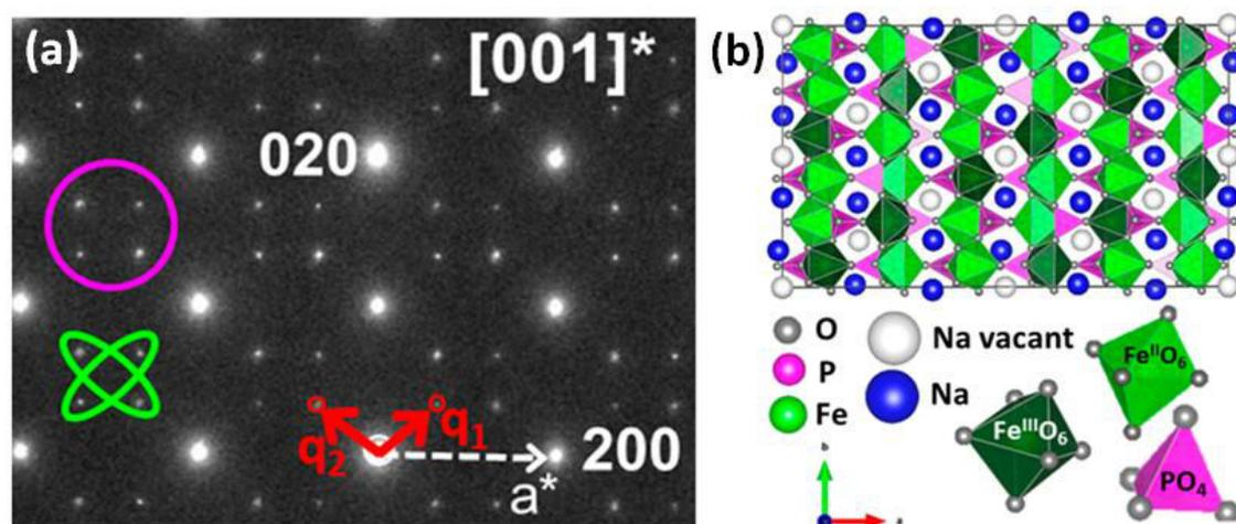
Figure 1. 33 : Travaux de Galceran et al. [123] sur la structure de la phase intermédiaire  $\text{Na}_{2/3}\text{FePO}_4$ . (a) Mise en évidence de la structure 3a3bc et des vecteurs d'onde  $\mathbf{q}_1$  et  $\mathbf{q}_2$  par le cliché de diffraction électronique dans le plan (110). (b) Schéma de la structure cristallographique modélisée à partir des liaisons de valence (BVS), incluant les lacunes de sodium et les ions Fe II et Fe III.
