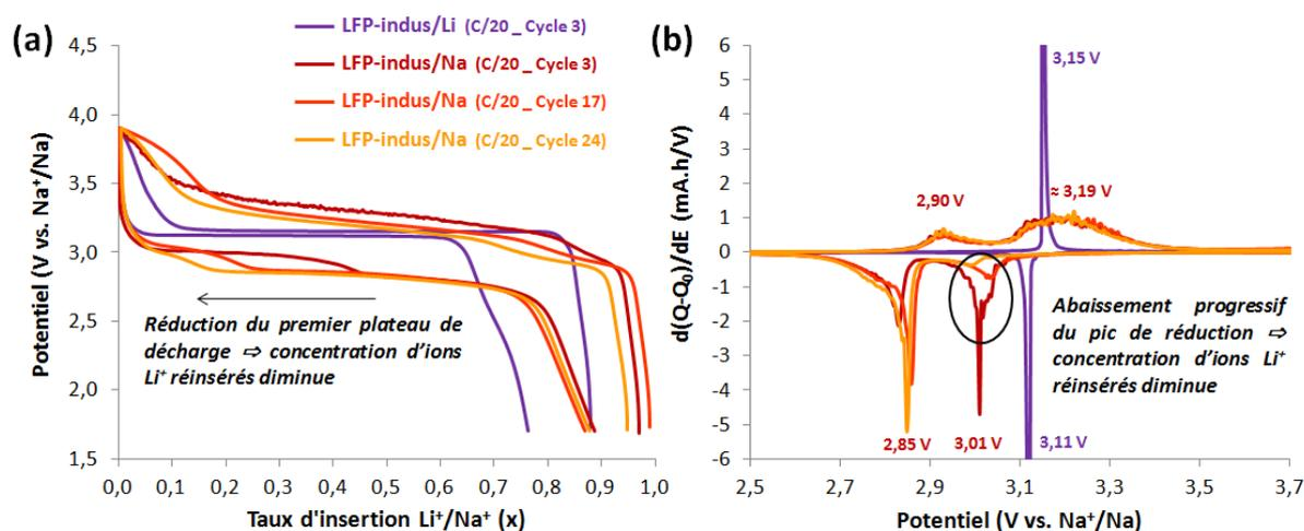
Figure 5. 21 : Evolution (a) des courbes galvanostatiques et (b) des courbes  $dQ/dE$  pour le 3<sup>ème</sup>, 17<sup>ème</sup> et 24<sup>ème</sup> cycle à un régime de C/20.
