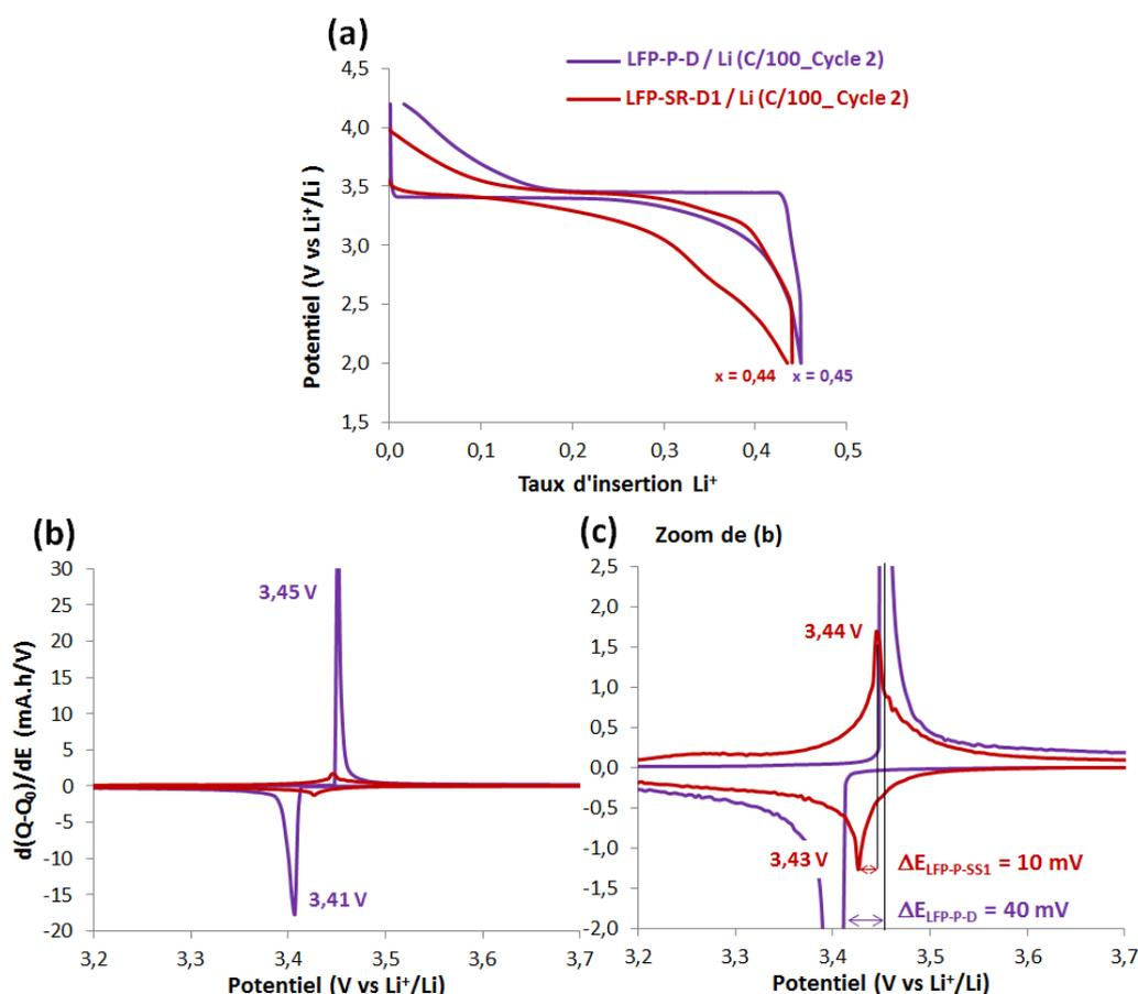
Figure 6. 7: Comparaison (a) des courbes galvanostatiques en demi-cellule lithium et (b) des courbes  $dQ/dE$  de la capacité en fonction du potentiel réalisées à C/100 entre les matériaux LFP-P-D (recuit à 600°C) et LFP-SR-D1 (non recuit). (c) Zoom de (b).
