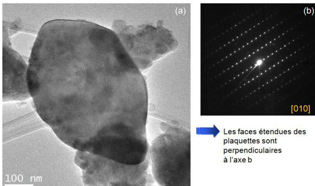
Figure 2. 13 : (a) Cliché STEM d'une particule plaquettaire provenant de l'échantillon LFP-H2 et (b) cliché de diffraction électronique réalisé à la surface de la plaquette perpendiculairement à l'axe  $[010]$ .
