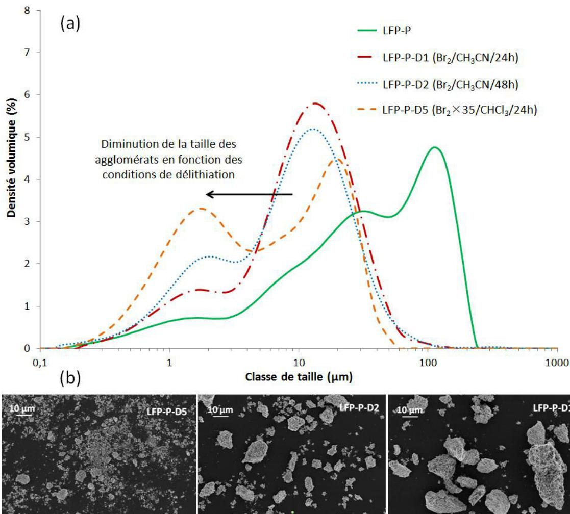
Figure 3. 6 : (a) Distribution granulométrique en volumes des échantillons LFP-P avant délithiation, LFP-P-D1 délithié avec du  $\text{Br}_2$  dans l'acétonitrile en 24 h, LFP-P-D2 délithié en 48 h, et LFP-P-D5 délithié avec un excès de dibrome dans le chloroforme. (b) Images MEB correspondantes : de gauche à droite : échantillons LFP-P-D5, LFP-P-D2 et LFP-P-D1.
