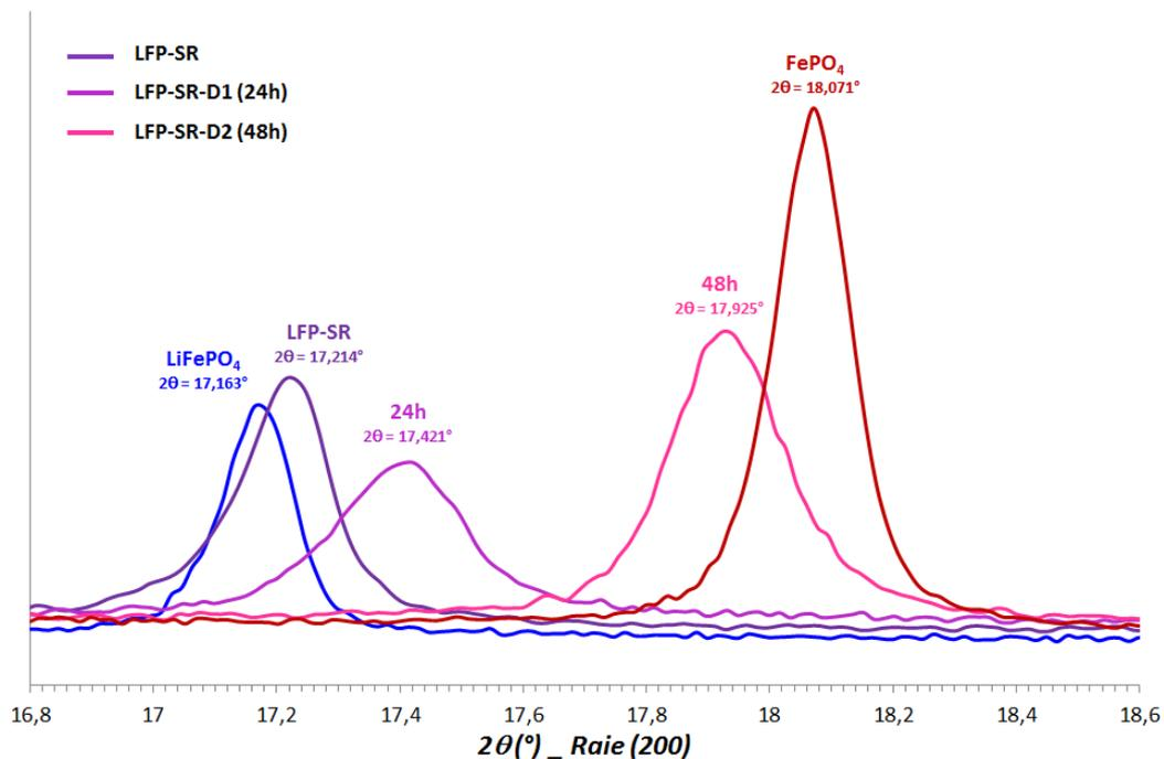
Figure 6. 3 : Pics de diffraction correspondants à la raie (200) des phases  $\text{LiFePO}_4$  et  $\text{FePO}_4$  pour les échantillons délithiés en 24 h (LFP-SR-D1) et en 48 h (LFP-SR-D2) issu de l'échantillon LFP-SR.
