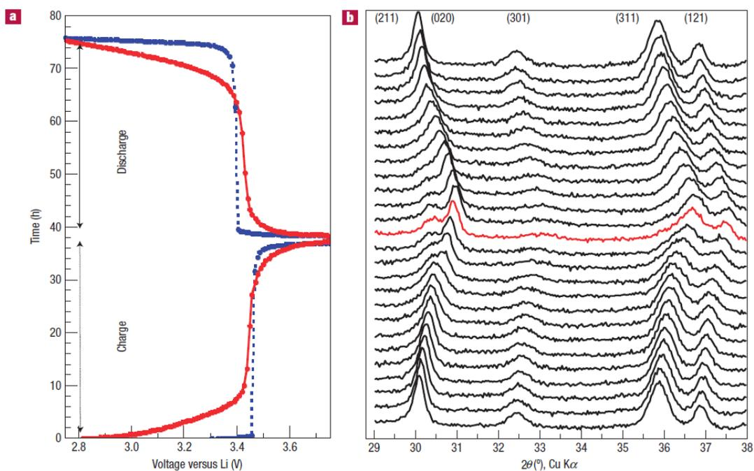
Figure 1. 16 : (a) Caractérisations électrochimiques comparant la transition de la phase  $\text{LiFePO}_4$  à la phase  $\text{FePO}_4$  via une solution solide  $\text{Li}_x\text{FePO}_4$  (courbe rouge) et via un système biphasé (courbe bleue) durant un cycle décharge/décharge à C/40. (b) Diffraction des rayons X in situ mettant en évidence le décalage des pics de diffraction correspondant à une transition de phase via une solution solide [87].
