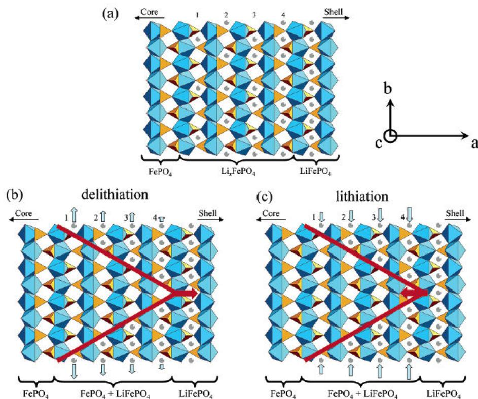
Figure 1. 10 : Mécanismes présentés par Laffont et al. [53] : (a) Désordre hypothétique de composition  $\text{Li}_x\text{FePO}_4$  à l'interphase qui n'a pas été observé par les mesures de HREELS. Evolution du front de phase observé par HREELS : (b) durant la délithiation et (c) durant la lithiation, montrant une juxtaposition des deux phases  $\text{LiFePO}_4$  et  $\text{FePO}_4$ .
