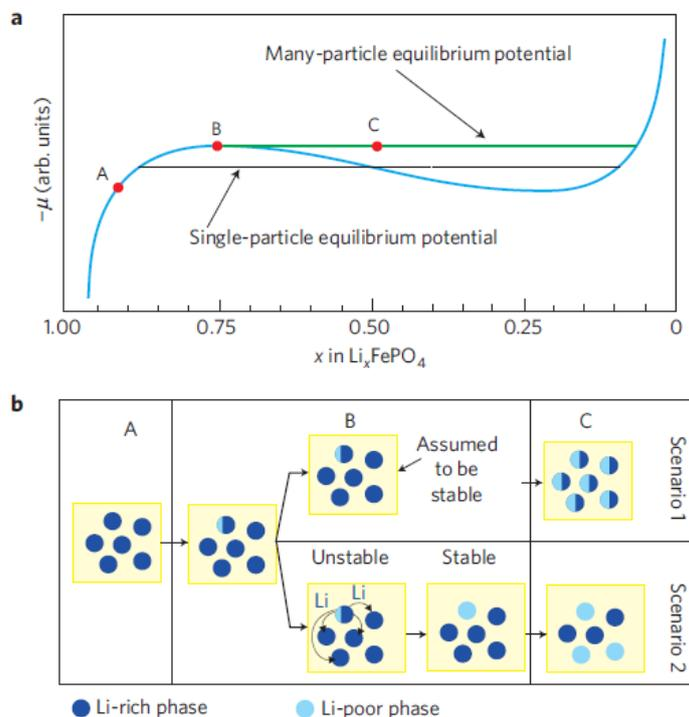
Figure 1. 14 : (a) Potentiel chimique du système  $\text{Li}_x\text{FePO}_4$  en fonction de  $x$  (proportion de Li) dans le cas d'une seule particule et dans le cas d'une population de particules. (b) Représentation des deux scénarios possibles lors de la formation de la phase  $\text{FePO}_4$  dans un système "multiples particules" (typiquement au sein d'une électrode composite).
