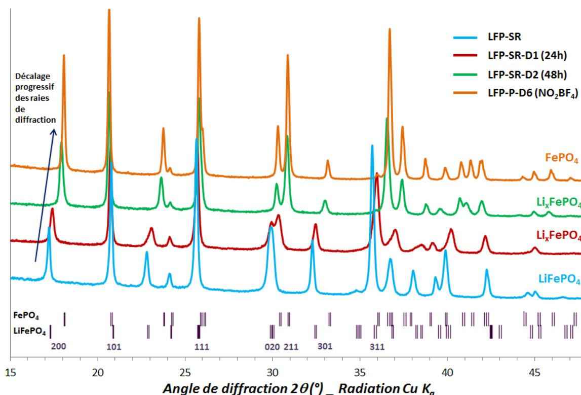
Figure 6. 2 : Diffractogrammes des phases intermédiaires  $\text{Li}_x\text{FePO}_4$  lors de la délithiation chimique de l'échantillon LFP-SR, synthétisé par précipitation et non recuit. L'échantillon LFP-P-D6, issu de l'échantillon LFP-P et complètement délithié, sert de référence.
