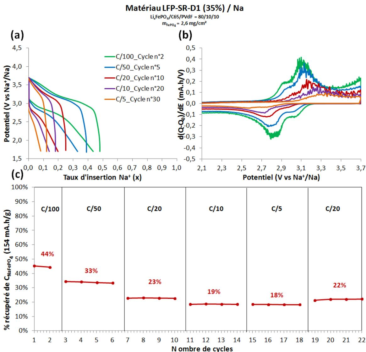
Figure 6.10 : (a) Courbes galvanostatiques de l'échantillon LFP-SR-D1 non recuit et délithié à 35% en demi-cellule sodium, (b) courbes  $dQ/dE$  en fonction du potentiel et (c) évolution du pourcentage de capacité récupéré en fonction du nombre de cycles et du régime de décharge.
