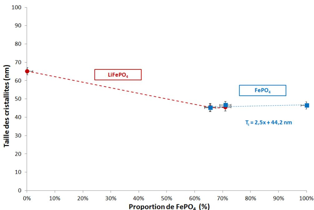
Figure 4. 19 : Evolution de la taille des cristallites des phases  $\text{LiFePO}_4$  (rouge) et  $\text{FePO}_4$  (bleu) avec la proportion de  $\text{FePO}_4$  obtenue durant la délithiation chimique de l'échantillon LFP-H2 avec du  $\text{Br}_2$  dans l'acétonitrile.
