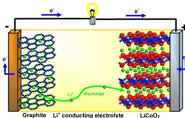
Figure 2 : Schéma de fonctionnement d'une batterie Li-ion où l'électrode positive est constituée du matériau d'insertion  $\text{LiCoO}_2$  et l'électrode négative est constituée de carbone graphite [7].
