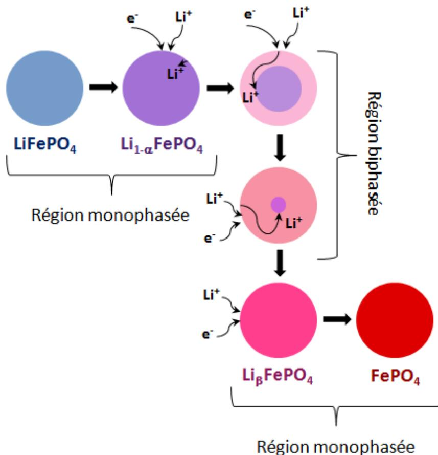
Figure 4. 10 : Schéma illustrant le mécanisme de délithiation de  $\text{LiFePO}_4$  et mettant en jeu des domaines de solution solide. D'après le modèle "Shrinking Core" développé par Srinivasan et al. [3].
