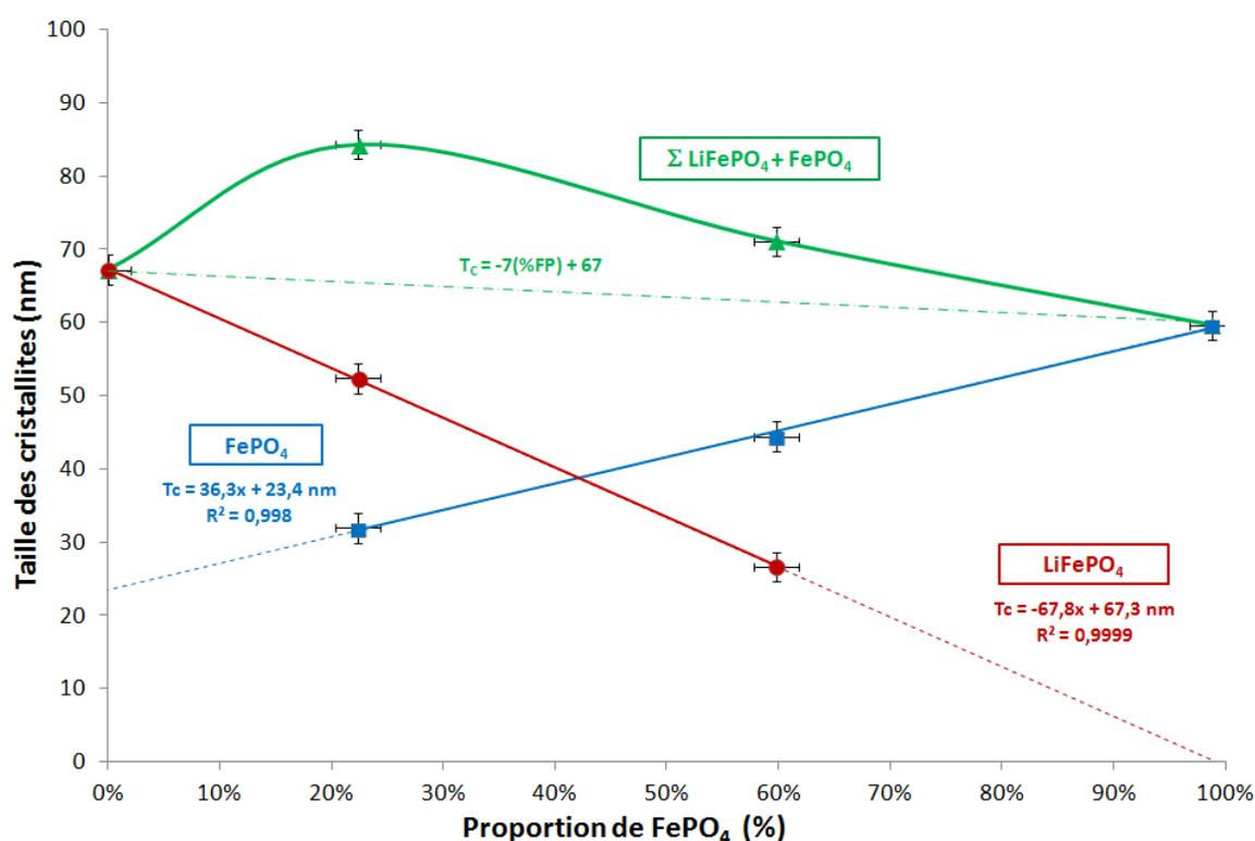
Figure 4. 11 : Evolution de la taille des cristallites des phases LiFePO<sub>4</sub> (rouge) et FePO<sub>4</sub> (bleu) avec la proportion de FePO<sub>4</sub> après délithiation chimique de l'échantillon LFP-P avec du dibrome dans l'acétonitrile. La courbe verte en trait plein représente la somme des tailles de cristallites des deux phases. La droite verte en traits pointillés relie la taille des cristallites de la phase LiFePO<sub>4</sub> pure à celle de la phase FePO<sub>4</sub> pure.
