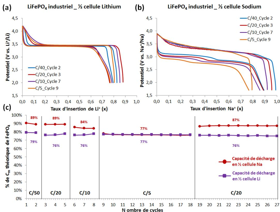
Figure 5. 22 : Courbes galvanostatique du matériau  $\text{LiFePO}_4$  industriel cyclé (a) en demi-cellule lithium et (b) en demi-cellule sodium. (c) Pourcentage de capacité récupérée pour l'échantillon industriel testé en demi-cellules sodium (rouge) et lithium (violet) à différents régimes de décharge.
