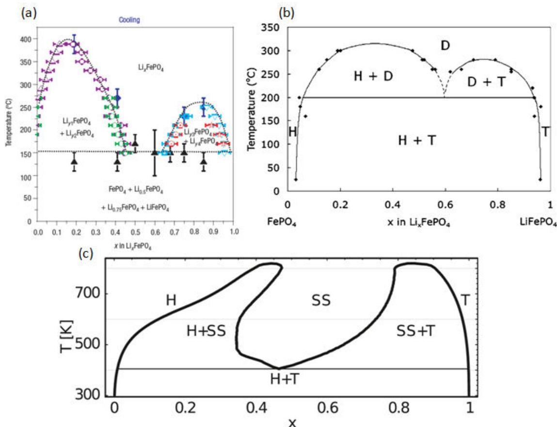
Figure 1. 15 : Diagramme de phases du système  $\text{Li}_x\text{FePO}_4$  ( $0 \leq x \leq 1$ ) déterminé au cours du refroidissement par (a) diffraction des rayons X en température [79], (b) diffraction des rayons X [80] et (c) modélisation thermodynamique ab initio [81]. T signifie "Triphylite", H signifie "Hétérosite" et D ou SS signifient "Désordre" ou "Solution Solide"
