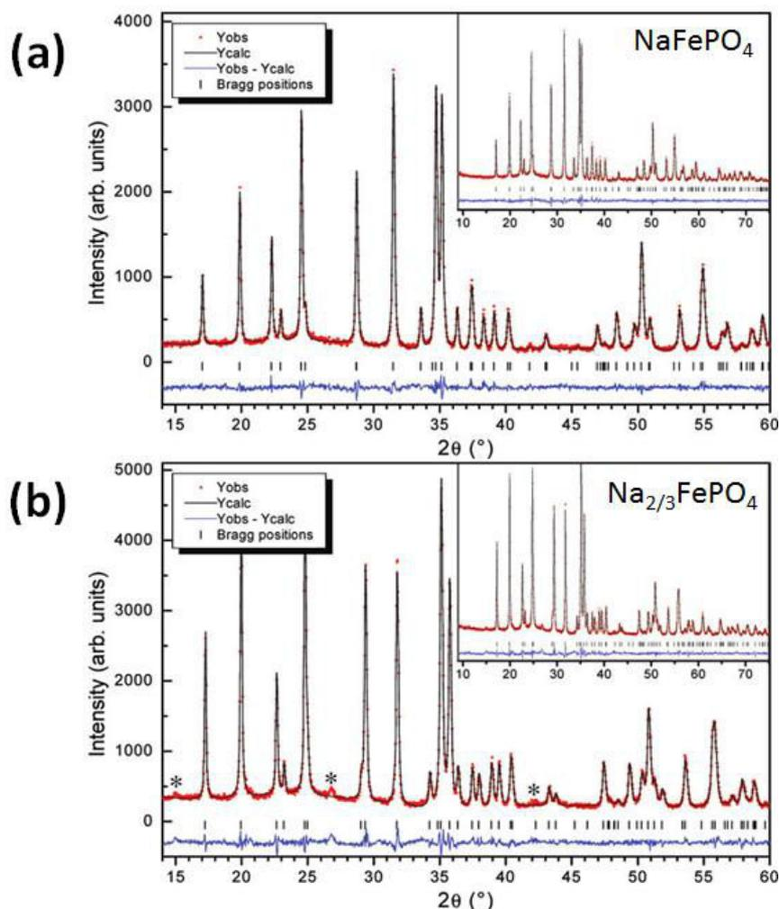
Figure 1. 25 : Diffractogrammes des phases olivines (a)  $\text{NaFePO}_4$  et (b)  $\text{Na}_{2/3}\text{FePO}_4$  obtenues par Moreau et al. [112] au cours de l'insertion électrochimique des ions sodium.
