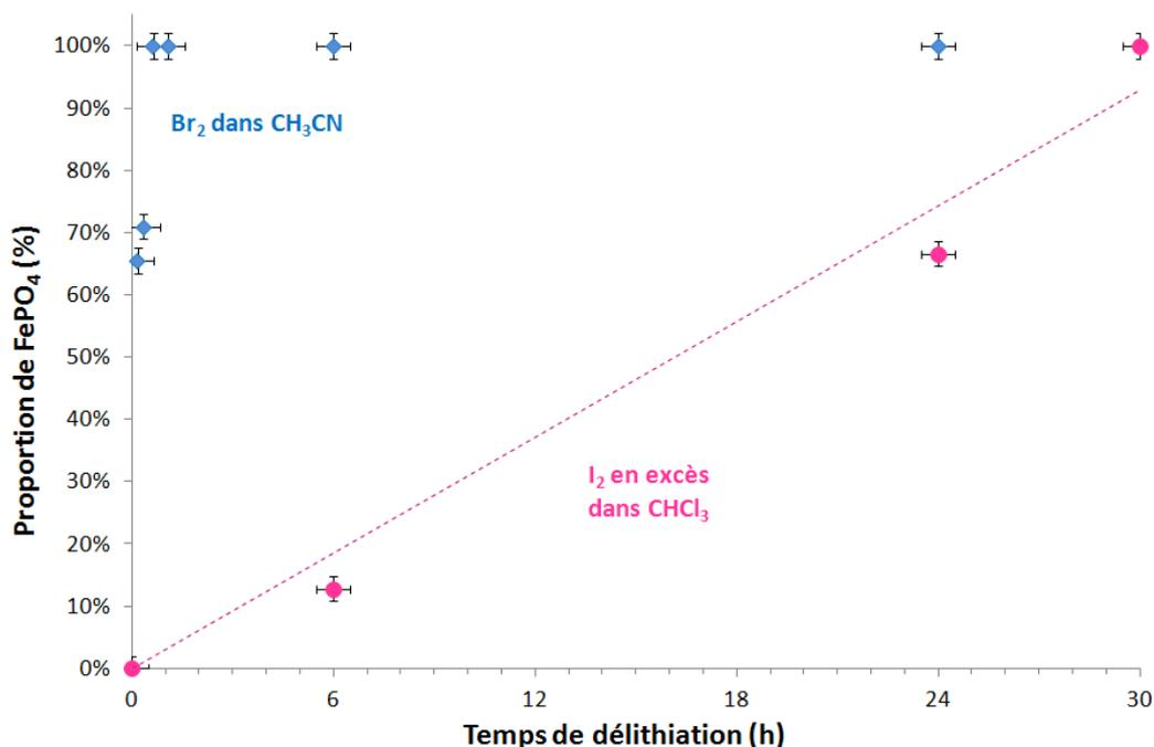
Figure 3. 13 : Proportion de  $\text{FePO}_4$  en fonction du temps pour la délithiation chimique de l'échantillon LFP-H2 avec du dibrome dans l'acétonitrile (bleu) ou du diiode en excès dans le chloroforme (rose).
