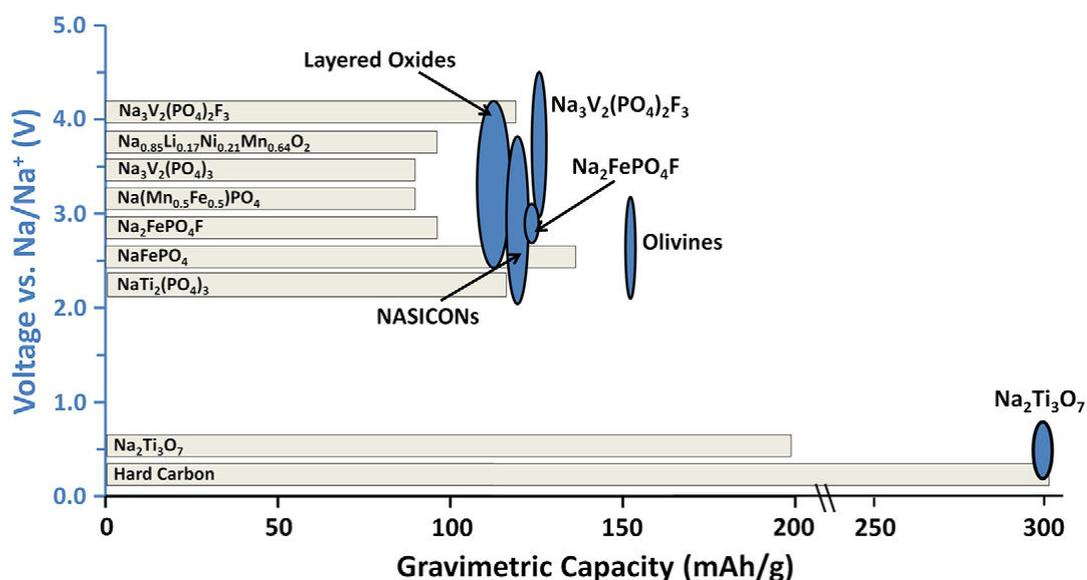
Figure 3 : Diagramme représentant le potentiel de fonctionnement et la capacité massique théorique de différents matériaux d'insertion pour les électrodes positives ( $E > 2V$  vs.  $\text{Na}/\text{Na}^+$ ) et pour les électrodes négatives ( $E < 1V$  vs.  $\text{Na}/\text{Na}^+$ ) [26].
