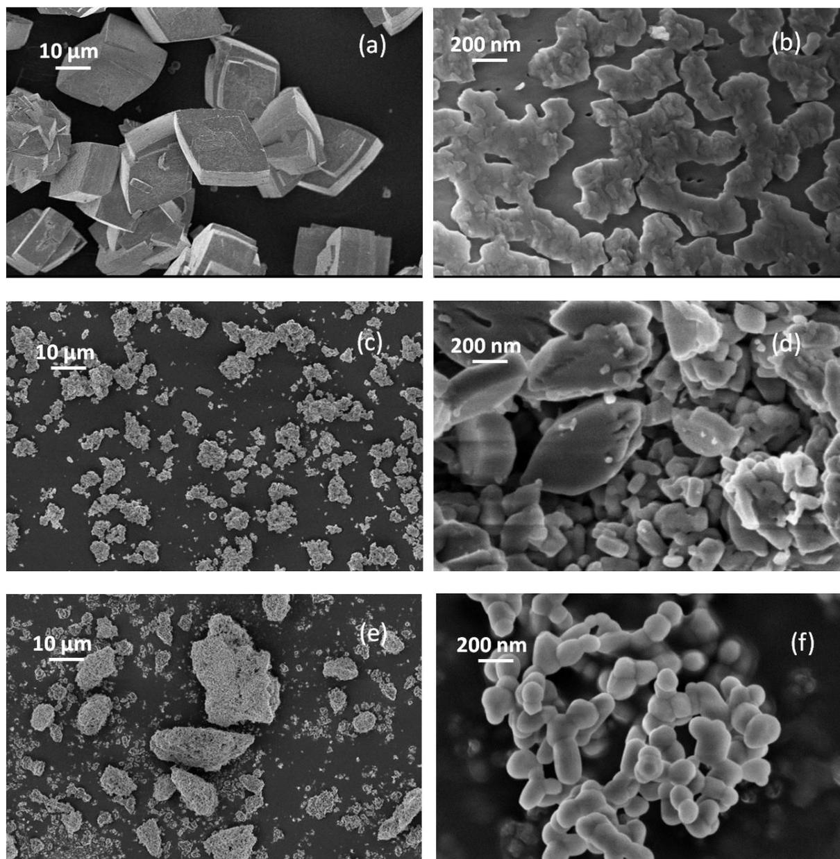
Figure 2. 4 : Images MEB réalisées à différents grossissements sur les échantillons : (a) et (b) LFP-H3 synthétisé par méthode hydrothermale avec  $\text{H}_3\text{PO}_4$  ; (c) et (d) LFP-H2 synthétisé par méthode hydrothermale avec  $\text{NH}_4\text{H}_2\text{PO}_4$  ; et (e) et (f) LFP-P synthétisé par précipitation.
