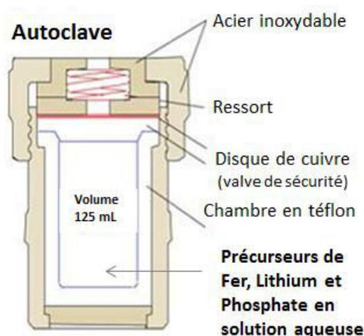
Figure 2. 2 : Schéma du dispositif expérimental de synthèse hydrothermale : représentation d'un autoclave.
