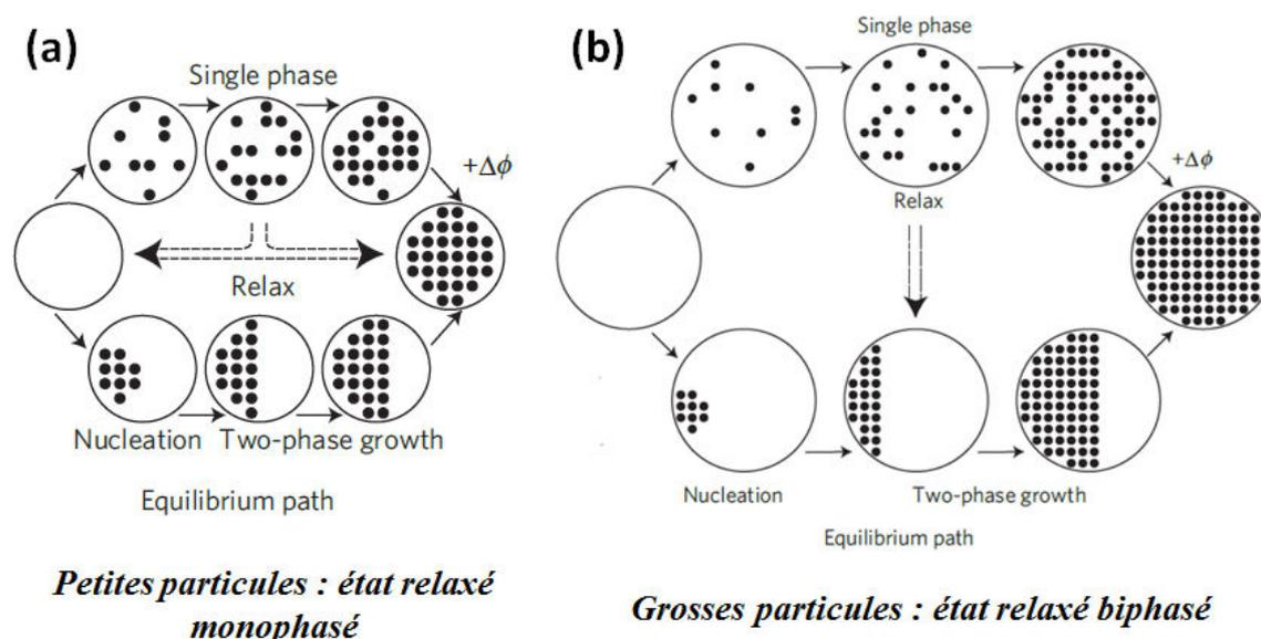
Figure 1. 17 : Comparaison de la transformation de phases  $\text{LiFePO}_4/\text{FePO}_4$  hors équilibre et à l'état relaxé (a) pour de petites particules et (b) pour de grosses particules [90].
