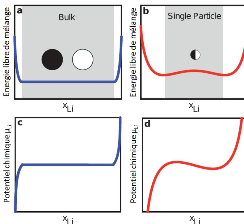
Figure 1. 13 : Représentations schématiques de l'énergie libre de mélange de  $\text{Li}_x\text{FePO}_4$  ( $0 \leq x \leq 1$ ) pour (a) un matériau "bulk" et (b) pour une particule isolée. Les régions biphasées sont représentées en gris. Représentations schématiques du potentiel chimique (c) dans le matériau "bulk" et (d) dans une particule isolée [5].
