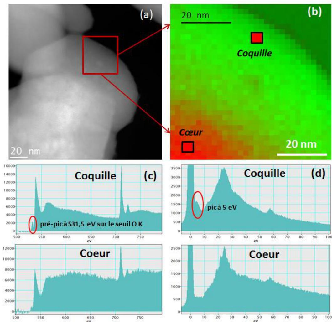
Figure 4. 16 : Clichés STEM, cartographie de phase par STEM EELS d'une particule de l'échantillon LFP-P-D1 partiellement délithié en 24 h : (a) image STEM de la particule, (b) cartographie de phase correspondant au zoom de l'image (a). Spectres EELS associés à ces deux phases : (c) pertes de cœur et (d) plasmons donnant une information sur la composition de l'échantillon.
