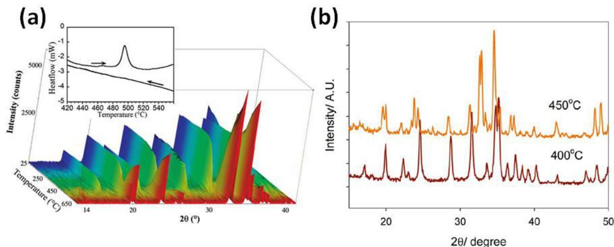
Figure 1. 23 : Transformation de la phase  $\text{NaFePO}_4$  de structure olivine en structure maricite (a) illustrée par les travaux de Moreau et al. [112] à l'aide de la DRX en température et de l'ATD (encadré) autour de 480°C (b) et par les travaux de Lee et al. [115] montrant le diffractogramme de la phase olivine  $\text{NaFePO}_4$  à 400°C et le diffractogramme de la phase maricite  $\text{NaFePO}_4$  à 450°C.
