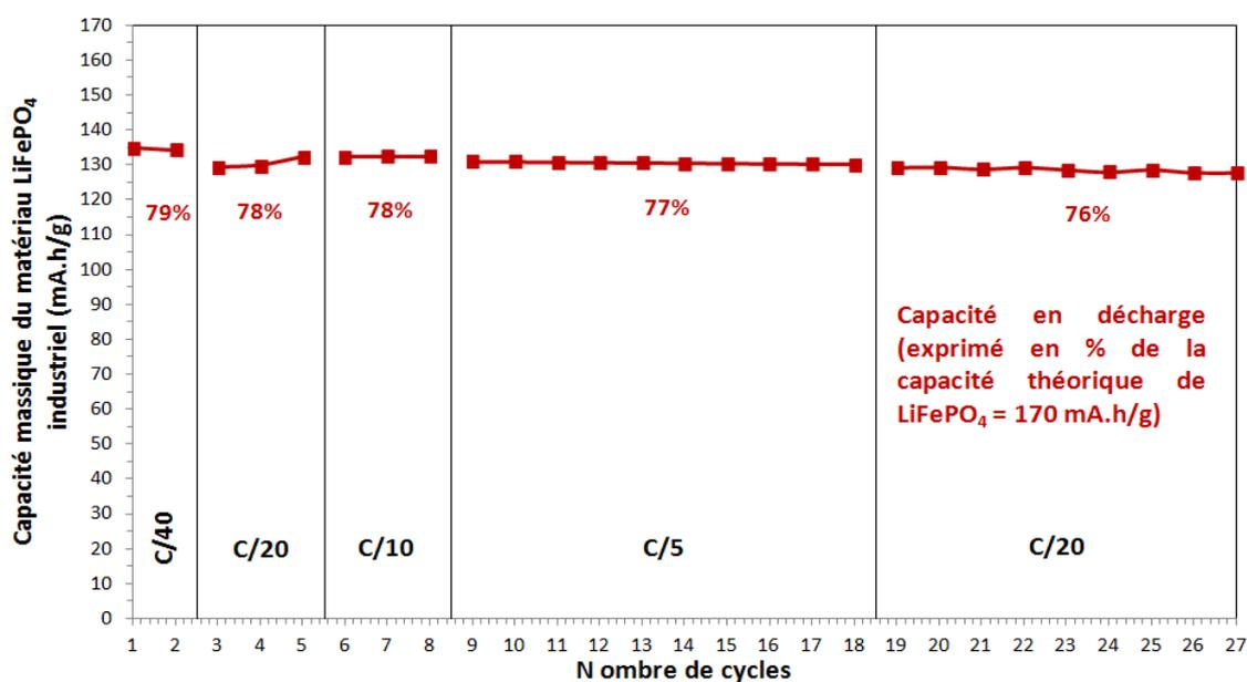
Figure 5. 2 : Evolution de la capacité massique de  $\text{LiFePO}_4$  en fonction du nombre de cycles de décharge et du régime. Les pourcentages de capacité obtenus sont exprimés par rapport à la capacité massique théorique du matériau  $\text{LiFePO}_4$  de 170 mA.h/g.
