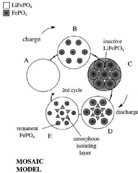
Figure 1. 7 : Représentation du mécanisme de (dé)lithiation illustré par le modèle "Mosaïque" d'Andersson et al [49].
