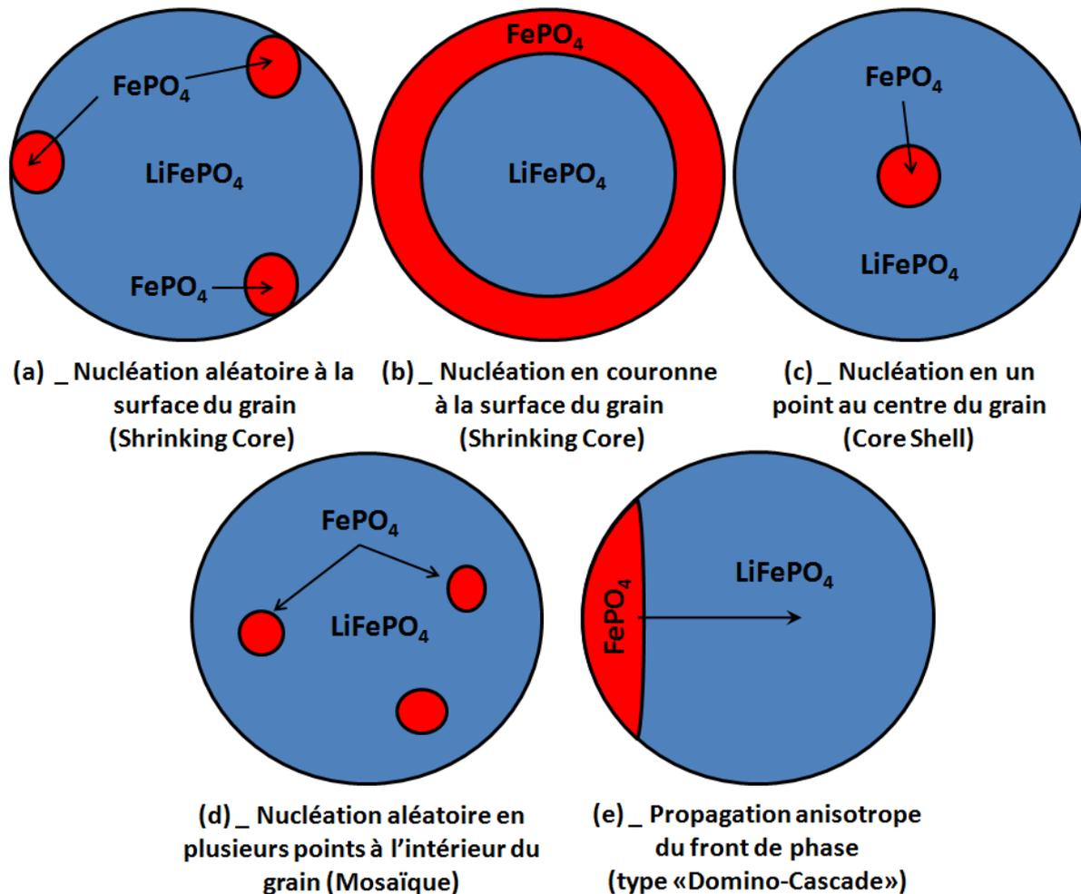
Figure 4. 12 : Représentation schématique des différentes possibilités de nucléation-croissance de la phase  $\text{FePO}_4$  au détriment de la phase  $\text{LiFePO}_4$  au sein d'une particule de forme sphérique.
