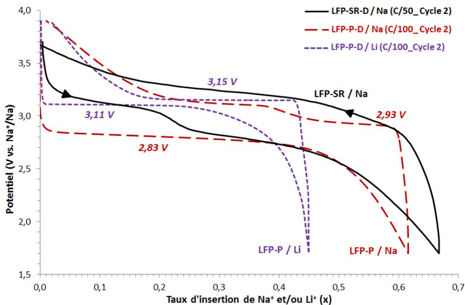
Figure 6. 12 : Comparaison des potentiels de charge et de décharge par rapport au potentiel du couple  $\text{Na}^+/\text{Na}$  pour l'échantillon LFP-SR-D cyclé en demi-cellule sodium au cours des caractérisations structurales in situ (courbe noire), et pour l'échantillon LFP-P cyclé en demi-cellules lithium (courbe violette) et sodium (courbe rouge).
