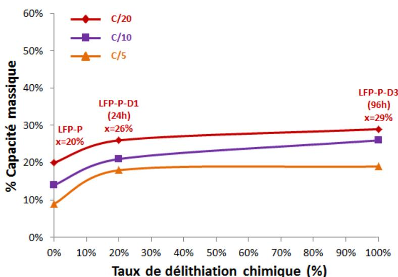
Figure 5. 11 : Evolution du taux d'insertion d'ions  $\text{Li}^+$ , à différents régimes en charge, en fonction du taux de délithiation chimique à différents régimes lors du cyclage des échantillons LFP-P, LFP-P-D1 et LFP-P-D3.
