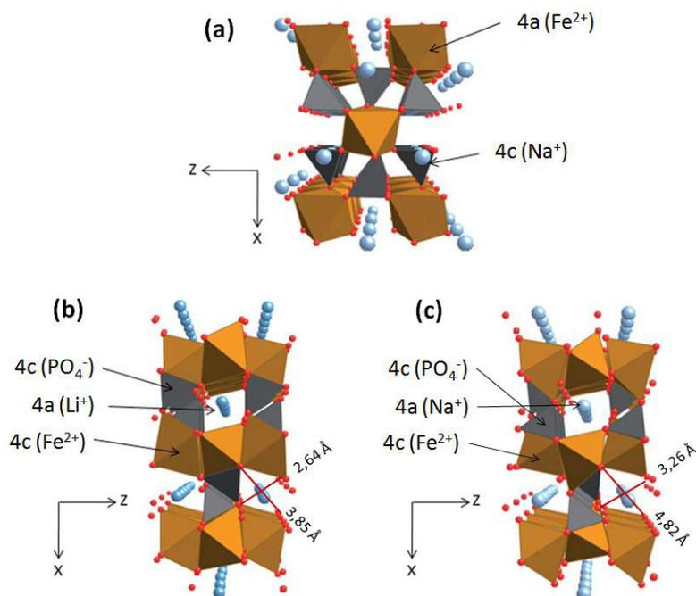
Figure 1. 20 : Structures cristallographiques des phases (a)  $\text{NaFePO}_4$  de type maricite, (b)  $\text{LiFePO}_4$  de type olivine et (c)  $\text{NaFePO}_4$  de type olivine [104]. Indication des sites cristallographiques 4a et 4c et dimensions des canaux cationiques de  $\text{LiFePO}_4$  et de  $\text{NaFePO}_4$  de structure olivine [110].
