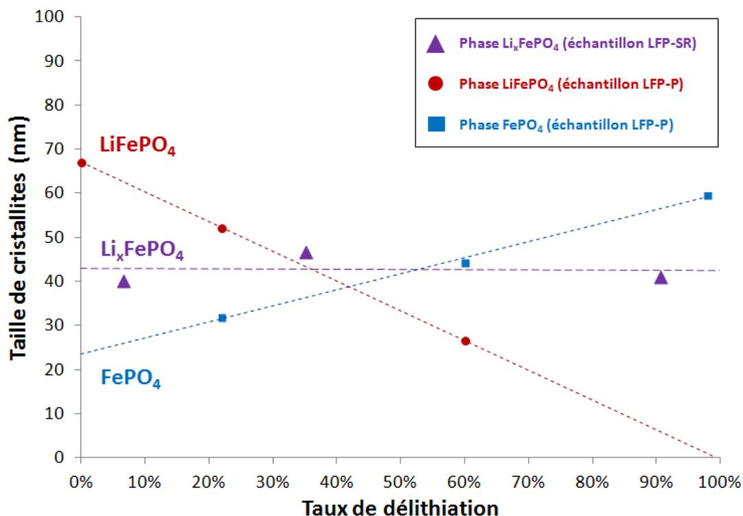
Figure 6. 6 : Evolution de la taille des cristallites en fonction du taux de délithiation pour la phase  $\text{Li}_x\text{FePO}_4$  de l'échantillon LFP-SR et des phases  $\text{LiFePO}_4$  et  $\text{FePO}_4$  de l'échantillon LFP-P.
