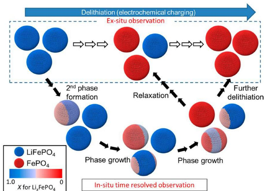
Figure 1. 18 : Modèle de transition progressive de la phase  $\text{Li}_x\text{FePO}_4$  déduit par Orikasa et al. [101] des observations in situ résolues en temps. Les mesures *ex situ* ont été effectuées durant l'état initial et les états relaxés (flèches blanches). Cependant, les mesures synchrotron in situ et résolues en temps fournissent directement un cliché instantané au cours de la transformation de phases (flèches noires).
