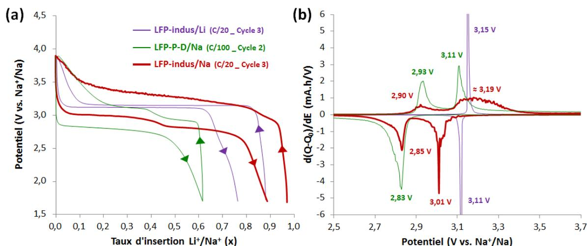
Figure 5. 20 : Comparaison (a) des courbes galvanostatiques et (b) des courbes  $dQ/dE$  pour le matériau  $\text{LiFePO}_4$  industriel cyclé en demi-cellule sodium (courbe rouge) avec le même matériau cyclé en demi-cellule lithium (courbe violette) et le matériau LFP-P cyclé en demi-cellule sodium (courbe verte).
