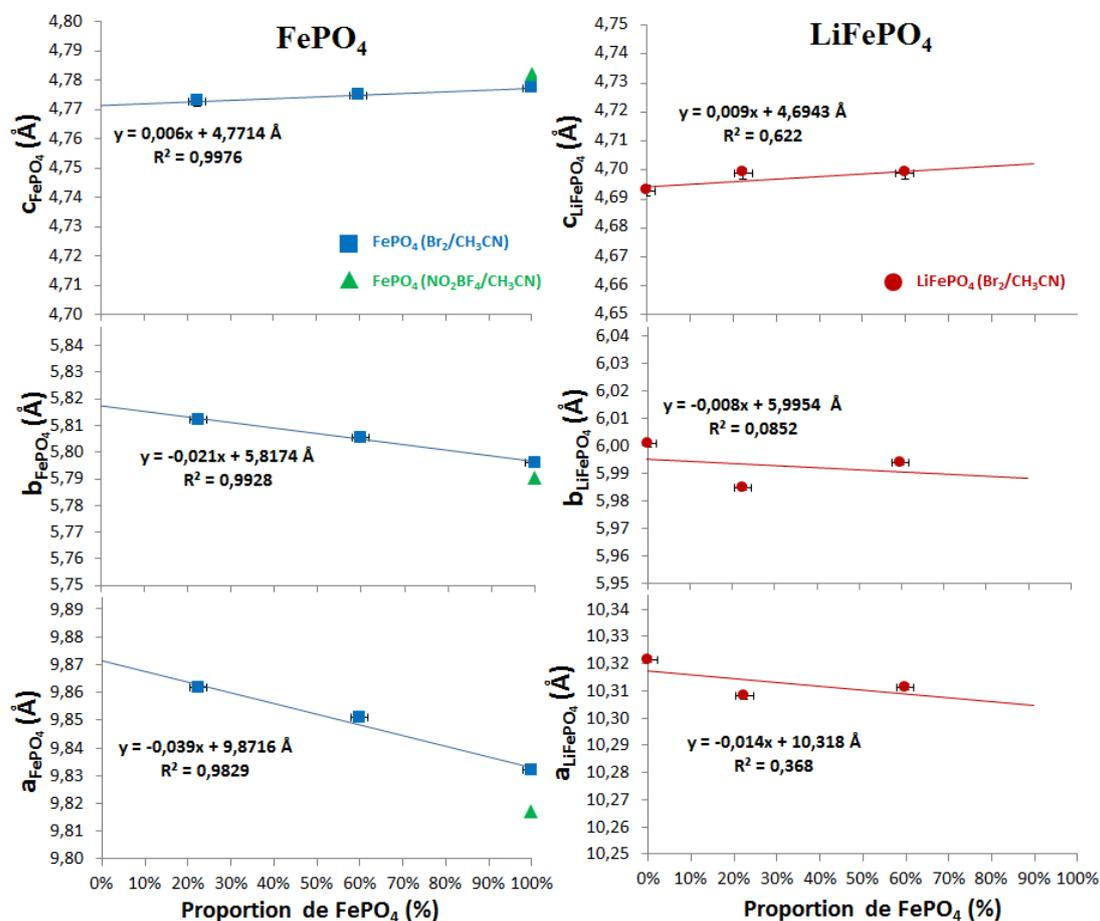
Figure 4. 5 : Evolution des paramètres de maille a, b et c des phases  $\text{FePO}_4$  et  $\text{LiFePO}_4$  en fonction de la proportion de phase  $\text{FePO}_4$  pour l'échantillon LFP-P.
