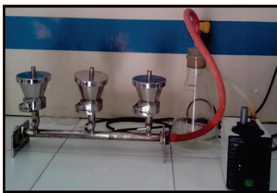
Figure 1 : Rampe de filtration en acier inox
