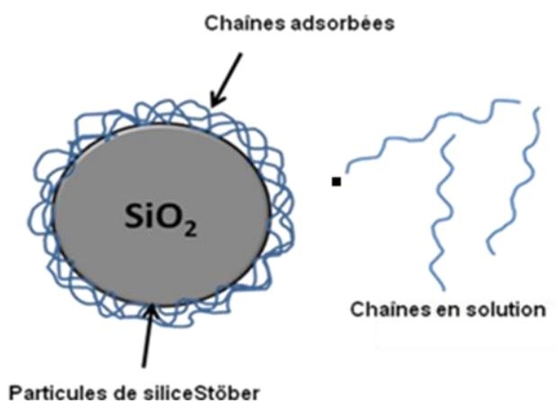
**Figure 4.10:** Schéma représentant la répartition des chaînes fonctionnelles dans le milieu réactionnel.
