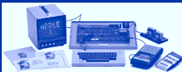
Carte mère de l'Apple I (1976) entourée de ses périphériques d'entrée-sortie et du manuel d'utilisation.
