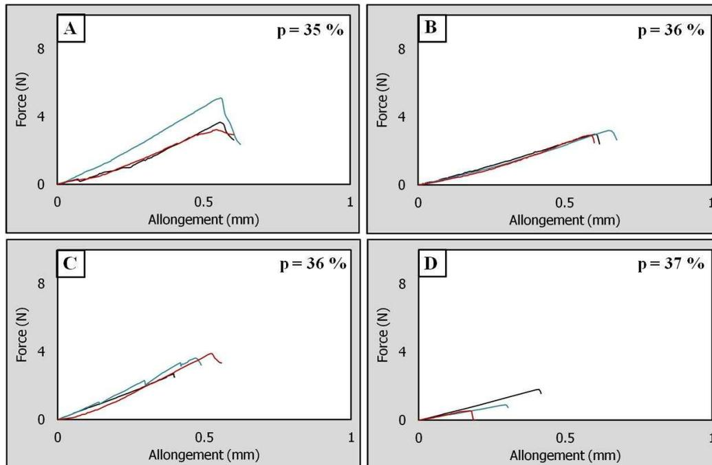
Figure IV. 21 : Force en fonction de l'allongement d'éprouvettes en cru
