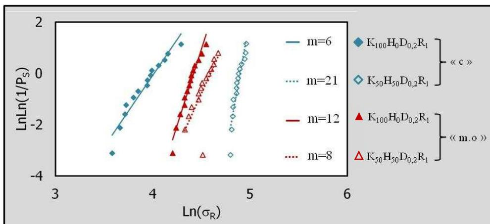
Figure IV. 34 : Analyse statistique de la contrainte à la rupture des bandes  $K_{100}H_0D_{0,2}R_1$  et  $K_{50}H_{50}D_{0,2}R_1$  traitées par « c » ou « m.o »
