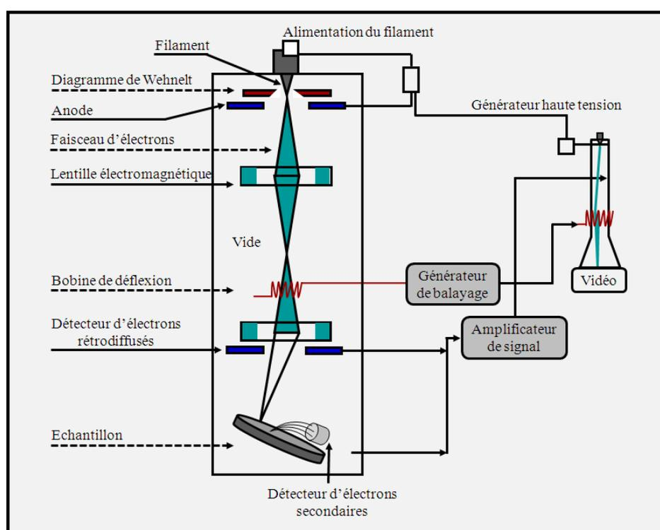
Figure II. 2 : Représentation schématique d'un microscope électronique à balayage
