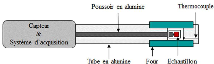
Figure II. 11 : Représentation schématique du dispositif thermodilatométrique
