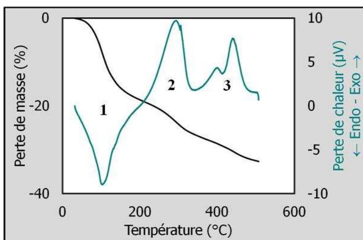
Figure III. 9 : Courbes ATD-ATG du Dolaflux<sup>®</sup>
