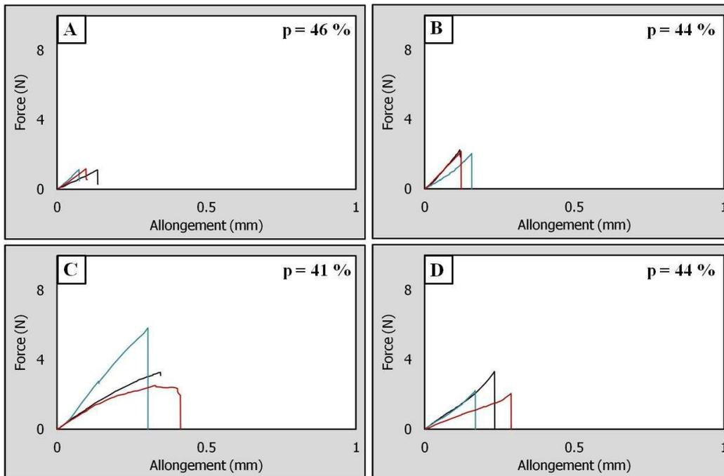
Figure IV. 24 : Force en fonction de l'allongement d'éprouvettes traitées à 1000°C
