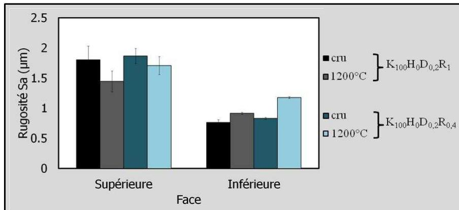
Figure IV. 14 : Valeurs de rugosité des faces supérieure, inférieure de  $K_{100}H_0D_{0,2}R_1$  et  $K_{100}H_0D_{0,2}R_{0,4}$  en cru ou traitées à 1200°C
