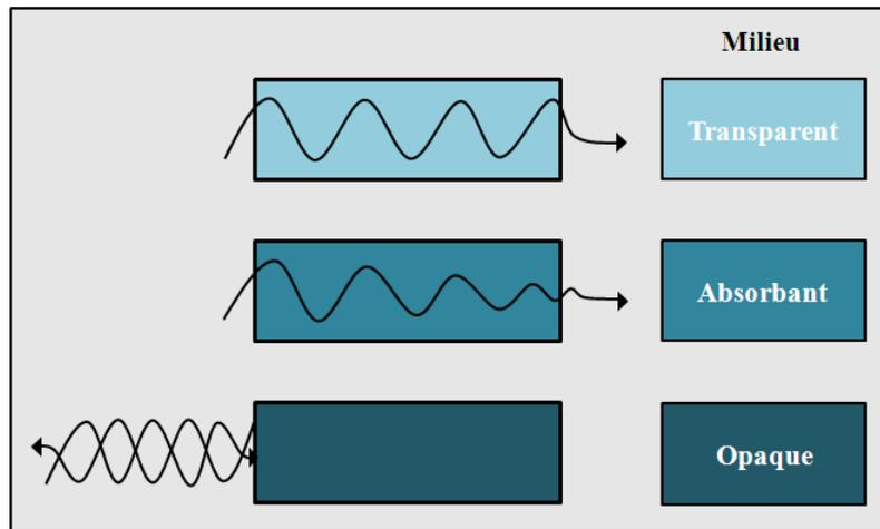
Figure I. 17 : Comportement de la matière vis-à-vis des micro-ondes
