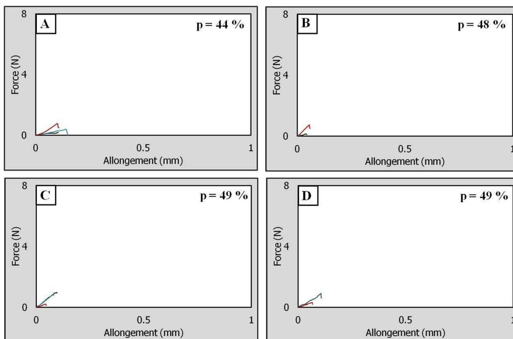
Figure IV. 5 : Force en fonction de l'allongement d'éprouvettes traitées à 850°C
