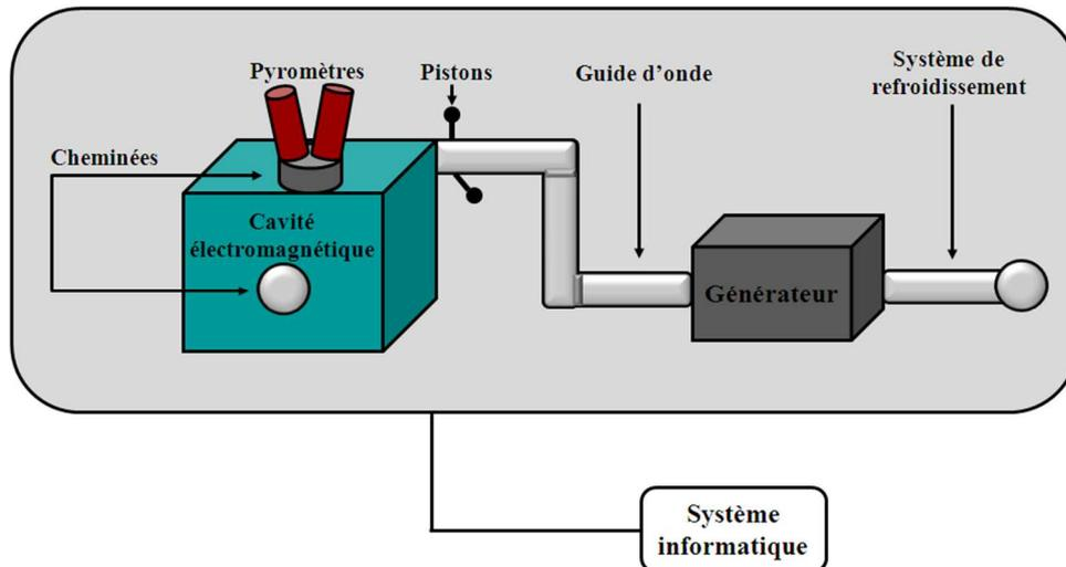
Figure II. 8 : Représentation schématique du four micro-ondes utilisé
