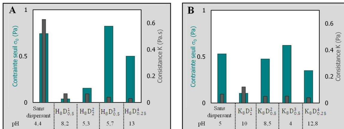
Figure III. 8 : Influence de la nature et quantité en dispersant sur les valeurs de contrainte seuil et de consistance des suspensions contenant 8 % en masse A- d'halloysite et B- de kaolin
