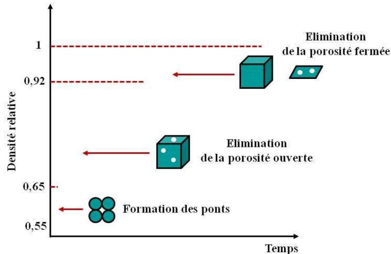
Figure I. 16 : Evolution de la densité relative du matériau au cours du frittage en phase solide [17]
