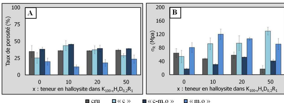
Figure IV. 33 : Influence de la voie de frittage et du cycle thermique sur
