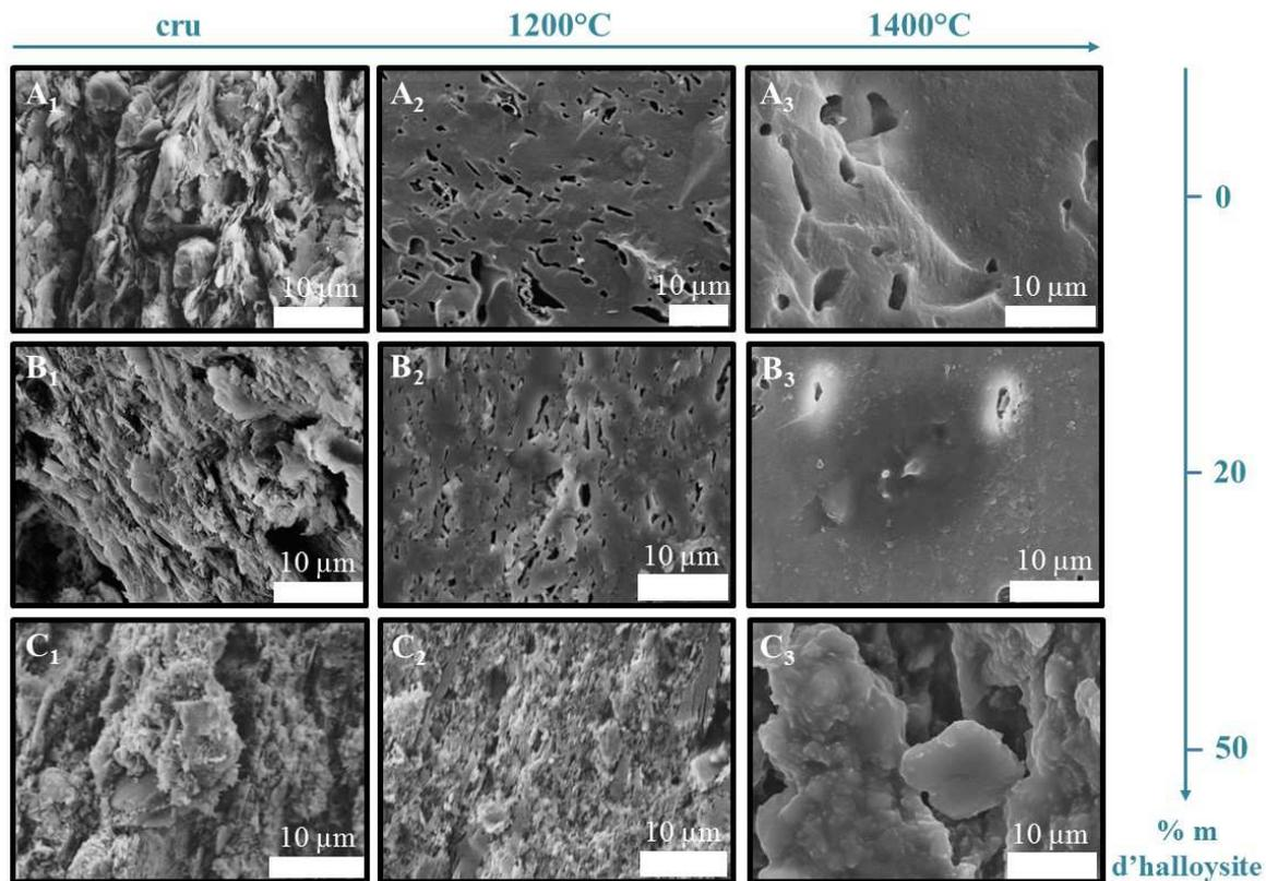
Figure IV. 31 : Microstructure de la tranche des bandes
