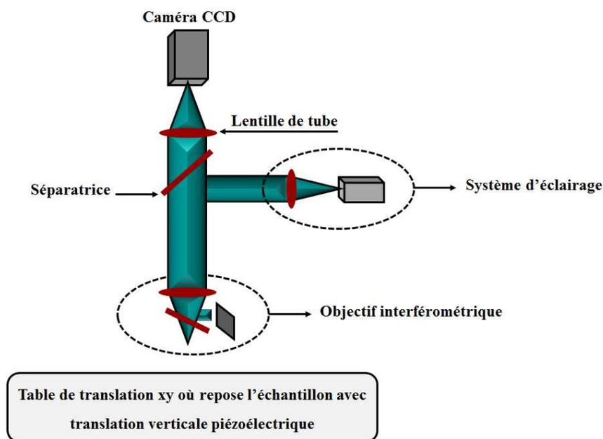
Figure II. 12 : Représentation schématique d'un microscope interférométrique
