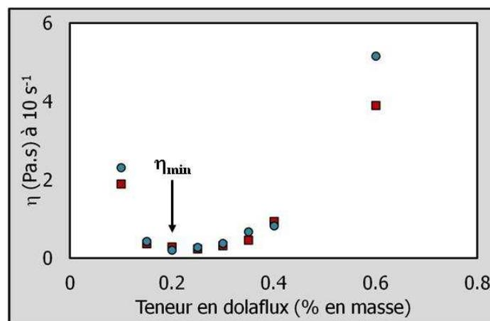
Figure III. 11 : Influence de l'ordre d'introduction des constituants sur la viscosité des suspensions  $K_{100}D_t$  à  $10 \text{ s}^{-1}$  ;  $\circ$  1<sup>er</sup> mode : solvant  $\Rightarrow$  dispersant  $\Rightarrow$  poudre et  $\square$  2<sup>nd</sup> mode : solvant  $\Rightarrow$  poudre  $\Rightarrow$  dispersant
