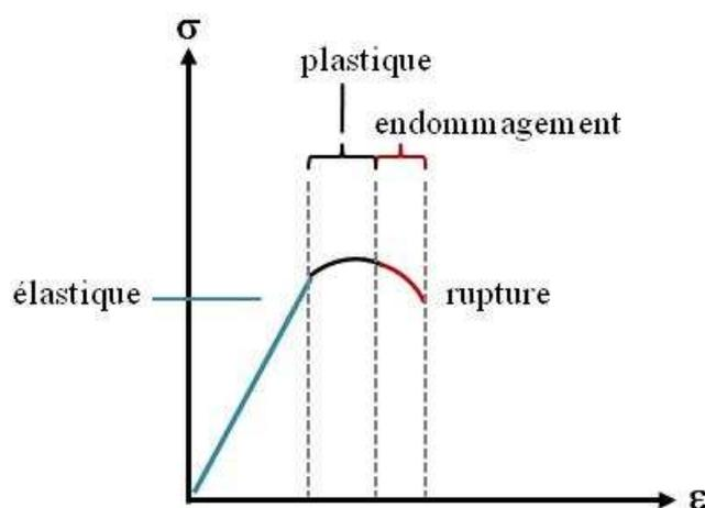
Figure IV. 4 : Représentation schématique du comportement à la rupture des matériaux en cru
