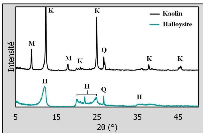
Figure III. 1 : Diffractogrammes du kaolin et de l'halloysite
