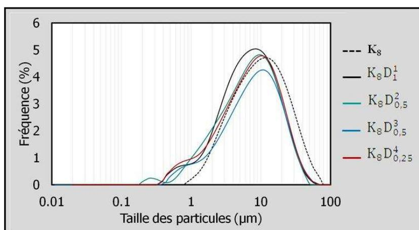
Figure III. 6 : Influence des teneurs (idéales) en carbonate de sodium, silicate de sodium, hexamétaphosphate de sodium et Dolaflux<sup>®</sup> sur la répartition granulométrique des suspensions de kaolin
