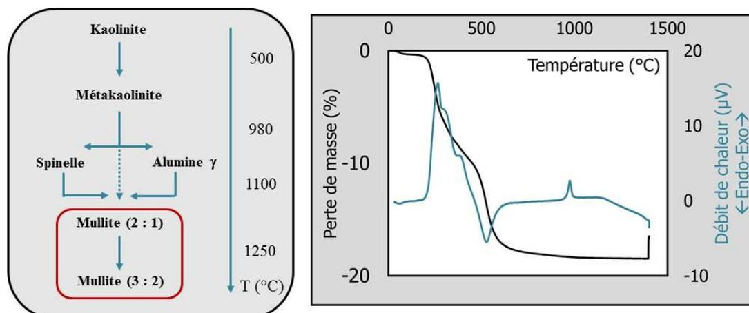
Figure I. 5 A- Représentation schématique de la transformation kaolinite – mullite
