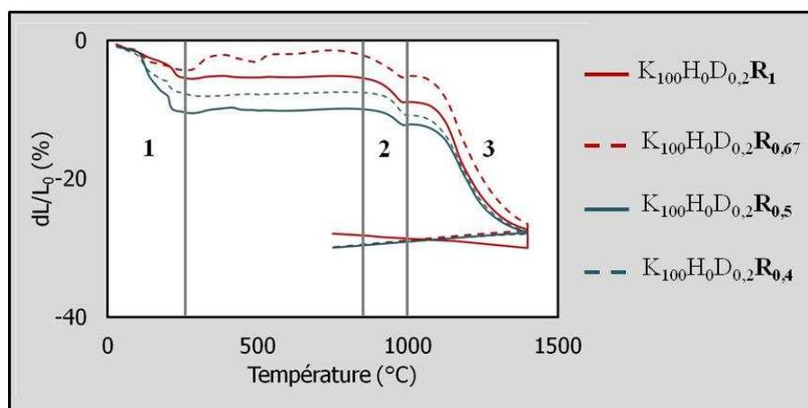
Figure IV. 2 : Courbes thermodilatométriques de  $K_{100}H_0D_{0,2}R_z$
