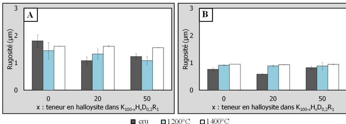
Figure IV. 32 : Influence de la teneur en halloysite et de la température de traitement thermique sur les valeurs de rugosité des faces A- supérieure et B- inférieure des bandes  $K_{100-x}H_xD_{0,2}R_1$
