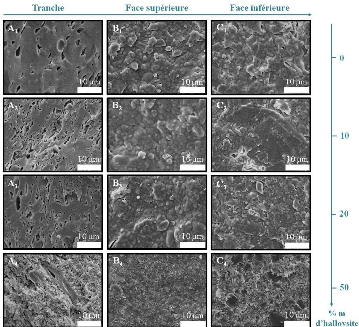
Figure IV. 35 : Influence du frittage « m.o » à 1200°C sur la microstructure de la
