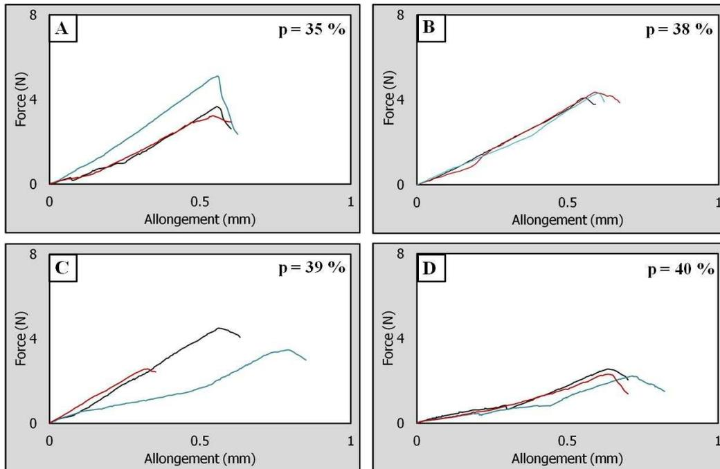
Figure IV. 3 : Force en fonction de l'allongement des éprouvettes en cru
