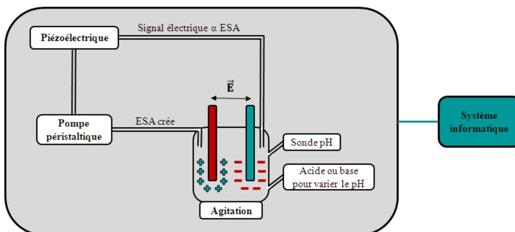
Figure II. 5 : Représentation schématique des éléments constituant l'acoustophoromètre utilisé
