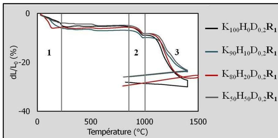
Figure IV. 19 : Courbes thermodilatométriques de  $K_{100-x}H_xD_{0,2}R_1$
