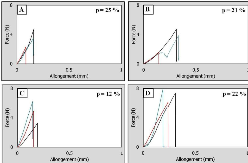
Figure IV. 7 : Force en fonction de l'allongement d'éprouvettes traitées à 1200°C
