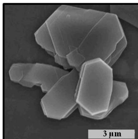
Figure I. 4 : Kaolinite bien cristallisée [17]
