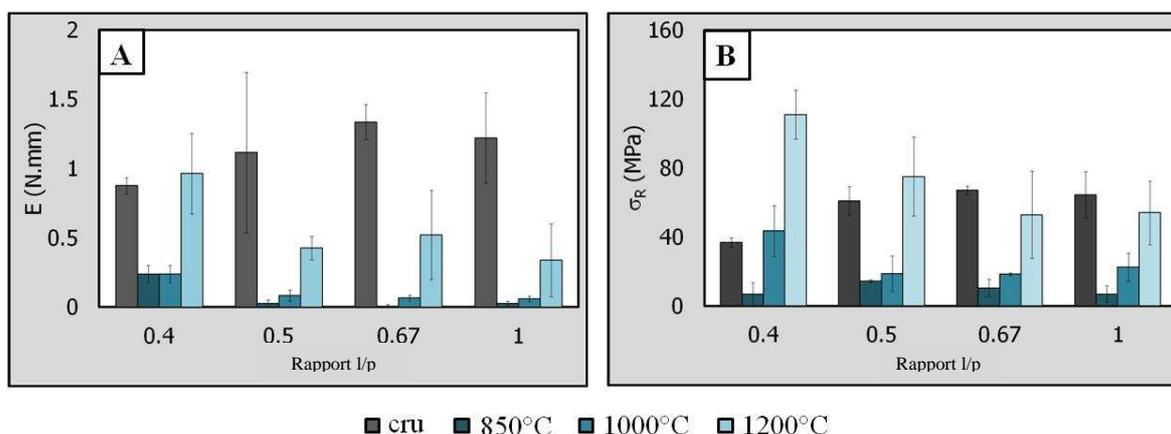
Figure IV. 8 : Influence du rapport R et de la température de traitement thermique sur A- l'énergie emmagasinée B- la contrainte à la rupture des bandes céramiques K<sub>100</sub>H<sub>0</sub>D<sub>0,2</sub>R<sub>z</sub>
