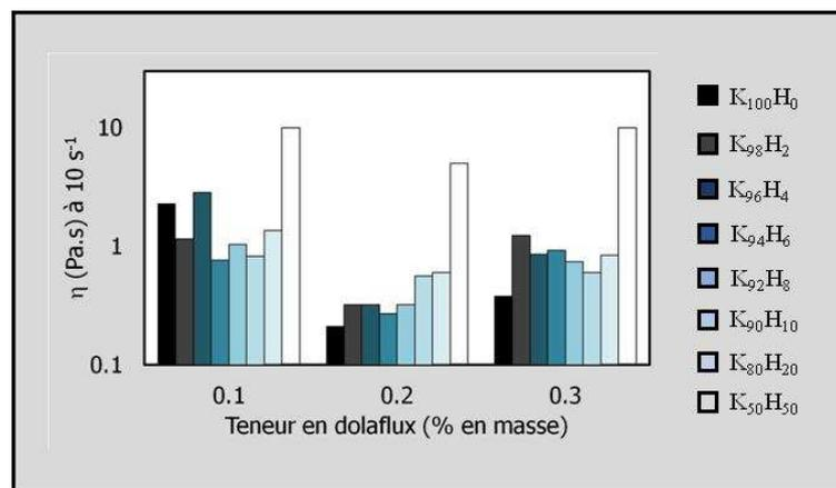
Figure III. 20 : Influence de la teneur en Dolaflex<sup>®</sup> sur les valeurs de viscosité à  $10 \text{ s}^{-1}$  des suspensions mixtes  $K_{100-x}H_xD_t$
