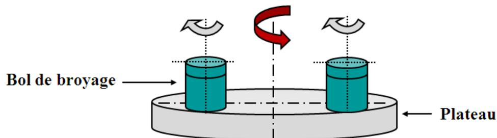
Figure III. 12 : Représentation schématique d'un broyeur planétaire
