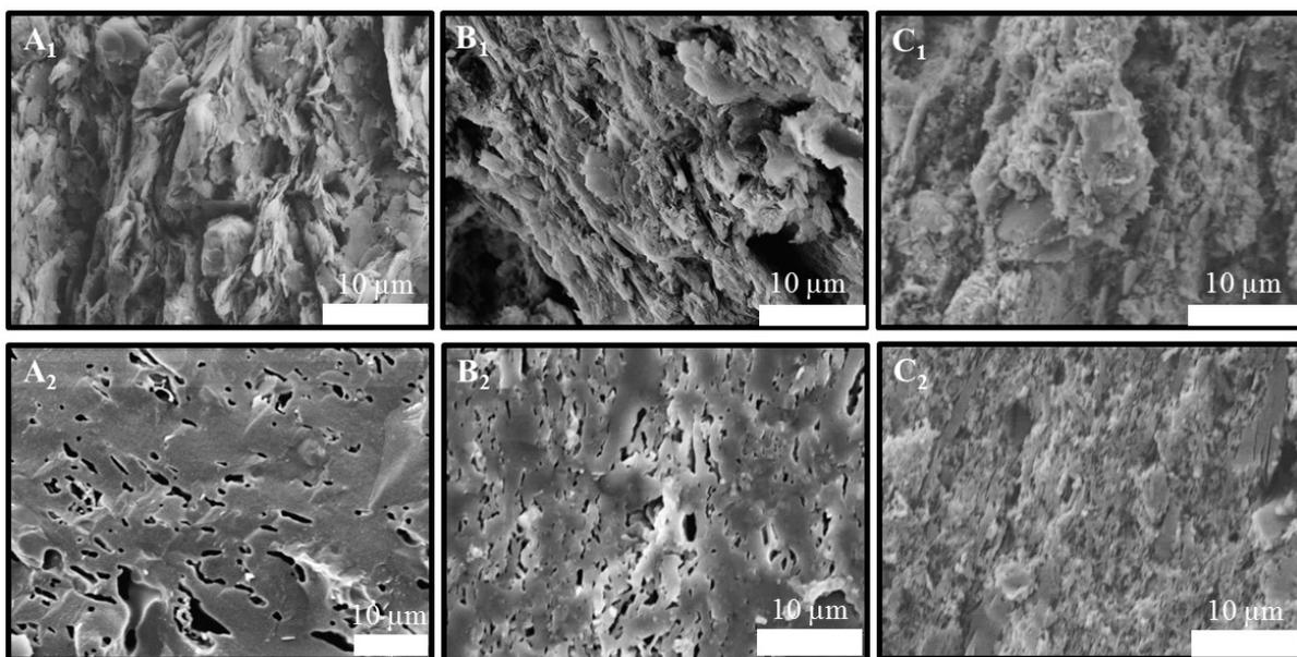
Figure IV. 27 : Microstructure de la tranche des bandes
