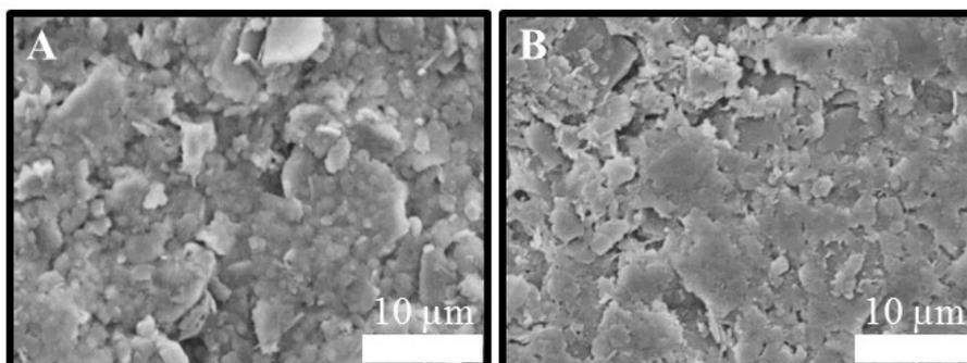
Figure IV. 13 : Microstructure des faces A- supérieure et B- inférieure de  $K_{100}H_0D_{0,2}R_1$  en cru
