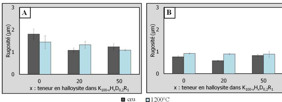
Figure IV. 29 : Influence de la teneur en halloysite et de la température du traitement thermique sur les valeurs de rugosité des faces A- supérieure et B- inférieure des bandes  $K_{100-x}H_xD_{0,2}R_1$
