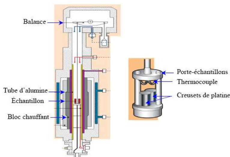
Figure II. 1 : Représentation schématique d'un dispositif ATD-ATG couplé
