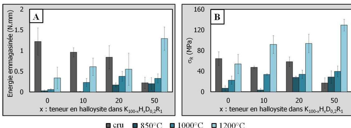
Figure IV. 26 : Influence de la teneur en halloysite et de la température de traitement thermique sur A- l'énergie emmagasinée et B- la contrainte à la rupture des bandes céramiques K<sub>100-x</sub>H<sub>x</sub>D<sub>0,2</sub>R<sub>1</sub>
