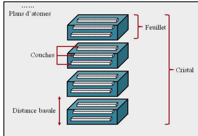
Figure I. 3 : Représentation schématique de la structure des phyllosilicates
