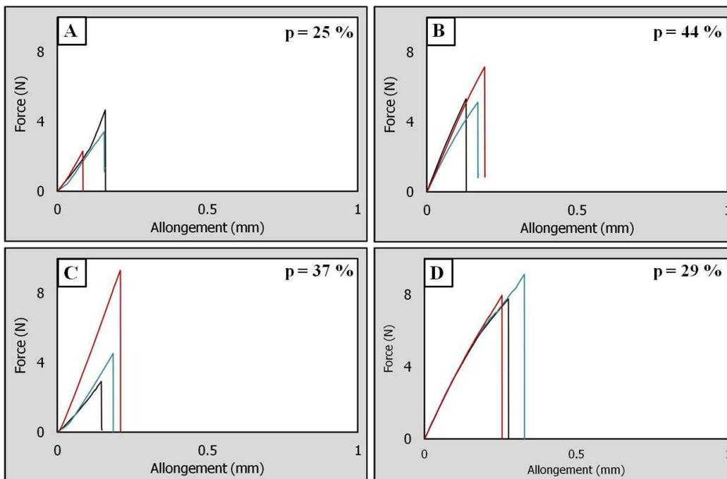
Figure IV. 25 : Force en fonction de l'allongement d'éprouvettes traitées à 1200°C
