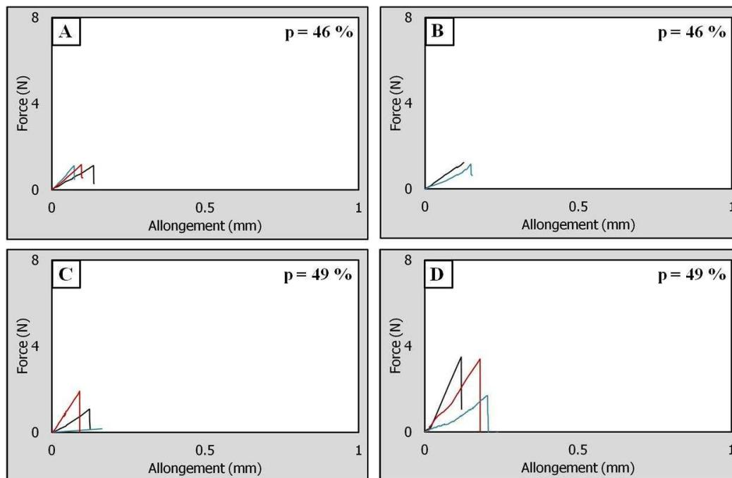
Figure IV. 6 : Force en fonction de l'allongement d'éprouvettes traitées à 1000°C
