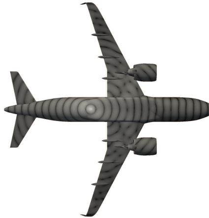
FIGURE 6.1 – Courant de surface généré par l'antenne sur un A319.
