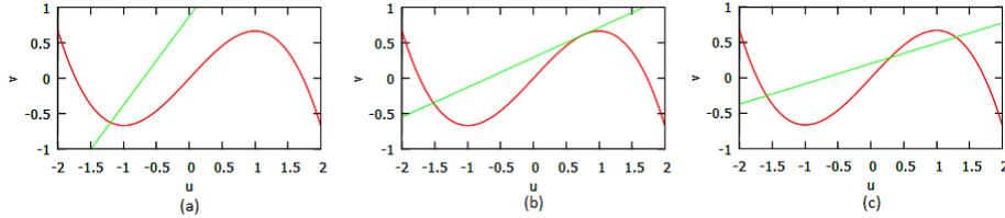
**Figure 3.1.** Simulations numériques obtenues pour les deux nullclines du système (3.1) avec  $a = 0.7, \tau = 13$  et  $I = 0$ ,  $\dot{u} = 0$  en rouge et  $\dot{v} = 0$  en vert. La figure (a) représente un seul point d'équilibre du système (3.1) pour  $b = 0.8$ ; la figure (b) représente ses deux points d'équilibre pour  $b \simeq 2.3791$ ; et la figure (c) montre ses trois points d'équilibre pour  $b = 3.5$ .
