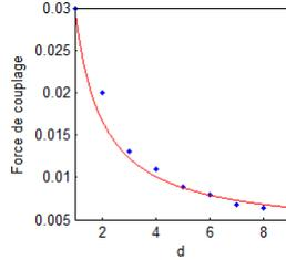
**Figure 6.12.** Evolution de la force de couplage  $g_{20}^{(d)}$  pour laquelle la synchronisation de 20 nœuds a lieu en fonction du degré de nœuds du réseau régulier couplés unidirectionnellement avec couplage linéaire et elle suit la loi  $g_{20}^{(d)} = \frac{0.0265}{d} + 0.0035$ .
