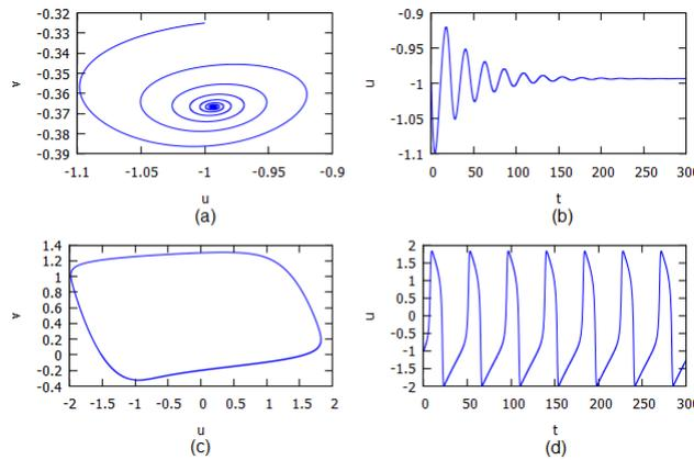
**Figure 3.5.** (a) Portrait de phase dans le plan  $(u, v)$  du système (3.7) avec  $I = 0.3$ , montrant un foyer stable pour une valeur  $I = 0.3 < I_c$ . (b) Série temporelle  $(t, u)$  correspondante. (c) Portrait de phase dans le plan  $(u, v)$  du système (3.7) avec  $I = 0.4$ , montrant un cycle stable pour une valeur  $I = 0.4 > I_c$ . (d) Série temporelle  $(t, u)$  correspondante.
