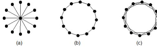
**Figure 6.3.** La figure (a) représente un réseau en étoile; (b) représente un réseau en anneau; (c) représente un réseau régulier dans lequel chaque nœud couplé avec ses  $2k$  plus proches voisins ( $k = 2$  dans ce cas).
