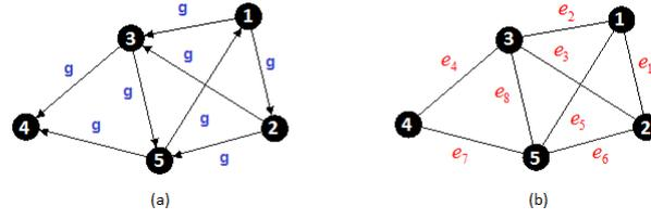
**Figure 6.17.** (a) Réseau couplé unidirectionnellement avec force de couplage  $g$ . (b) Réseau symétrisé de (a) avec connections bidirectionnelles. Les flèches indiquent la direction de couplage le long d'une arête; les arêtes sans flèches sont couplées bidirectionnellement.
