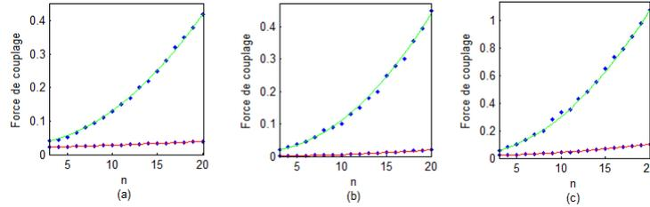
**Figure 6.20.** Evolution de la force de couplage pour laquelle la synchronisation a lieu en fonction du nombre  $n$  de nœuds du réseau en anneau couplé unidirectionnellement. Les courbes en rouge sont pour  $T = 3000$  et celles en vert sont pour  $T = 200$ . La figure (a) correspond aux conditions initiales mélangées entre spirale et homogène, la figure (b) correspond à celles en spirale, et la figure (c) correspond à celles suivant la loi uniforme sur  $[-1, 1]$ .
