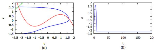
Figure 3.2. (a) Résultat numérique obtenu pour les deux nullclines du système (3.1) avec  $a = 3.5, b = 0.8, \tau = 13$  et  $I = 0$ ,  $\dot{u} = 0$  en rouge et  $\dot{v} = 0$  en vert. Le point d'intersection des nullclines est le point d'équilibre. La courbe bleu est obtenue en traçant la dynamique asymptotique d'une solution du système partant d'une condition initiale. (b) Série temporelle  $(t, u)$  correspondante.
