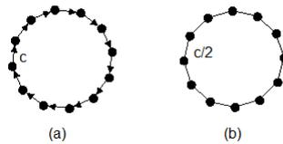
**Figure 6.8.** La figure (a) représente un réseau en anneau couplé unidirectionnellement; (b) représente son réseau associé symétrique avec moitié de force de couplage par arête. La flèche veut dire la direction de couplage le long d'une arête et l'arête sans flèche est couplée bidirectionnellement.
