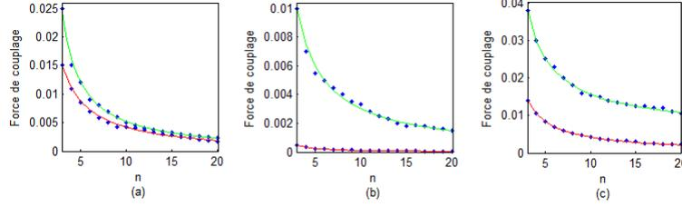
**Figure 6.19.** Evolution de la force de couplage pour laquelle la synchronisation a lieu en fonction du nombre  $n$  de nœuds du réseau complet. Les courbes en rouge sont pour  $T = 3000$  et celles en vert sont pour  $T = 200$ . La figure (a) correspond aux conditions initiales mélangées entre spirale et homogène, la figure (b) correspond à celles en spirale, et la figure (c) correspond à celles suivant la loi uniforme sur  $[-1, 1]$ .
