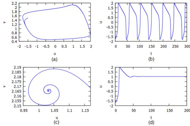
**Figure 3.6.** (a) Portrait de phase dans le plan  $(u, v)$  du système (3.7) avec  $I = 1.4$ , montrant un cycle stable pour une valeur  $I = 1.4 < I'_c$ . (b) Série temporelle  $(t, u)$  correspondante. (c) Portrait de phase dans le plan  $(u, v)$  du système (3.7) avec  $I = 1.5$ , montrant un foyer stable pour une valeur  $I = 1.5 > I'_c$ . (d) Série temporelle  $(t, u)$  correspondante.
