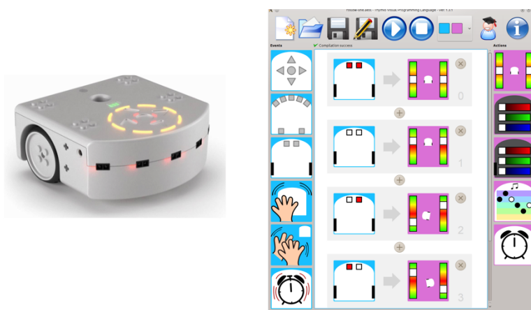
Figure 2.1.: Le robot de Thymio II (à gauche) et une capture d'écran de l'environnement de programmation graphique VPL (à droite).
