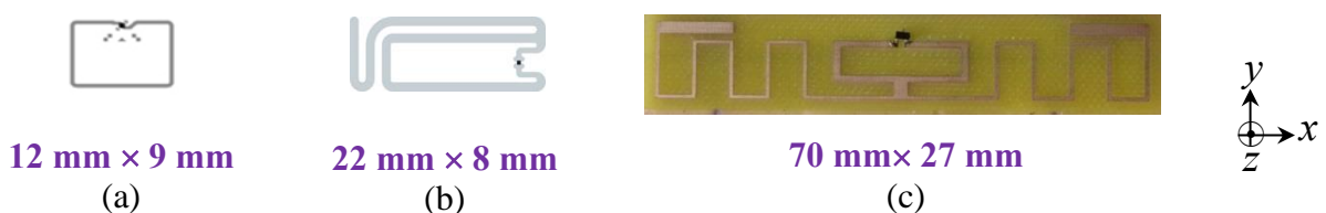
Fig. 2-25 – Tags utilisés lors des tests dédiés à la caractérisation en zone de champ proche réactif (a) ALN 9613 chez Alien, (b) TRAP NF chez Smartrac et tag (c) prototype P1 adapté à la puce Higgs3.
