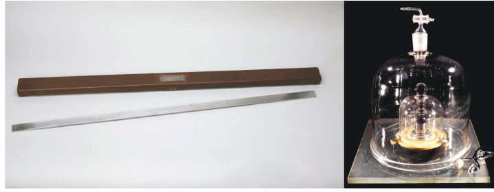
FIGURE 1.1 – A gauche) Étalon prototype en platine du mètre fabriqué en 1799 par Lenoir en application du décret de la Convention nationale sur le nouveau système des poids et mesures, 18 germinal an III [7 avril 1795]. A droite) Étalon Prototype International du Kilogramme (IPK) en alliage de platine iridium utilisé la première fois par le BIPM en 1889. Extrait de la base de donnée Archim http://www.culture.gouv.fr/ et de http://www.bipm.org/ .
