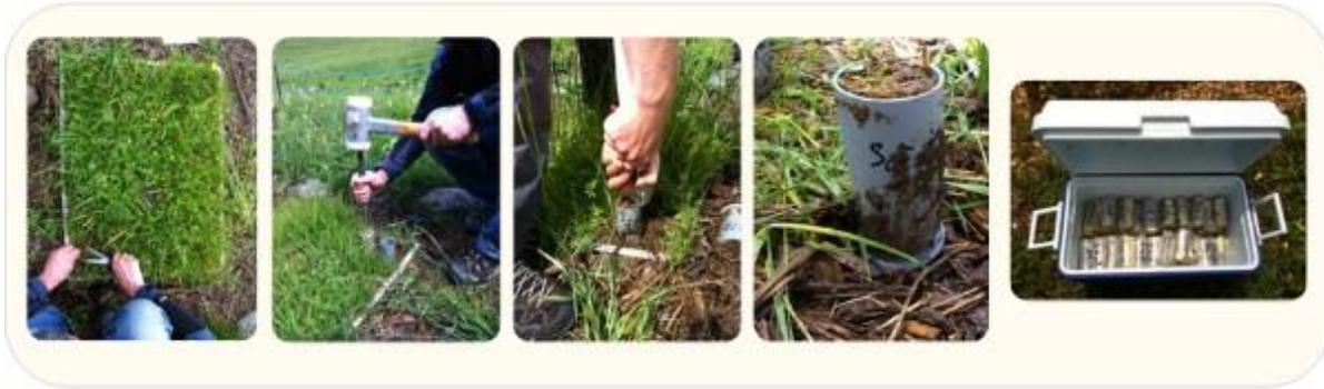
**Figure 27 : Processus d'échantillonnage des sols**
