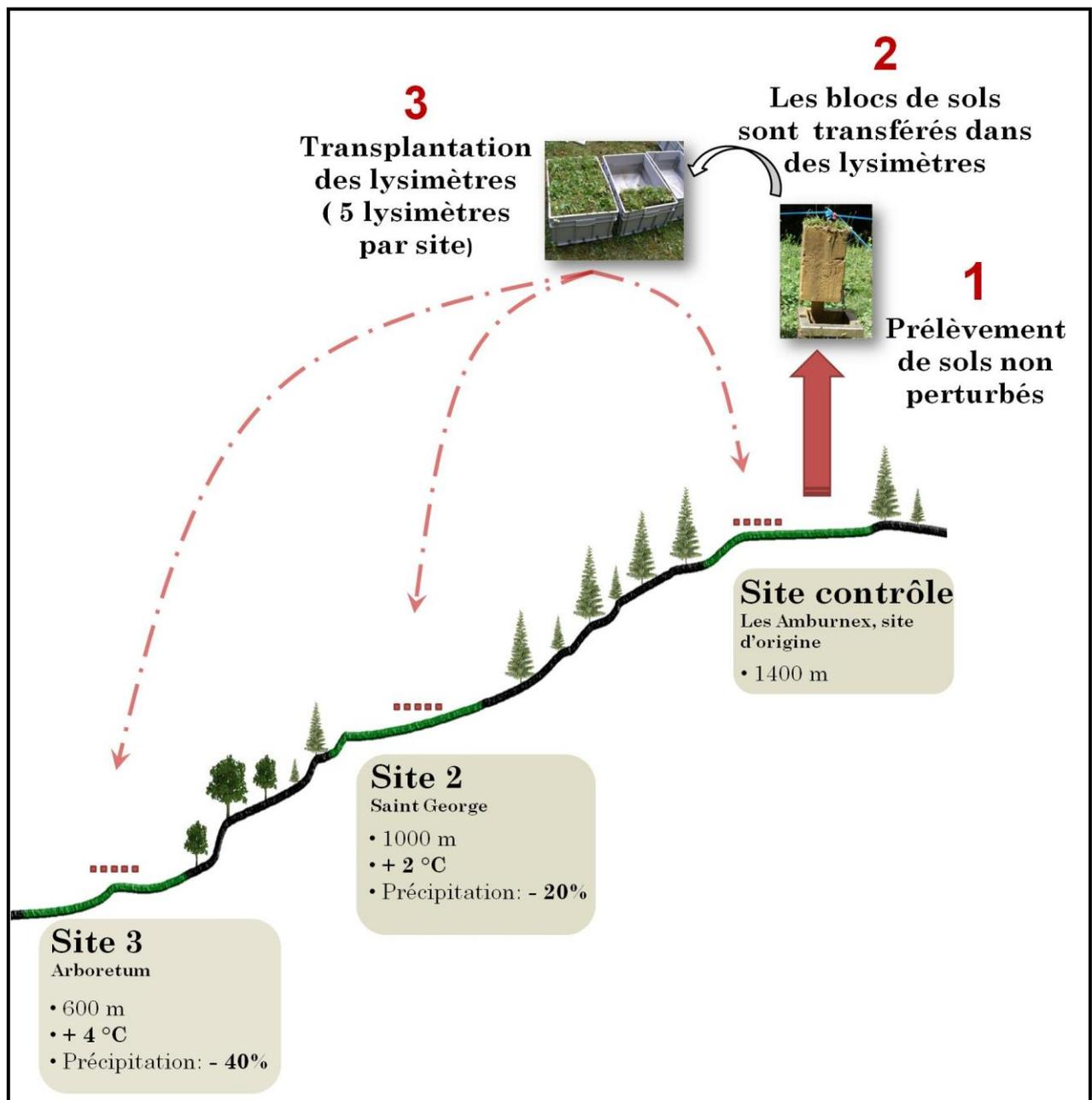
**Figure.25:** Dispositif expérimental utilisé dans le cadre de cette thèse. Simulation de deux scénarios de changement climatique par transplantions de sols d'une prairie subalpine dans le jura suisse (proche de Lausanne).
