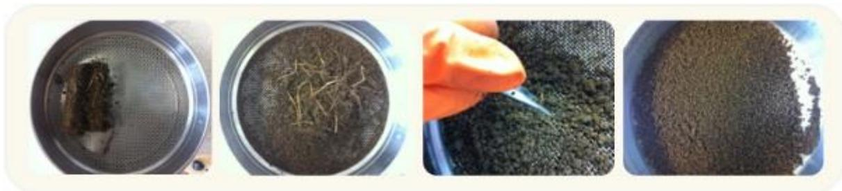
**Figure 28 : Tamisage des carottes de sol à 2mm, les racines sont préalablement mises à part.**
