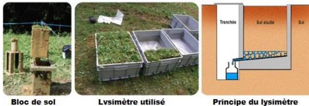
**Figure.24 : Dispositif mis en place pour prélever les sols avant transplantation**
