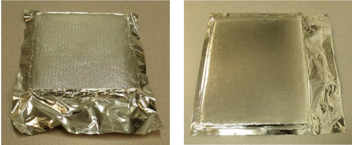
Figure I.3 : Deux échantillons de PIV neufs, avec zone de soudure non repliée (sur tout le pourtour des PIV).
