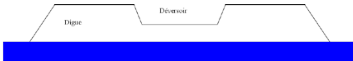
Figure 22 : Représentation schématique d'un déversoir sur une digue
