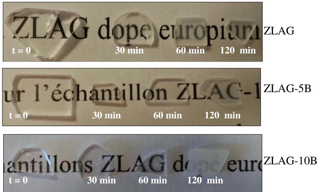
**Figure 19:** Photos des verres et vitrocéramiques dopés 1%  $\text{Eu}^{3+}$  en fonction du temps de traitement : ZLAG traité à  $485^\circ\text{C}$  ; ZLAG-5B traité à  $451^\circ\text{C}$  ; ZLAG-10B traité à  $433^\circ\text{C}$ .
