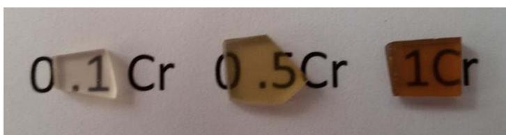
**Figure 17:** Photos des vitrocéramiques ZLAG dopées  $x\text{Cr}^{3+}$  ( $x = 0,1 ; 0,5$  et  $1$  mol %).
