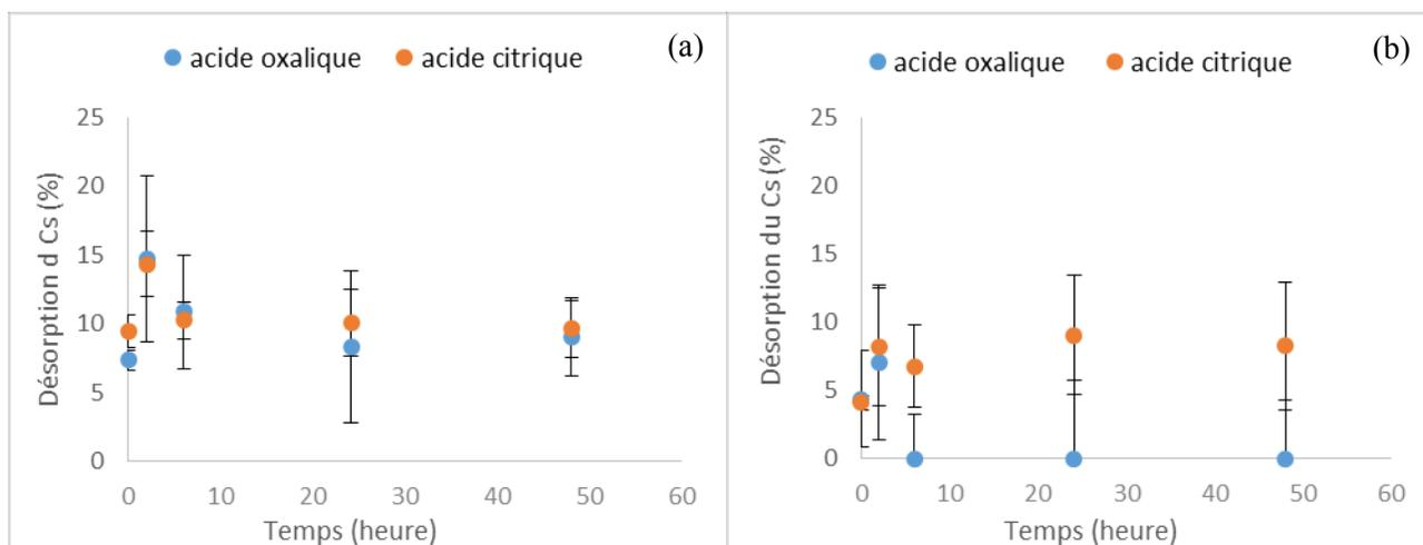
Figure 8 : Mobilisation du Cs de l'illite après ajout de  $40 \mu\text{mol.L}^{-1}$  d'acide citrique ou oxalique à une illite dopée en Cs à : (a)  $10 \text{ mmol.kg}^{-1}$  et (b)  $100 \text{ mmol.kg}^{-1}$  de Cs. Les valeurs sont calculées par rapport à la concentration initiale en Cs sur l'illite et une fois les valeurs du témoin sans acide déduites.
