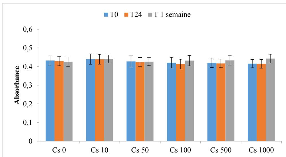
Figure 12 : Mesure de l'absorbance à 405nm au cours du temps d'une suspension de *Pseudomonas fluorescens* contenant 25  $\mu\text{mol PVD.L}^{-1}$  en présence de concentrations croissantes en CsCl (de 0 à 1000  $\mu\text{mol.L}^{-1}$ )
