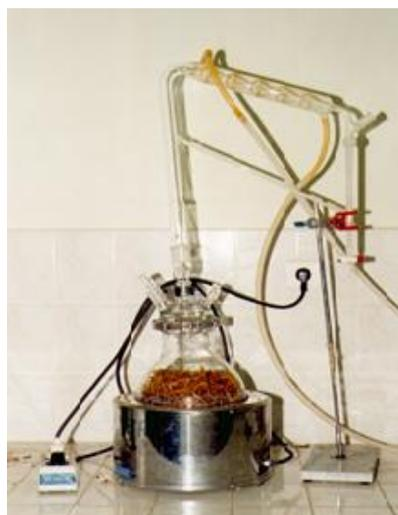
**Figure 4. 2. Montage d'hydrodistillation (extracteur de type Clevenger)**
