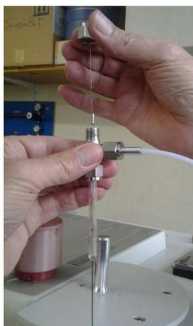
Figure 4. 4. Montage du pyrolyseur à point de Curie
