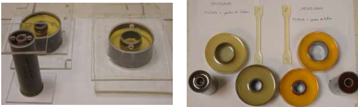
Figure A 4 Démoulage des bruts des rotules
