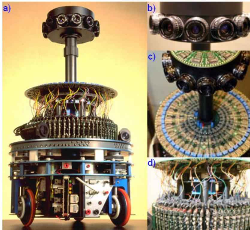
**FIGURE 8.:** Le robot mouche est doté d'un œil plan panoramique équipé d'une centaine de capteur visuel de mouvement. Ainsi, le robot est capable d'évaluer la direction de l'obstacle le plus proche grâce à la constance de sa propre vitesse de déplacement en translation pure [Pichon et al., 1989; Blanes, 1991; Pichon, 1991; Franceschini et al., 1992].
