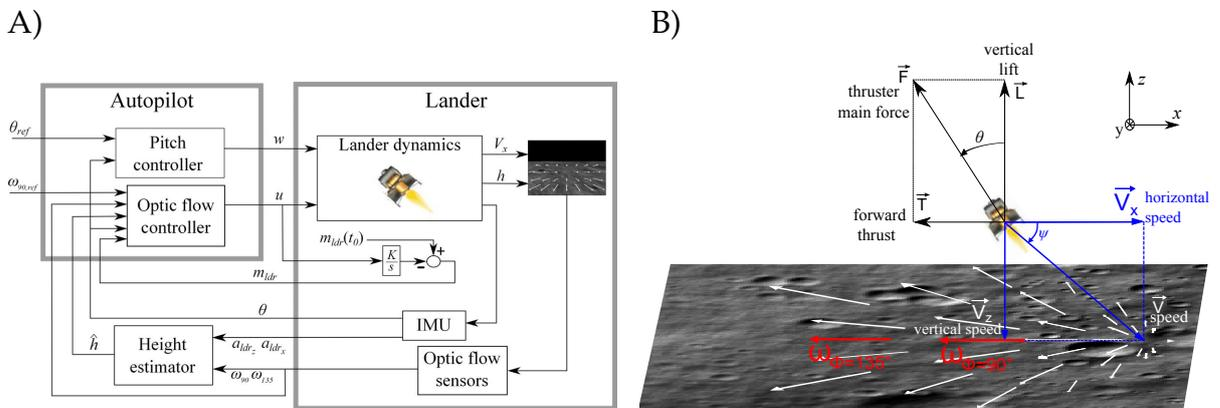
**FIGURE 20.:** A) Pilote automatique simulé qui rend la trajectoire optimale par rapport à la consommation d'énergie grâce à 2 boucles de rétro-action qui pilotent la poussée au niveau des tuyères et le tangage de l'alunisseur grâce à 2 mesures de flux optique et aux mesures inertielles.
