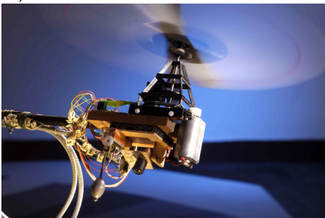
FIGURE 13.: A) Robot OCTAVE B) Pilote automatique OCTAVE agissant sur la force de sustentation pour maintenir constant le flux optique ventral [Ruffier and Franceschini, 2005; Franceschini et al., 2007].
