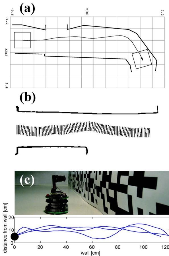
**FIGURE 11.**: Comportements de suivi de paroi obtenus en robotique mobile en utilisant la stratégie de “maintien du flux optique unilatéral couplée à une vitesse d’avance constante”. (a) Réaction à une ouverture latérale de type porte (d’après [Santos-Victor et al., 1995]), (b) Réaction à une large ouverture (d’après [Weber et al., 1997]), (c) Suivi de paroi d’un robot *Khepera* dans une arène (d’après [Zufferey and Floreano, 2005]).
