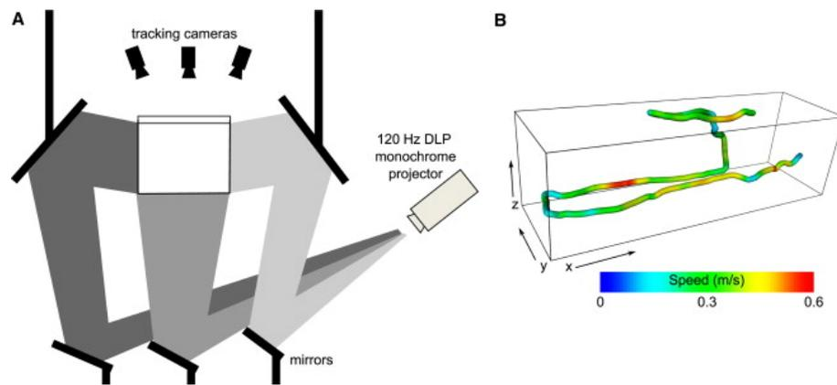
FIGURE 38.: Tunnel équipé de cameras infra-rouges pour mesurer en temps réel la position de la mouche en utilisant le contraste créé par la mouche (point noir sur fond blanc) grâce à l'illumination infra-rouge par l'arrière. [Straw et al., 2010]
