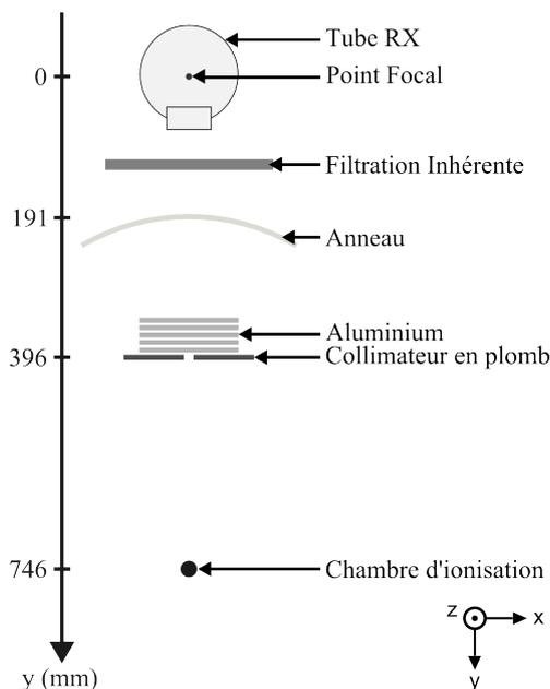
FIGURE 3.2 – Protocole expérimental pour la mesure des CDA
