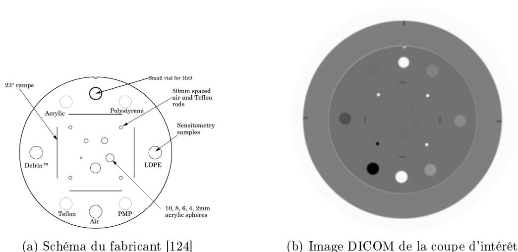
FIGURE 6.4 – Module CTP404 du fantôme Catphan<sup>®</sup>
