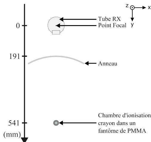
FIGURE 4.2 – Schéma du dispositif expérimental
