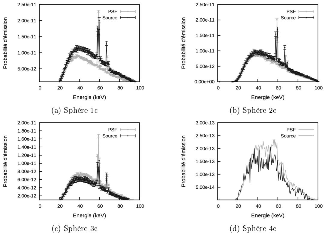
FIGURE 3.17 – Spectres moyens issus du PSF et de la source après filtration dans différentes sphères du cone d'émission large sans le collimateur
