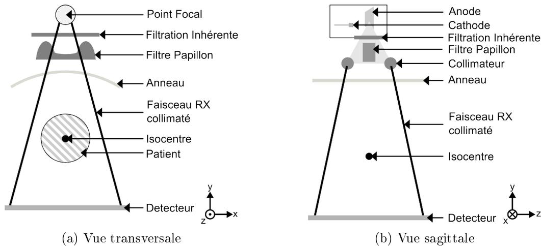
FIGURE 3.1 – Représentation schématique du scanner GE VCT Lightspeed 64
