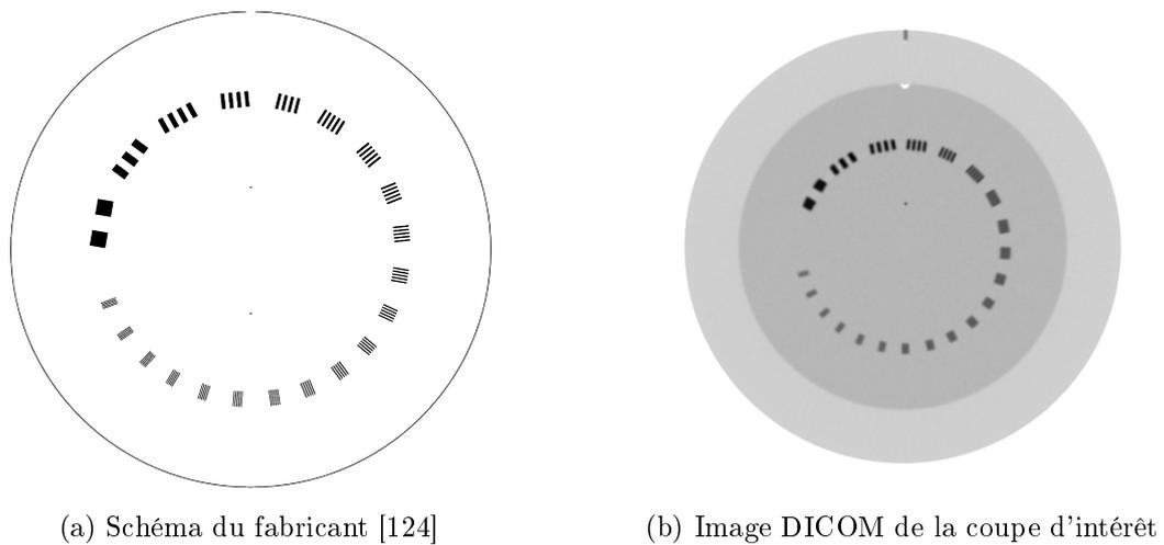
FIGURE 6.6 – Module CTP528 du fantôme Catphan<sup>®</sup>
