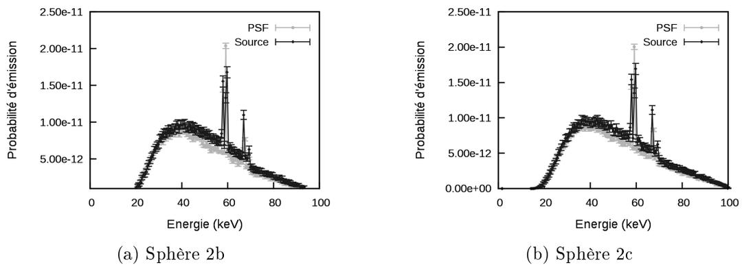
FIGURE 3.18 – Spectres moyens issus du PSF et de la source histogrammée après filtration pour la rangée 2 sans le collimateur
