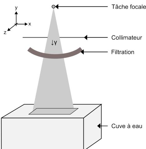
FIGURE 3.25 – Schématisation de la géométrie pour la simulation
