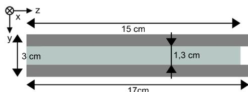
FIGURE 4.1 – Section longitudinale du tube en PMMA
