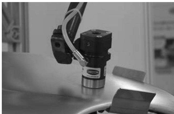
Figure 1.3 : Ventouse magnétique ( www.schmalz.fr ).
