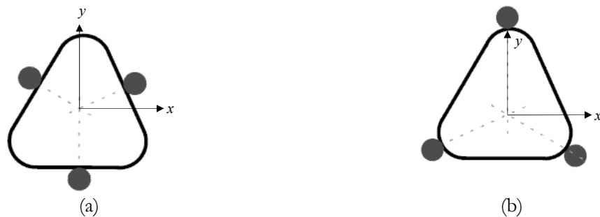
Figure 2.23 : (a) prise fermée géométriquement au 2 nd ordre, (b) prise non-fermée géométriquement [Rimon et Burdick, 1996].
