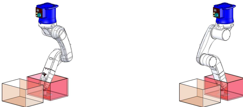
Figure 4.5 : Le robot peut adopter 2 configurations différentes pour une même position et orientation du préhenseur.
