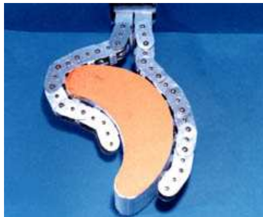
Figure 1.22 : Le Soft Gripper de Hirose ( www-robot.mes.titech.ac.jp ).
