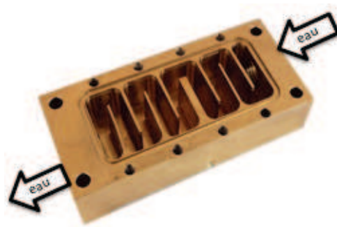
Figure 66 : Echangeur thermique intégré au porte-échantillon
