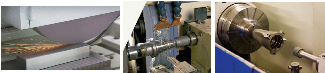
Figure 7 : Opérations de rectification (source NORTON, PFERD)
