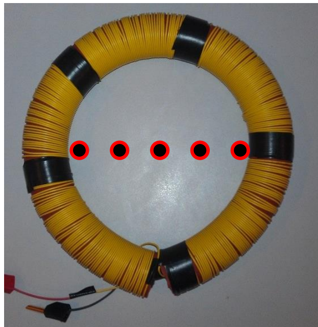
FIGURE 5.12: Tore de Rogowski artisanal utilisé lors des tests du prototype ARCaD 3 avec les différentes positions du conducteur primaire.
