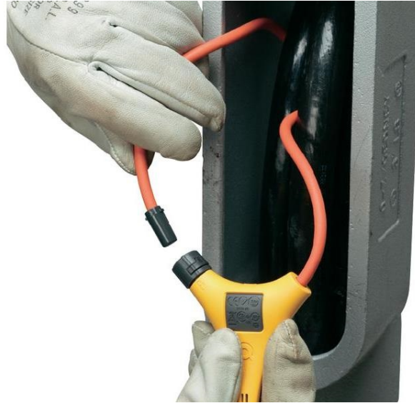
FIGURE 3.3: Modèle flexible de Tore de Rogowski de chez Fluke
