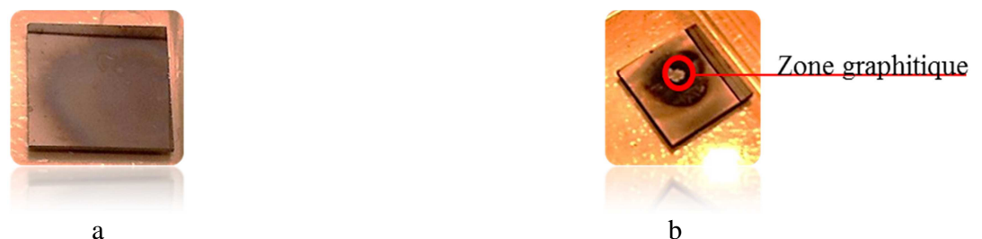
Figure 29 : Photographies d'échantillons de 4H-SiC recuits par le canon à électrons dans le Leybold à 50 mA (a) et 60 mA (b)
