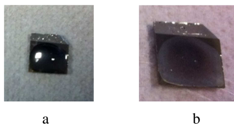
Figure 60 : Échantillon de résine pyrolysée avec une goutte de solution de chitosane déposée en surface avant (a) et après séchage (b)
