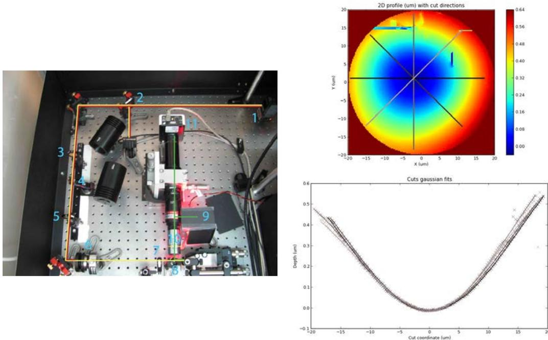
Fig. 4.2 Gauche : Photographie du montage utilisé pour fabriquer les miroirs à faible rayon de courbure. Droite : vue du microscope interférométrique permettant de caractériser géométriquement les concavités créées.
