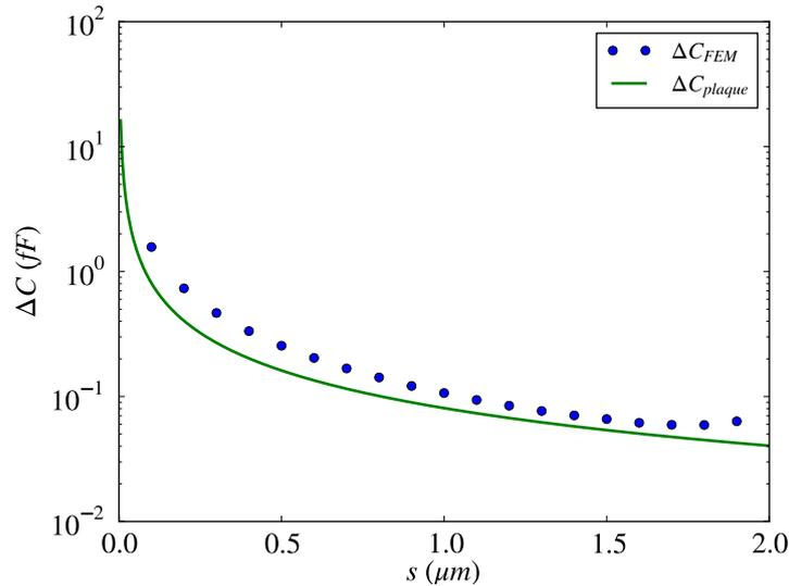
Fig. 5.4 Différence de capacité pour deux épaisseurs d'électrodes simulées (5 et 100 nm) comparé à la différences de capacité due à deux plaques séparées d'une distance  $s$  et respectivement de surface  $10 \times 100$  et  $10 \times 5 \text{ nm}^2$ . Avec dans chaque cas  $a = 2\mu\text{m}$ , et pour un condensateur de surface  $10 \times 20\mu\text{m}^2$ .
