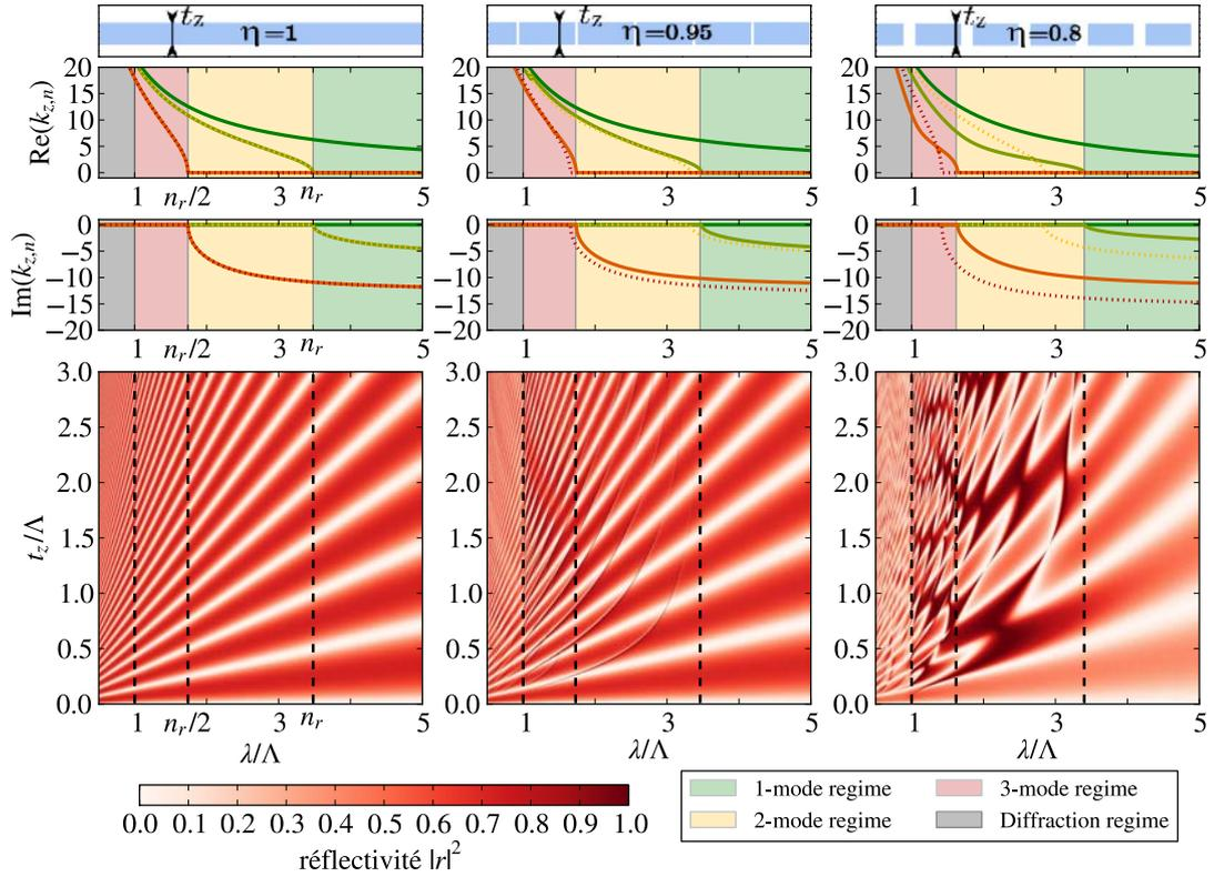
Fig. 2.13 Ligne du bas : cartes de réflectivité en fonction de la longueur d'onde et de l'épaisseur, toutes deux normalisées par la périodicité du cristal, pour une membrane non structurée à gauche, structurée faiblement au centre  $\eta = 0.95$ , et à droite pour une structuration importante  $\eta = 0.8$  (voir ligne du haut). Lignes du milieu : parties réelles et imaginaires des composantes verticales des 5 premiers vecteurs d'onde  $k_{z,n} = \omega\beta_n$ .
