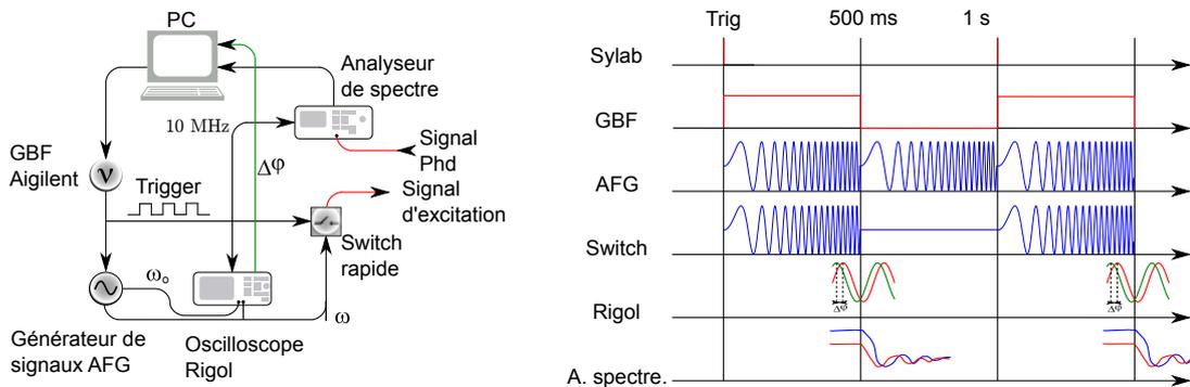
Fig. 3.27 *A gauche : présentation du système d'excitation et d'acquisition pour obtenir l'évolution d'un mode mécanique dans l'espace des phases. A droite : signaux générés par la boucle, servant au trig, à l'excitation, à la synchronisation, et à la mesure.*
