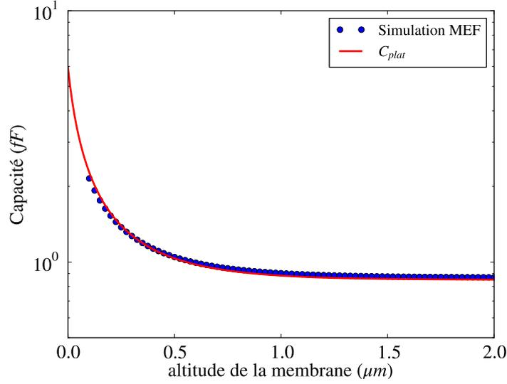
Fig. 5.7 Comparaison des capacités prédites pour une membrane semi infinie entre les approximations et la simulation, pour  $a = 2\mu\text{m}$  et  $\epsilon_r = 13$ , pour des électrodes de surface  $10 \times 20\mu\text{m}^2$ .
