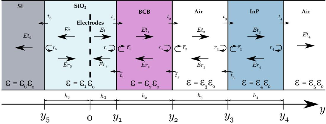
Fig. 5.13 Illustration des différentes couches de diélectrique composant les échantillons fins, avec  $h_6 = 1\mu\text{m}$ ,  $h_1 = 100\text{nm}$ ,  $h_2 = 200\text{nm}$ ,  $h_3 = 200\text{nm}$ ,  $h_4 = 0.26\text{nm}$ ; et  $\epsilon_6 = 11.7$ ,  $\epsilon_1 = 3.9$ ,  $\epsilon_2 = 2.7$ ,  $\epsilon_3 = \epsilon_5 = 1$  et  $\epsilon_4 = 13$ .
