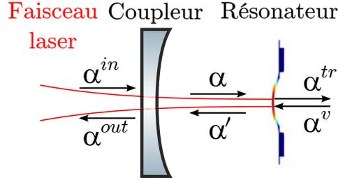
Fig. 4.1 Définition des conventions pour les champs incident, intra-cavité, réfléchi et transmis par la cavité.
