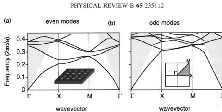
Fig. 2.7 Diagramme de bandes simulé pour un cristal photonique membranaire de maille carrée  $\Lambda$  avec des trous de rayon  $0.2\Lambda$  et une épaisseur de  $0.5\Lambda$  par la méthode RCWA, extrait du travail de S. Fan dans [47].
