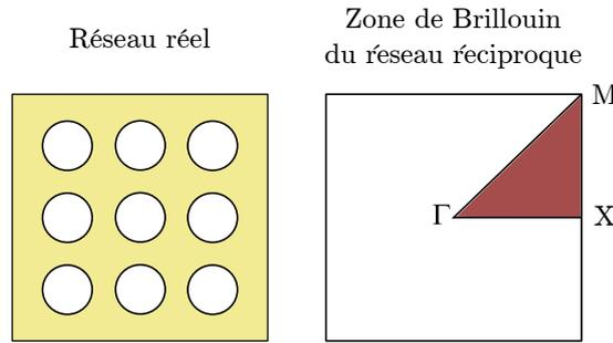
Fig. 2.4 Gauche : représentation d'un cristal photonique à deux dimensions à maille carrée sur quelques périodes. Droite : Zone de Brillouin d'une maille carrée, centrée à l'origine ( $\Gamma$ ). Le triangle marron représente la zone irréductible, avec comme points particuliers le centre, le coin et la face, connus sous les noms de points  $\Gamma$ ,  $M$  et  $X$ .
