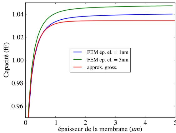
Fig. 5.10 Capacité en fonction de l'épaisseur de la membrane pour  $a = 2\mu m$ ,  $\epsilon_r = 13$  et une altitude de  $0.5\mu m$ .
