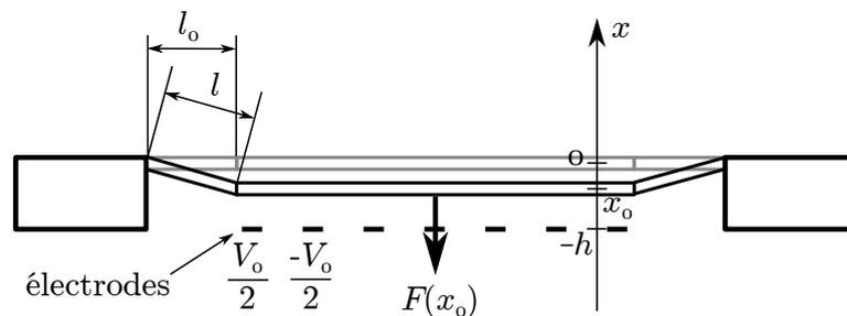
Fig. 5.19 Déplacement statique de la membrane dû au bias.
