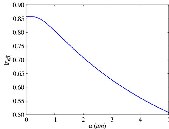
Fig. 5.12 Réflexion en fonction de du paramètre  $\alpha_1$  pour une épaisseur de la membrane de  $0.26\mu m$  et  $\epsilon_r = 13$ .
