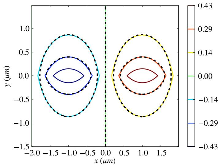
Fig. 5.3 Isopotentiellles simulées (lignes pointillées noires) et celles données par l'équation 5.1.12 (lignes colorées), pour  $-0.43$ ,  $-0.29$ ,  $-0.14$ ,  $0$ ,  $0.14$ ,  $0.29$  et  $0.43$  V.
