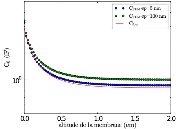
Fig. 5.11 Comparaison des capacité prédites pour une membrane d'épaisseur  $0.26\mu m$  entre les approximations et la simulation, pour  $a = 2\mu m$  et  $\epsilon_r = 13$ .
