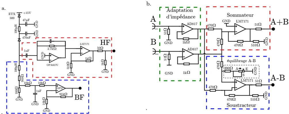
Fig. 4.7 a : Schéma électronique de principe de fonctionnement des photodiodes. b : Schéma électronique de principe de fonctionnement du sommateur-soustracteur.
