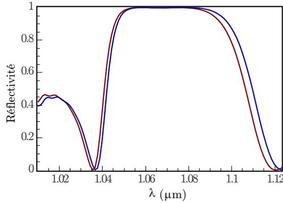
Fig. 2.16 Comparaison de la réflectivité simulée par RCWA (courbe rouge) et FDTD (courbe noire).
