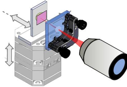
Fig. 4.3 Schéma de montage de la cavité
