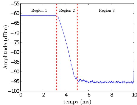
Fig. 3.9 Signal typique de Ring down, obtenu pour le mode de pont symétrique de fréquence 2.4514 MHz d'une membrane avec quatre ponts de  $2 \mu\text{m}$  de long et  $0.5 \mu\text{m}$  de large placés à  $4.25 \mu\text{m}$  de part et d'autre de la médiane de la membrane, ce qui correspond à un facteur de qualité d'environ 3200.
