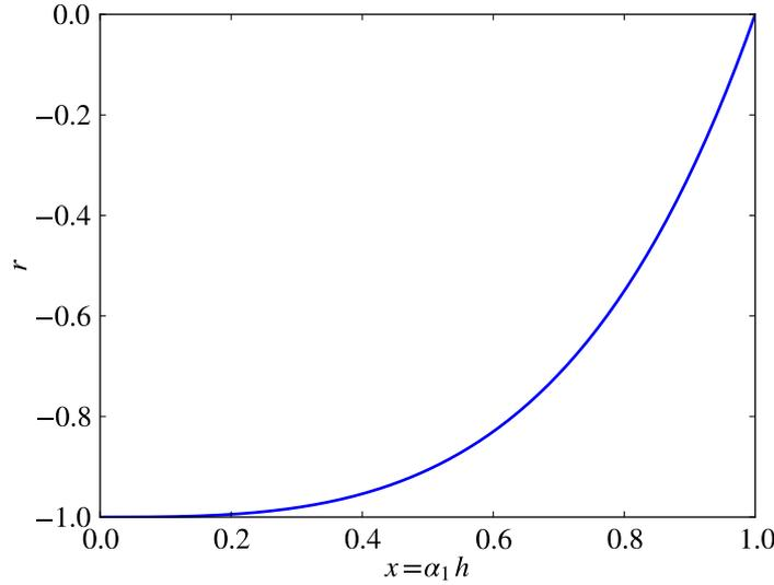
Fig. 5.8 *Produit  $x = \alpha_1 h$  maximisant le couplage à altitude donnée de la membrane ( $h$ ) pour les différentes valeurs de la réflectivité.*
