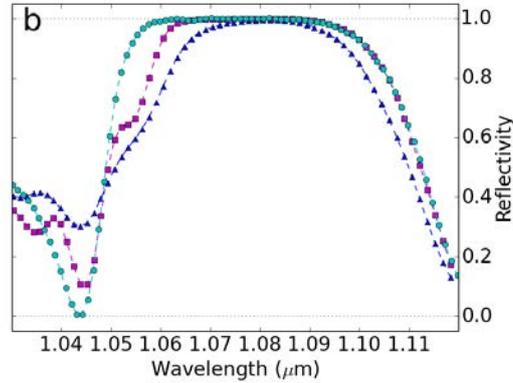
Fig. 2.20 Simulation FDTD, d'un cristal photonique à deux dimensions pour une épaisseur de  $267\ \text{nm}$ , pour trois configurations différentes : le cas d'une onde plane en incidence normale sur le cristal infini (cercle vert), puis un cristal photonique de  $30 \times 30\ \mu\text{m}^2$  éclairé par un faisceau gaussien de waist  $4.2\ \mu\text{m}$  (carré violet) et  $2.1\ \mu\text{m}$  (triangle bleu).
