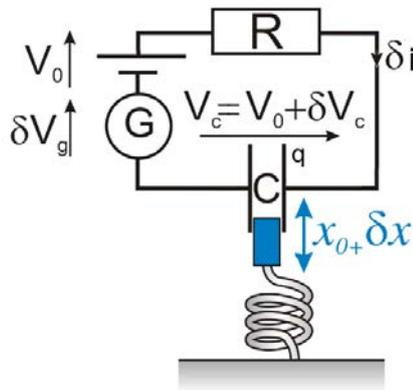
Fig. 5.18 Schéma du système membrane et circuit électrique.
