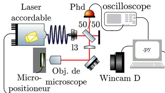
Fig. 2.24 Schéma du montage servant à mesurer les réponses spectrales des membranes à cristal photonique.
