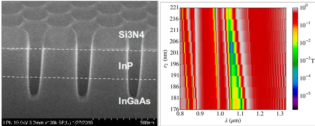
Fig. 2.21 Gauche : Image MEB d'une coupe d'un cristal photonique après la gravure. Droite : simulation de la réflectivité pour des trous coniques avec  $r_1$  fixé à 196 nm et  $r_2$  prenant les valeurs de 176 à 206 nm.
