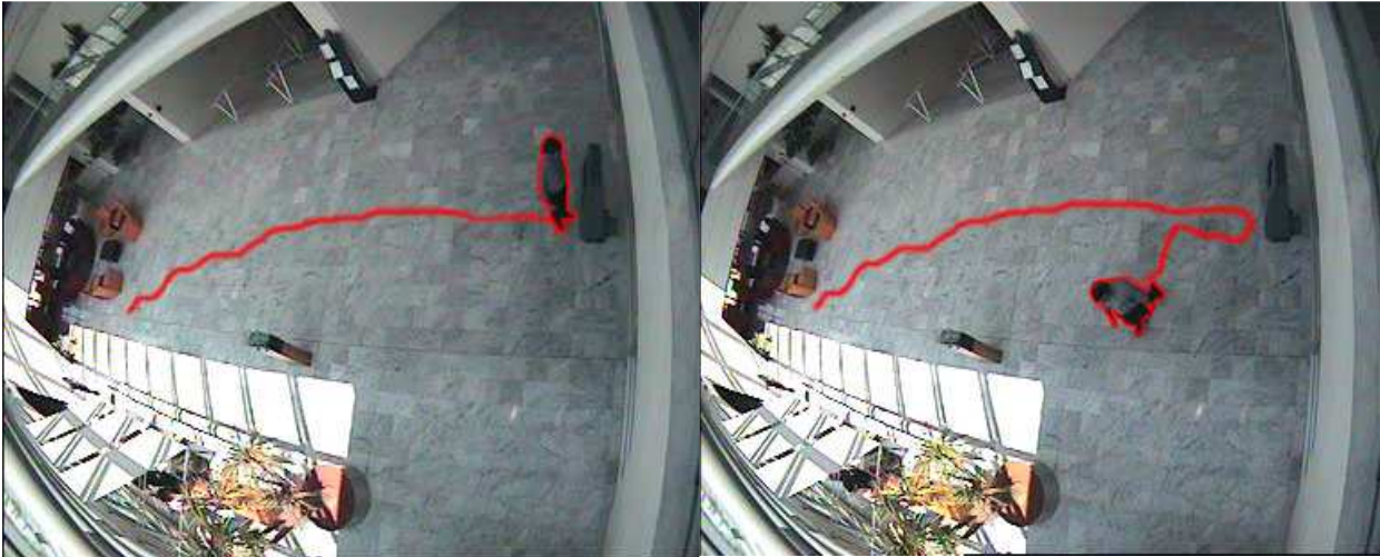
(a) Image d'analyse et reconnaissance de l'événement le piéton quitte la salle d'attente et va au distributeur, puis il passe un temps de 10 à 15 secondes.
